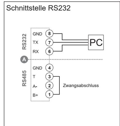
**ANMERKUNG.** RS485: zusätzliche Geräte mit RS485 werden parallel angeschlossen. Der Abschluss der RS485 Verbindung wird nur am letzten Gerät im Netzwerk mittels einer Verbindung zwischen (B) und (T) durchgeführt. **A**: die Kommunikationsports RS232 und RS485 können nicht gleichzeitig verbunden und verwendet werden.
