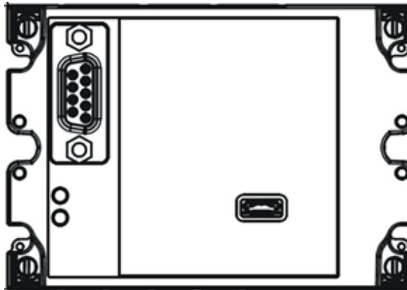
Verbindung mit dem Profibus-Modul durch USB Micro Typ B (Modbus RTU) und RS485 DB9 (Profibus DP-V0).
