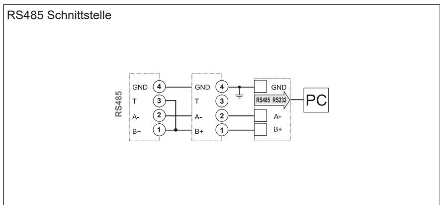
**ANMERKUNG.** RS485: zusätzliche Geräte mit RS485 werden parallel angeschlossen. Der Abschluss der RS485 Verbindung wird nur am letzten Gerät im Netzwerk mittels einer Verbindung zwischen (B) und (T) durchgeführt.
