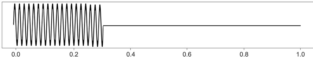
Ausgang bei Pulspaketsteuerung mit einem Steuerwert von 50%:
