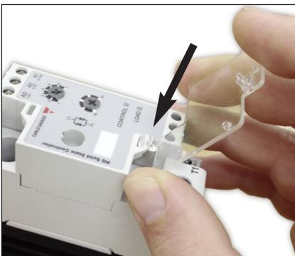
1: Die transparenten Abdeckung auf die untere Öse des RGx1P Steuermodul einrasten
