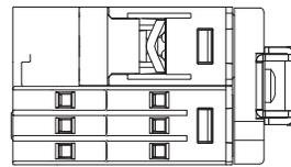
Die angegebene Einbautiefe des RGx1P muss um 3 mm erhöht werden, wenn die manipulationssichere Abdeckung Zubehör auf dem Gerät angebracht ist.
