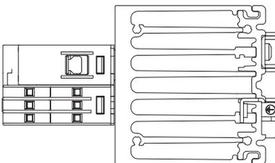
Toleranz der Gehäusebreite +0,5 mm, -0 mm... gemäß DIN43880.
