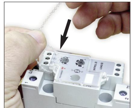
3: Abdeckung bei Bedarf mit dem Kabelbinder gegen unbefugtes Öffnen sichern
