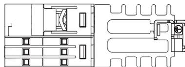
Die angegebene Einbautiefe des RGx1P muss um 3 mm erhöht werden, wenn die manipulationssichere Abdeckung Zubehör auf dem Gerät angebracht ist.
