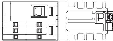
Toleranz der Gehäusebreite +0,5 mm, -0 mm... gemäß DIN43880.
