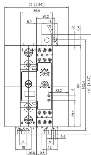
Die angegebene Einbautiefe des RGx1P muss um 3 mm erhöht werden, wenn die manipulationssichere Abdeckung Zubehör auf dem Gerät angebracht ist.
