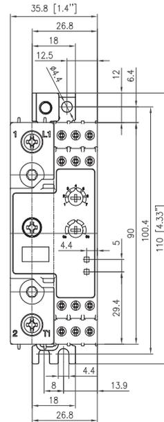
Die angegebene Einbautiefe des RGx1P muss um 3 mm erhöht werden, wenn die manipulationssichere Abdeckung Zubehör auf dem Gerät angebracht ist.
