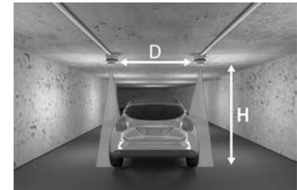
Max. distance between sensors / Distance maximale entre les capteurs / Distancia máx. entre sensores / Distanza massima tra i sensori / Max. Abstand zwischen Sensoren
