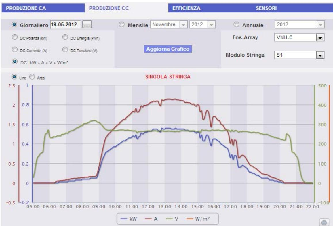
Fig. 125 – Grafico Potenza+Corrente+Tensione+Radiazione Solare VMU-S
