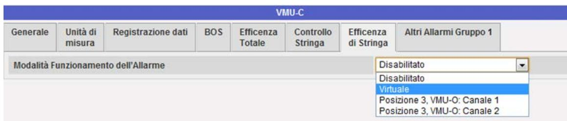
Fig. 74 – Maschera Configurazione Allarme Efficienza di Stringa
