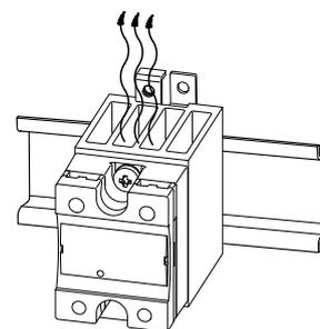
**Fig. 13** Montare con le alettature in posizione verticale in modo da garantire un flusso di aria ottimale attraverso il dissipatore di calore.
