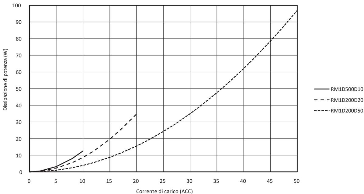
Fig. 8 Grafico di dissipazione della potenza di uscita
