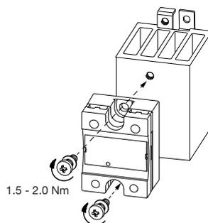
**Fig. 12** Avvitare, alternativamente, le viti con una coppia di 0.5 Nm e quindi proseguire con coppia massima di 2.0 Nm.
