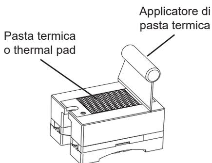
**Fig. 11** Uno strato sottile di pasta siliconica termicamente conduttiva deve essere uniformemente distribuito alla base dell'SSR prima del montaggio su un dissipatore di calore. In alternativa, è possibile utilizzare un pad termico. Il materiale dell'interfaccia termica influisce sulle prestazioni termiche. Assicurarsi che il dissipatore di calore sia dimensionato correttamente.
