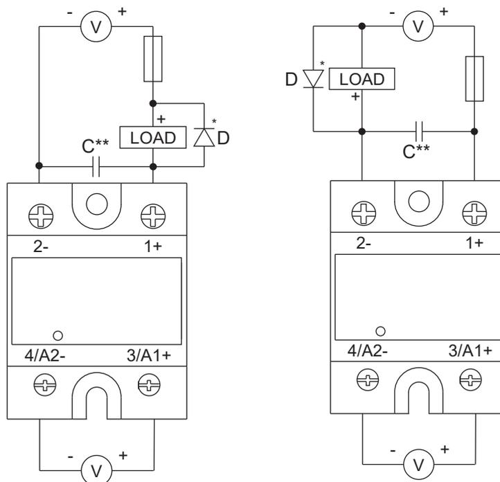
Fig. 9 Schemi di collegamento RM1D
