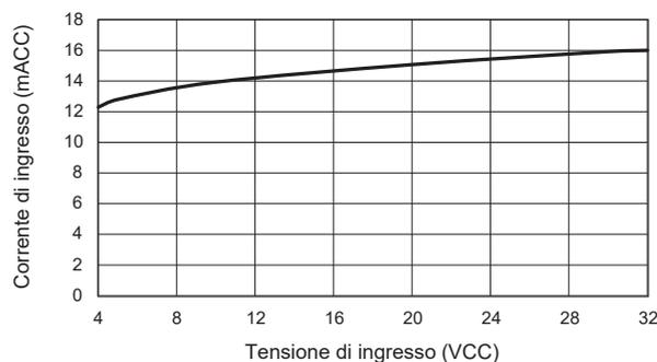
Fig. 3 Corrente di ingresso vs. tensione di ingresso
