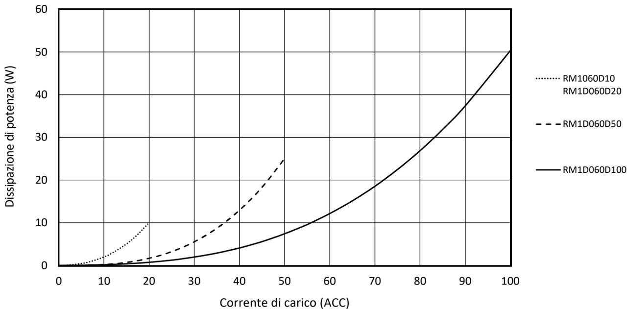
Fig. 7 Grafico di dissipazione della potenza di uscita
