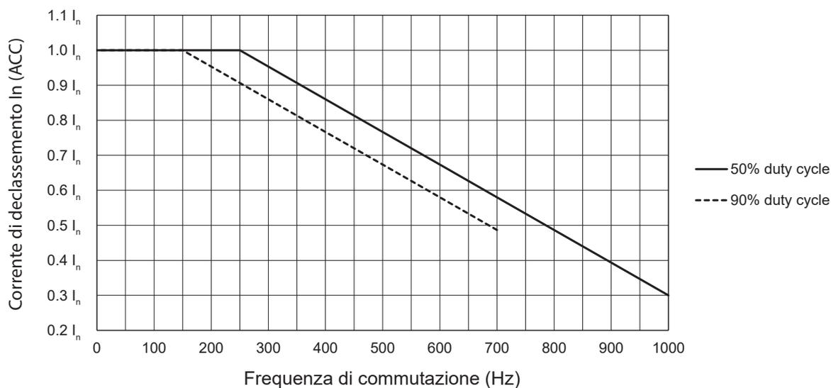
**Fig. 6** Corrente di declassamento vs. frequenza di commutazione<sup>4</sup>
