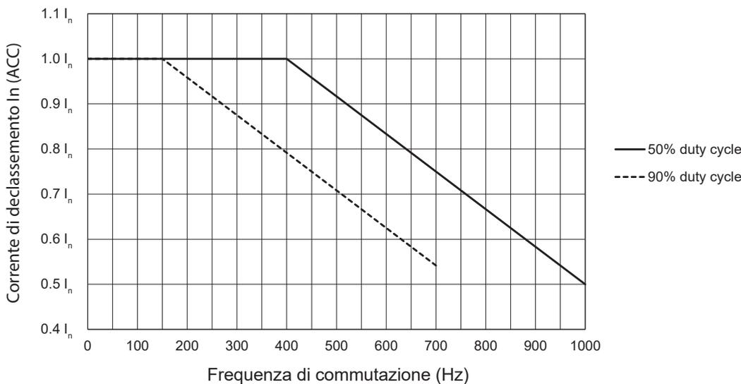
Fig. 5 Corrente di declassamento vs. frequenza di commutazione<sup>4</sup>
