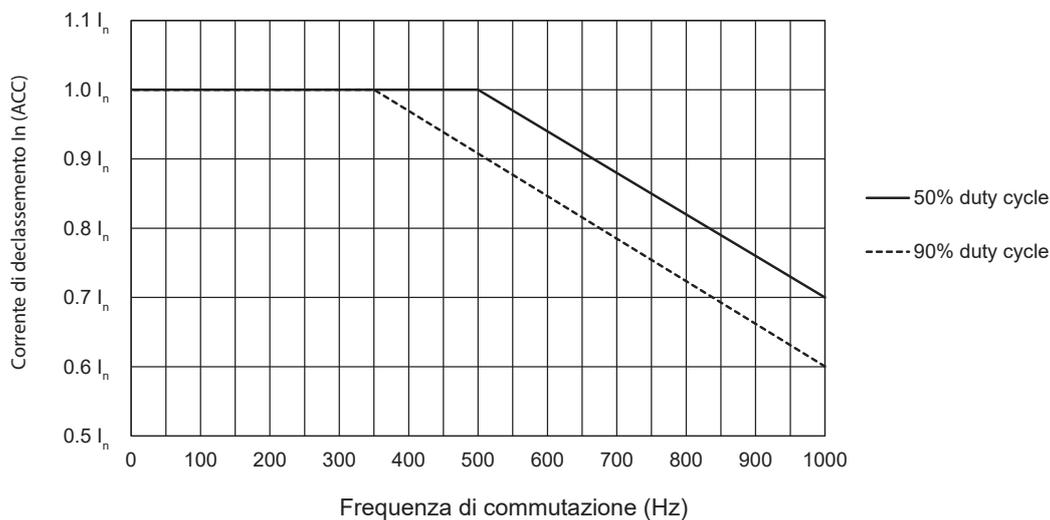
Fig. 4 Corrente di declassamento vs. frequenza di commutazione
