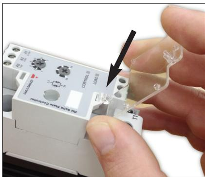
1. Agganciare la copertura trasparente nell'apertura inferiore del modulo di controllo del RGx1P
