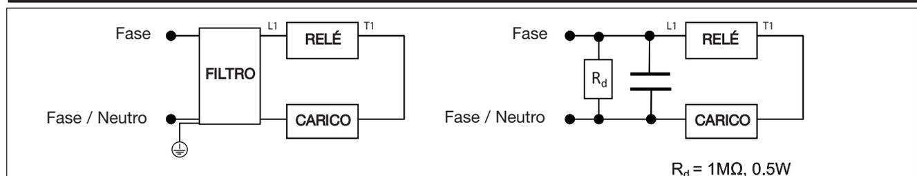
Nota: Il sistema di filtraggio suggerito è stato determinato con condizioni di carico e di programmazione che devono essere considerate a puro titolo di esempio. L'RGC1P è da intendersi come parte integrante di un sistema, dove le condizioni di utilizzo quali: carico, lunghezza cavo e altri componenti ausiliari, possono essere differenti da quanto utilizzato nei nostri test. Sarà responsabilità del system integrator assicurarsi che tutti i componenti siano conformi con le normative in vigore.
