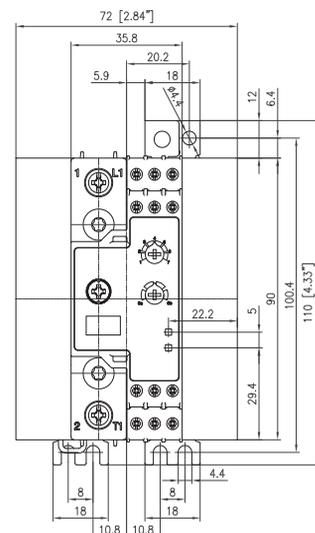
La dimensione della profondità del RGx1P indicata deve essere aumentata di 3 mm, quando la copertura antimanomissione opzionale è montata sul dispositivo.
