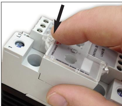
2. Chiudere la copertura agganciandola all'apertura superiore del modulo di controllo del RGx1P
