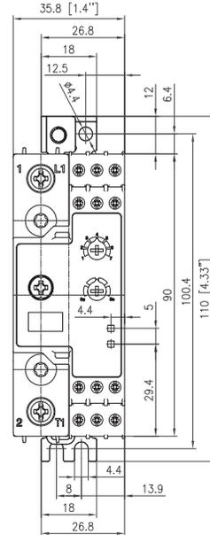
La dimensione della profondità del RGx1P indicata deve essere aumentata di 3 mm, quando la copertura antimanomissione opzionale è montata sul dispositivo.
