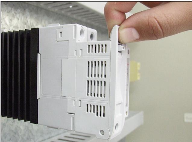
1. Apertura alloggiamento del fusibile.
