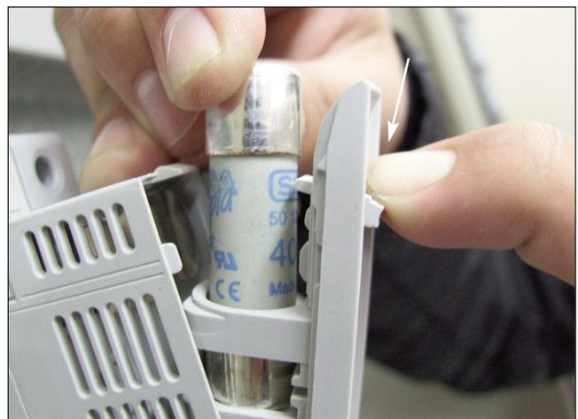
4. Premere in basso il fusibile e chiudere l'alloggiamento.
