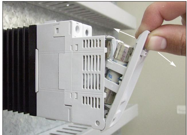
2. Apertura e chiusura alloggiamento del fusibile.
