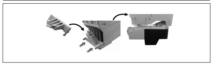
Adattore relè per il sovraccarico del motore.\*
