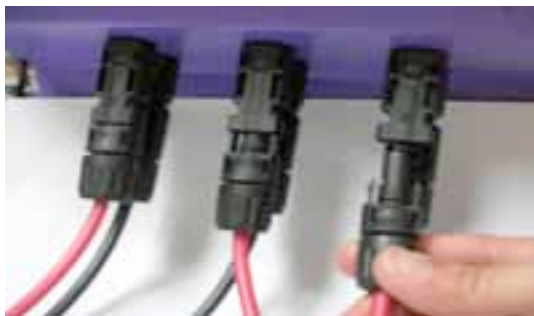
Fig 3.3.2.3 Collegamento di terminale FV +
