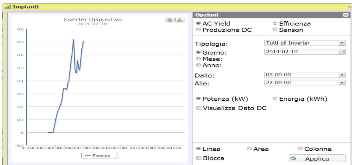
Figure 19: Finestra Impianto; Grafico Inverter – Selezione Opzioni.
