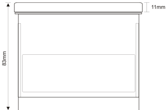
Figura 1-5 Dimensioni in profondità
