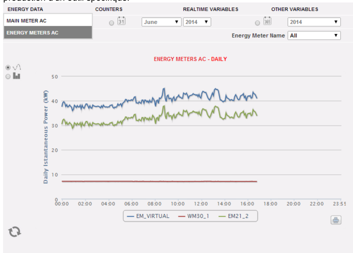
Graphique COMPTEURS D'ÉNERGIE – COMPTEURS PARTIELS
