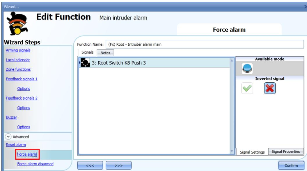
L'alarme peut être forcée dans une seule zone seulement en ajoutant le signal *Force alarm* (Forcer alarme) à une fonction donnée d'une zone (voir ci-dessous).
