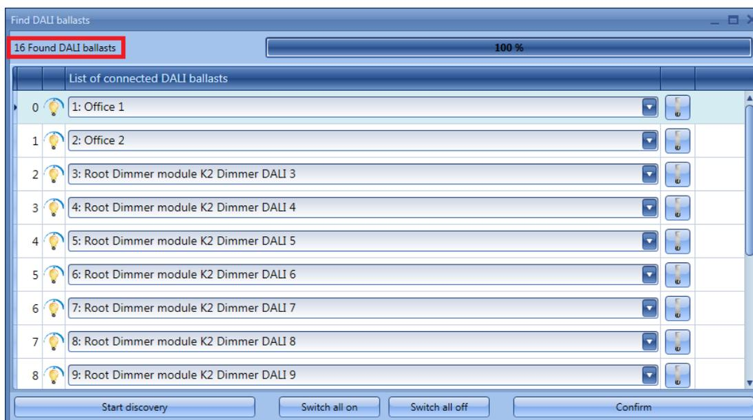
Dans l'exemple qui suit, la découverte réseau a détecté un nouveau ballast et l'a ajouté au réseau en adresse 16.
