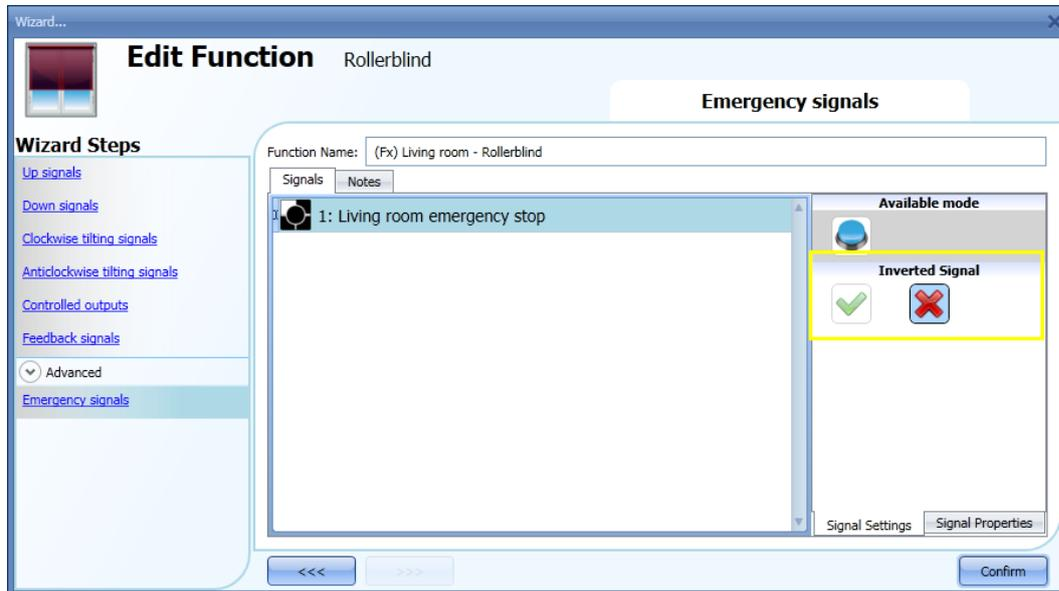
Dans l'exemple suivant, le moteur s'arrête instantanément sur activation du signal d'urgence.
