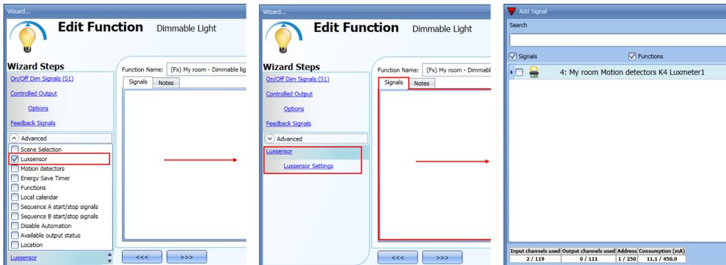
On peut ajouter jusqu'à 10 luxmètres : si la fonction est pilotée par plusieurs luxmètres, le système calcule la valeur moyenne en lux et l'utilise.
