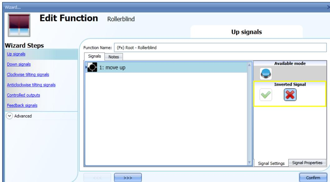
Tous les signaux sélectionnés dans la fenêtre *Up* (Montée) fonctionnent en parallèle (gérés par une logique OU). Les actions du système varient en fonction de la durée de sollicitation du bouton-poussoir.
