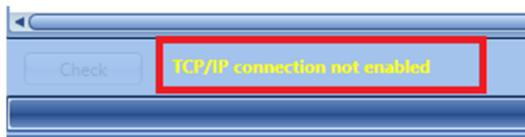
Dans le contrôleur esclave, activer impérativement le protocole *Modbus TCP/IP Slave* s'il ne l'est pas, sous peine d'un avertissement qui s'affiche alors dans la fenêtre *Discovery manager* (Gestionnaire de découverte) comme illustré à gauche dans l'exemple ci-dessus.
