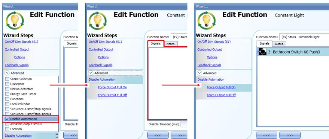
Chaque signal utilisé dans la fenêtre *Force output fully off* (Sortie forcée à arrêt éclairage) fonctionne en signal de niveau.
