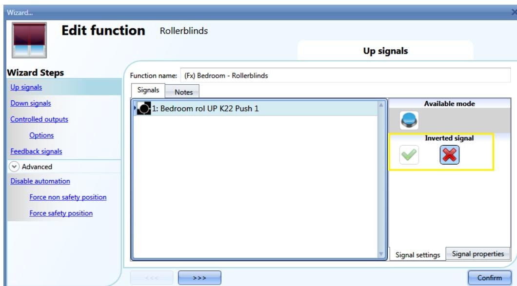
Tous les signaux sélectionnés dans la fenêtre Montée/Descente fonctionnent en parallèle (niveau logique OU). Selon le temps de réponse au déclenchement du signal, la sortie peut présenter deux comportements :
