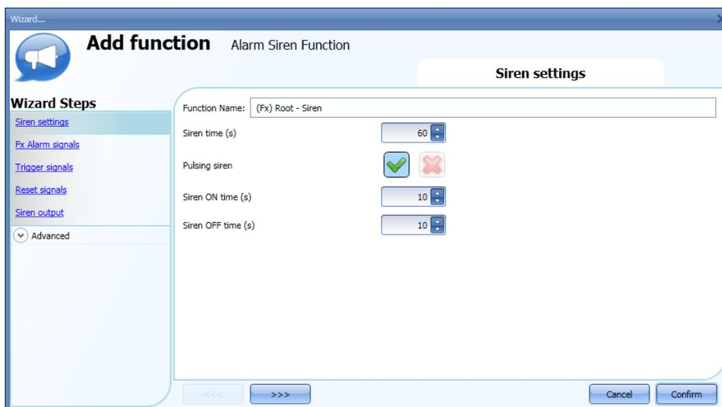
Le champ *Siren time* (Temps sirène) permet de régler le temps d'activation de la sortie de la sirène lorsqu'une fonction d'alarme la déclenche.
