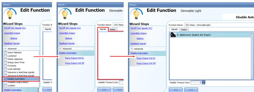
Une fois le signal ajouté, sélectionner le mode de fonctionnement et le type d'événement à asservir au signal :
