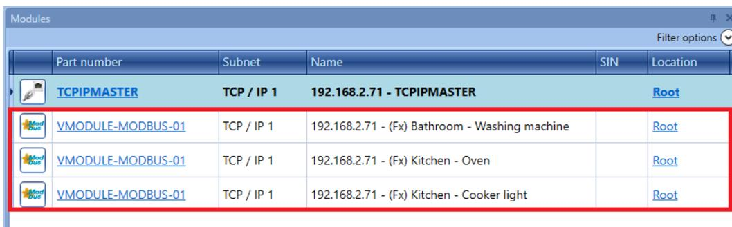
Tous les modules/fonctions sont traitées à l'identique des modules/fonctions connectées au périphérique maître et sont exploitables dans n'importe quelle logique.
