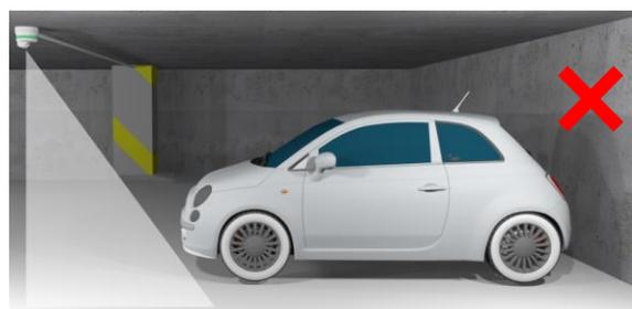
Le dispositif de butée ou cale roues évite de stationner trop loin du capteur
