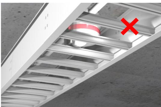
Le capteur est placé à l'extérieur de l'obstacle à l'aide du SBPBASEA et d'un support type « colonne »
