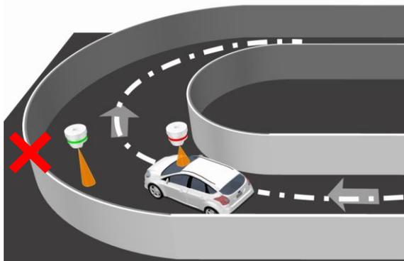
Les capteurs sont placés au milieu de la voie de circulation où passe le véhicule
