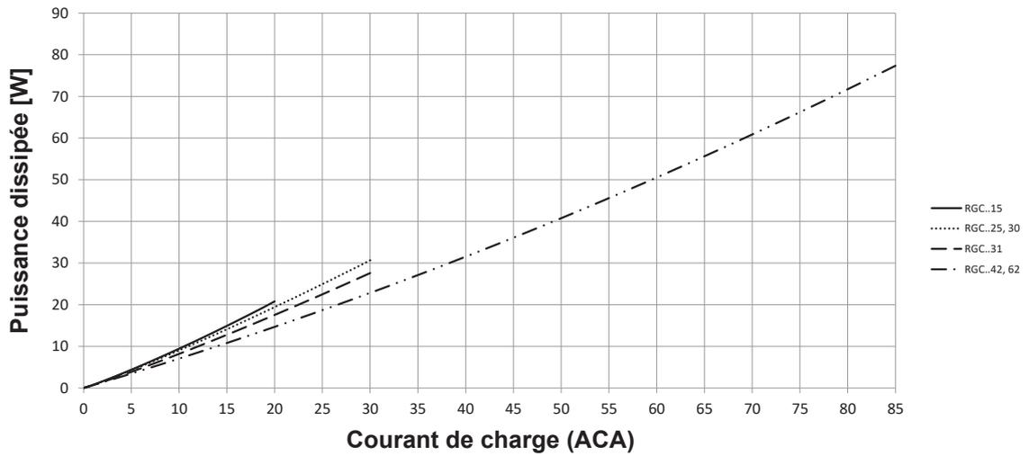
**RGS.. Sélection dissipateur thermique**
