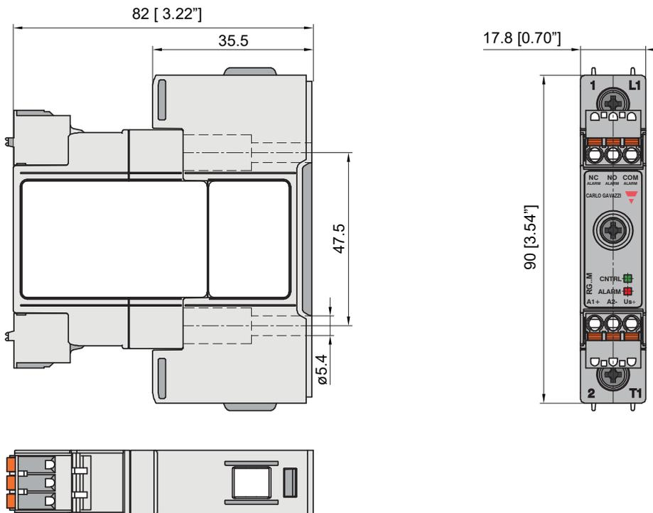
Boîtier avec tolérance +0,5mm, -0mm conformément à DIN 43880.
