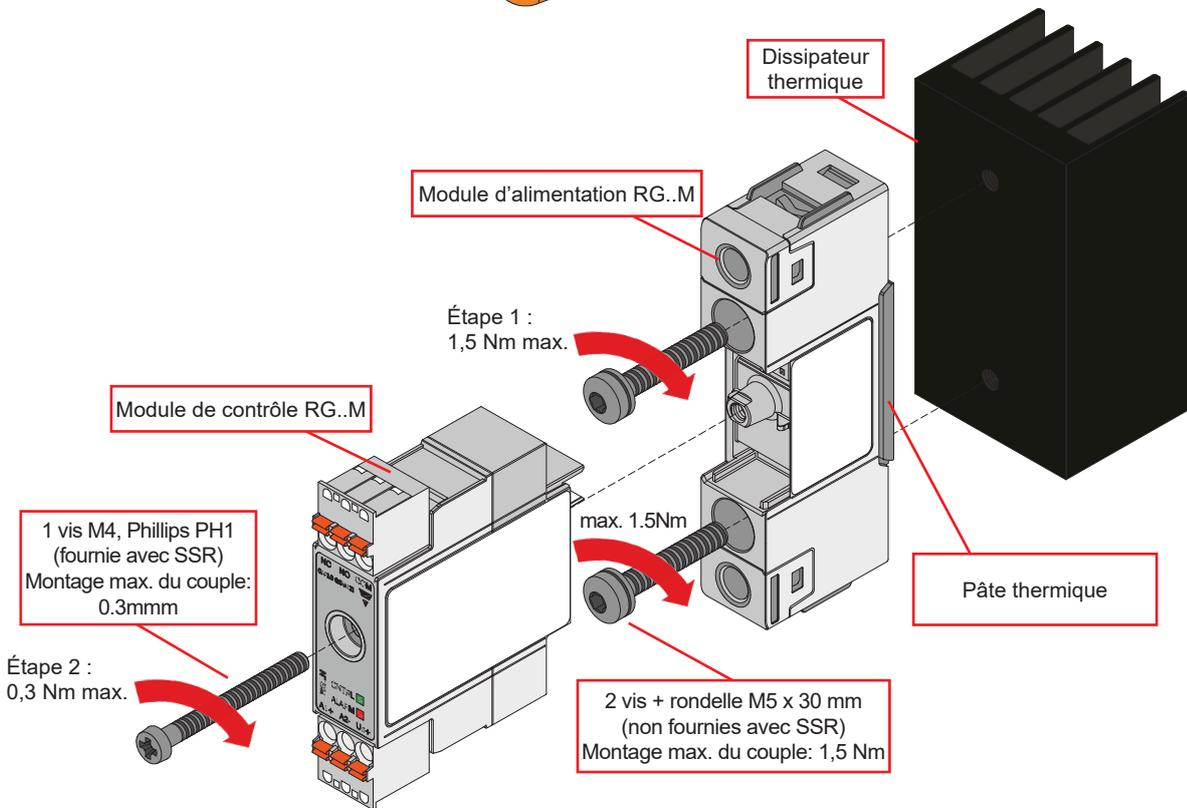
Étape 1: Monter le module d'alimentation RG..N sur le dissipateur thermique
