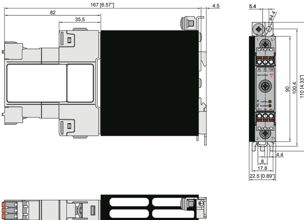
Boîtier avec tolérance +0,5mm, -0mm conformément à DIN 43880.
