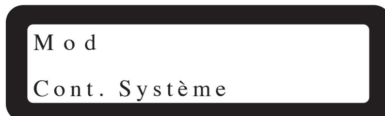
Pendant le contrôle du système, si le réseau n'est pas branché à l'onduleur, apparaîtra alors sur l'afficheur LCD le message suivant et le système s'arrêtera à cette phase.
