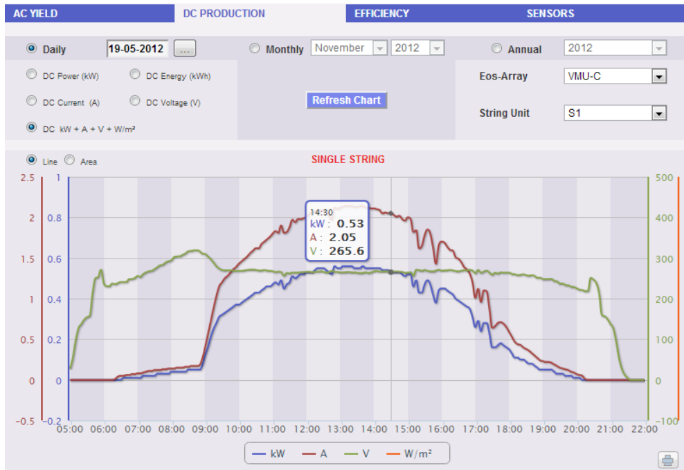
Fig. 125 – Graphique VMU-S Puissance+Courant+Tension+Irradiation solaire
