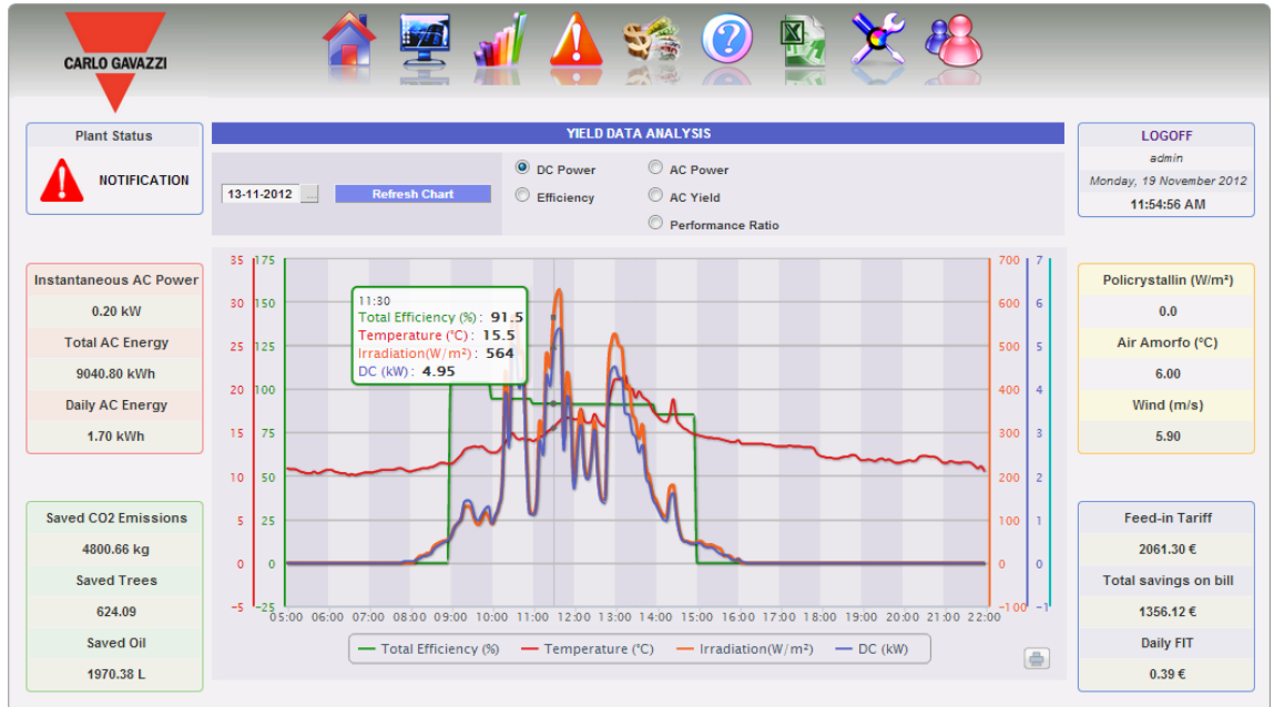
Fig. 101 - Análisis de los datos de producción en diagrama CD
