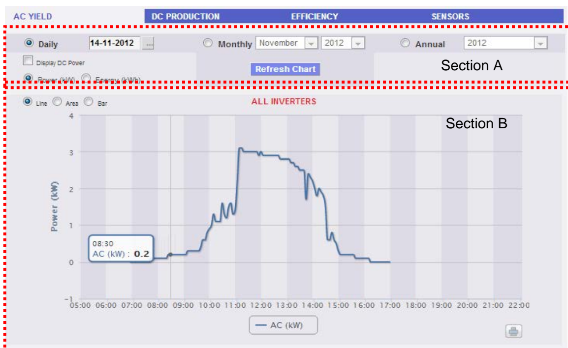
Fig. 112 - Diagrama de PRODUCCIÓN CA - TODOS LOS INVERSORES
