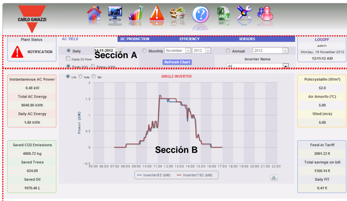
Fig. 115 - Diagrama de PRODUCCIÓN CA - INVERSORES ÚNICOS
