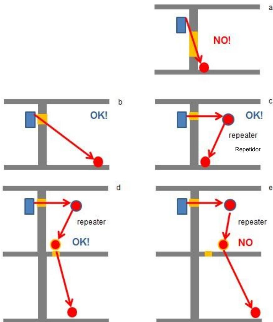
También se recomienda colocar un receptor con una antena interna en la pared opuesta en la pared adyacente desde la ubicación del transmisor; esto se debe a que, cerca de un muro, es posible que las ondas de radio estén expuestas a dispersiones y reflejos, y también a que las dos antenas deben verse la una a la otra para disponer de línea de visión y del mejor enlace de radio posible.
