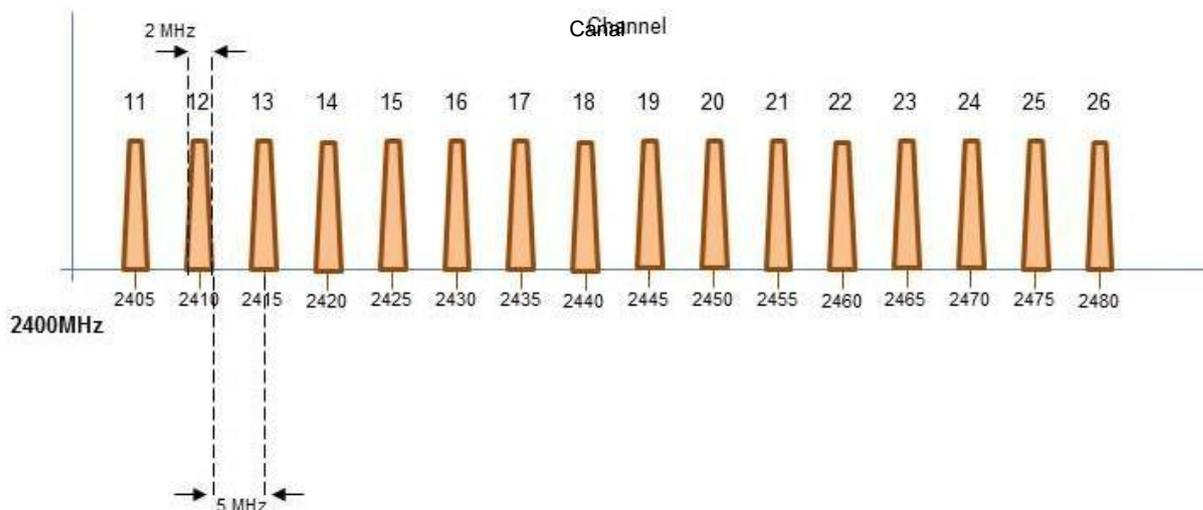
WiDup utiliza el canal 15 para explorar la red inalámbrica con el fin de buscar los módulos esclavos y es fijo, mientras que los canales de funcionamiento pueden ajustarse de 11 a 26 de acuerdo con la presencia de otros sistemas que funcionen a 2,4 GHz. Esta selección debe realizarse utilizando el UWP 3.0 Tool.
