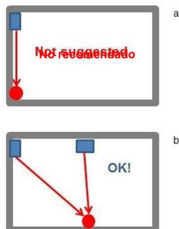
En las instalaciones multi planta, se aconseja instalar una unidad básica inalámbrica SH2WBU230N en cada planta con el fin de disponer de la mejor cobertura de radio y para evitar la atenuación de la señal debido a techos o suelos de hormigón muy reforzado.
