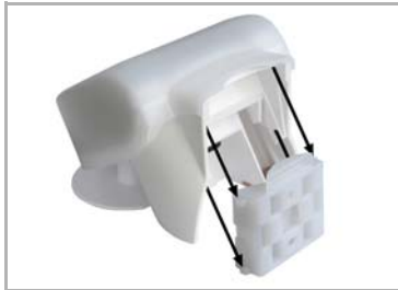
Fig. 12 Pousser le boîtier du haut dans le support monté. Les tenons du support doivent s'insérer dans les rails du boîtier.
