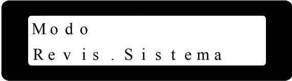
Durante el control del sistema, si la red no está conectada al convertidor, entonces aparecerá en LCD el siguiente mensaje y el sistema se detendrá en esta fase.
