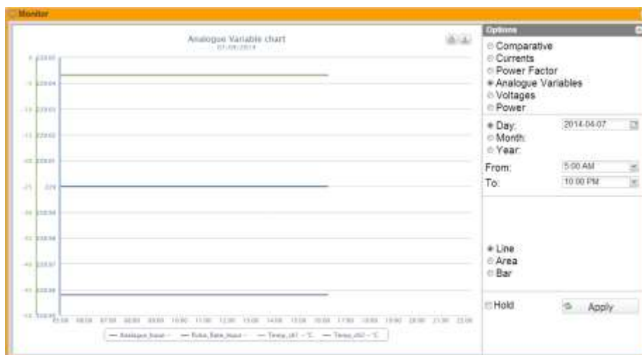
Figur 9: VMU-Y EM analog variabel diagram med indstillingsmenu.
