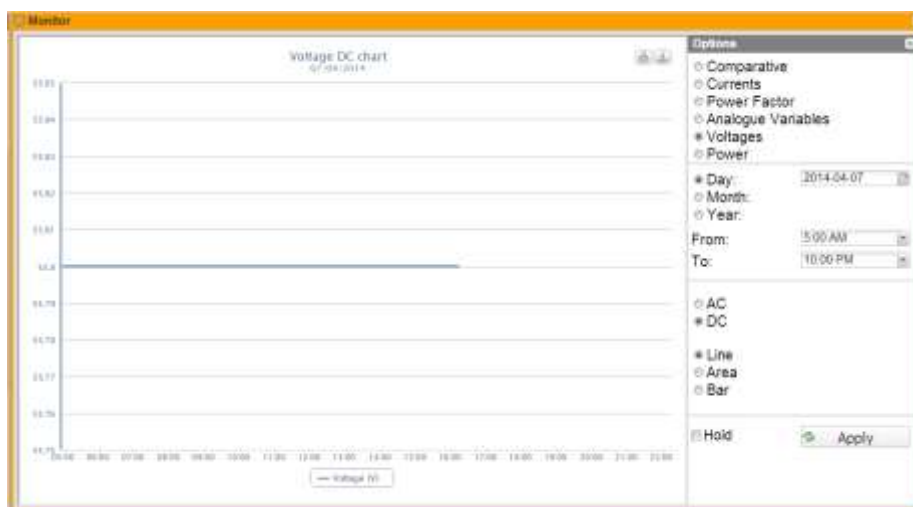
Figur 10: VMU-Y EM spændingsdiagram med indstillingsmenu.
