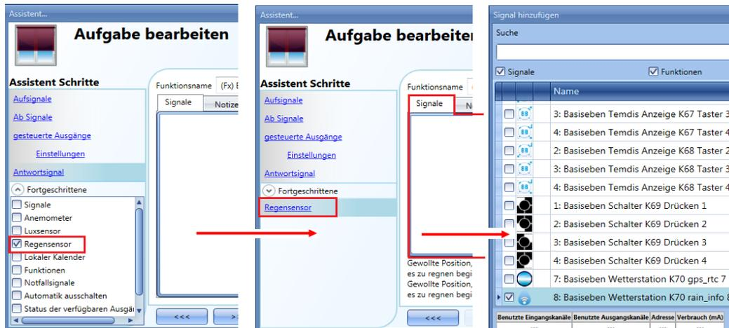
Beim Eingangssignal kann es sich um einen Regensensor oder um einen gewöhnlichen Taster/Schalter handeln. Sie können bis zu 50 Signale hinzufügen. Wählen Sie anschließend die Aktion für den Fall aus, dass einer der Sensoren Wasser erkennt.
