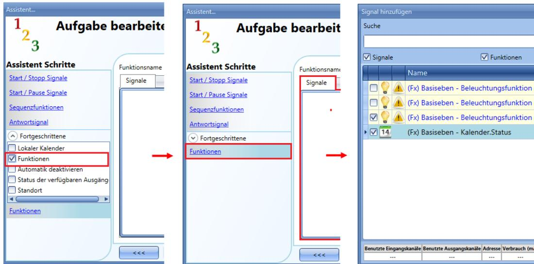
Die Sequenz wird dann gemäß dem Status der hinzugefügten Funktionen aktiviert und deaktiviert. Wenn Sie z. B. eine Beleuchtungsfunktion hinzufügen, würde das Einschalten des Lichts die Sequenz starten und das Ausschalten des Lichts die Sequenz stoppen.
