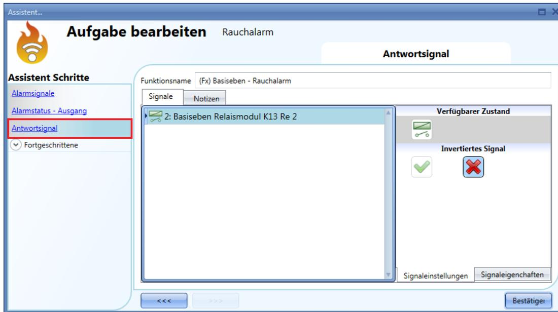
Beispiel 1: Aus den obigen Einstellungen ergibt sich folgendes Verhalten: Die Rauchalarmfunktion ist bereit, sobald das smart-house-System gestartet wird. Wenn kein Rauch erkannt wird, ist der Ausgang inaktiv. Sobald Rauch erkannt wird (Eingangssignal EIN), wird das Ausgangssignal ohne Verzögerung aktiviert und bleibt aktiviert, bis kein Rauch mehr vorhanden ist.
