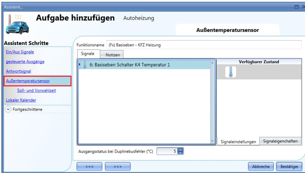
Im Feld „Output status if Dupline bus is faulty“ können Sie einen Wert zwischen -50°C und +50°C festlegen, der verwendet wird, wenn kein Temperatursignal verfügbar ist.
