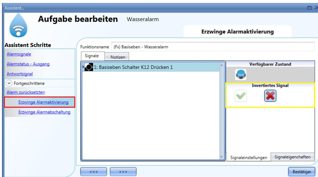
Alle Signale im Fenster „Erzwing Alarmaktivierung“ fungieren als Pegelsignale: Solange das Signal aktiv ist, befindet sich die Funktion zwangsweise im EIN-Zustand (Ausgang aktiv). Wenn sowohl das „Erzwing Alarmaktivierung“-Signal als auch das „Erzwing Alarmabschaltung“-Signal aktiv sind, hat das „Erzwing Alarmaktivierung“-Signal Vorrang.
