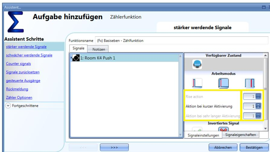
Wenn ein Pegelsignal wie ein Schalter oder eine Funktion ausgewählt wird, stehen als Aktionen die ansteigende Flanke (d. h., wenn der Schalter geschlossen oder die Funktion aktiviert wird), die fallende
