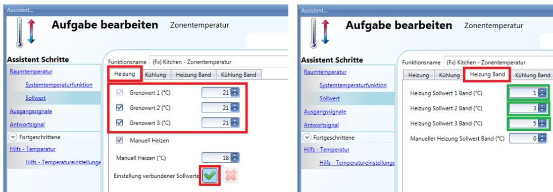
Bei diesen Einstellungen wird ein Regelwert von 20 °C (d. h., 21–1) verwendet, wenn der Sollwert 1 ausgewählt wird. Bei Auswahl von Sollwert 2 liegt der Regelwert bei 18 °C (d. h., 21–3), und bei Auswahl von Sollwert 3 beträgt der Regelwert 16 °C (d. h., 21–5). Auf dem TEMDIS und auf dem Webserver liegen alle drei Sollwerte bei 21 °C, und bei Änderung eines der drei Werte werden auch die beiden anderen geändert.
