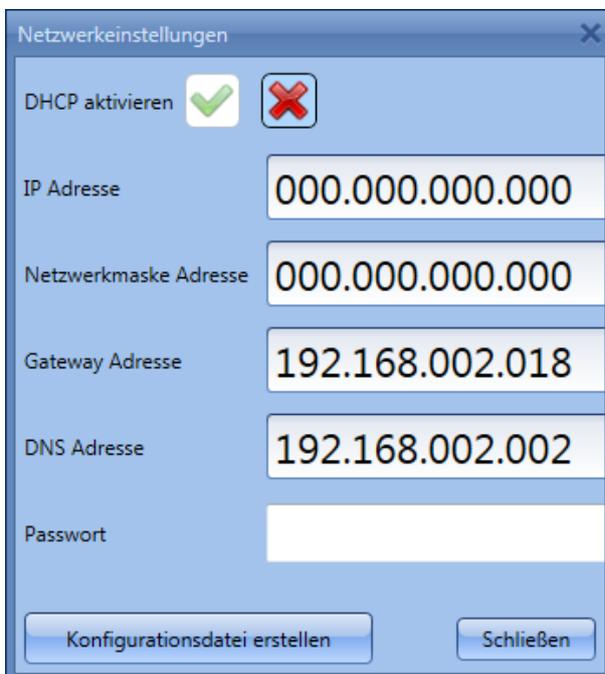
Nachdem Sie die gewünschten Einstellungen vorgenommen haben, klicken Sie auf „Create Configuration File“. Das Sx-Tool erstellt die Dateien „controller\_settings.shcfg“ für das SH-Tool und „controller\_settings.sbcfg“ für das SB-Tool, die Sie auf einen USB-Stick oder eine microSD-Karte kopieren müssen.
