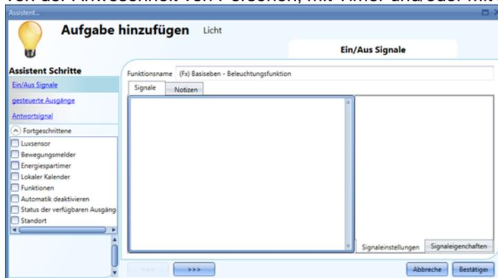
**10.3.1 Beleuchtung mit Eingangsbefehlen ein- oder ausschalten** Zuerst müssen Sie im Bereich „Ein / Aus Signale“ die Eingangssignale hinzufügen, die die Beleuchtung steuern sollen. Führen Sie im Fenster „Signale“ einen Doppelklick aus, um ein Dialogfeld mit allen verfügbaren Signalen anzuzeigen.
