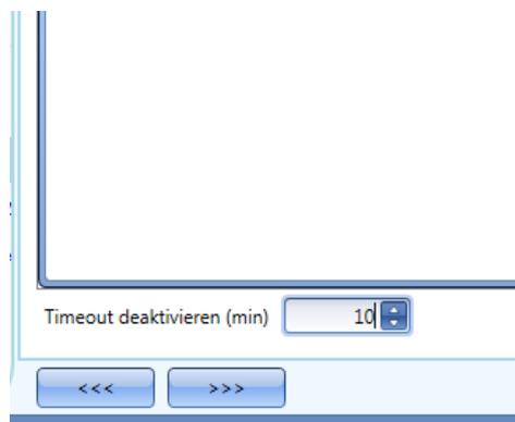
In der Abbildung oben wurde ein „Timeout deaktivieren (min)“ von 10 Minuten gewählt. Maximal lassen sich 59 Minuten einstellen.
