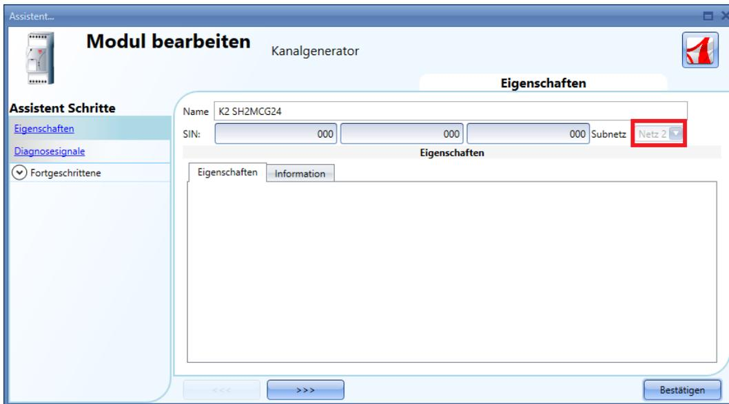
Wie in der Abbildung dargestellt, wird jeder neue Generator dem nächsten freien Netzwerk zu geordnet (z. B. „Net 2“).
