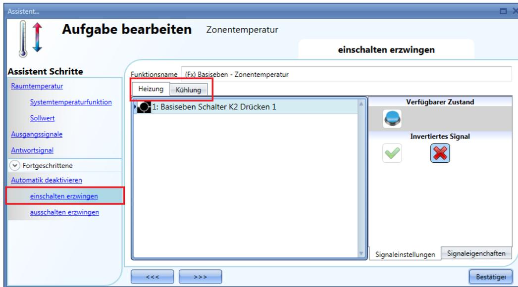
Alle Signale im Fenster „Force output on“ fungieren als Pegelsignale: Solange das Signal aktiv ist, ist der Heizungs- bzw. Kühlungsausgang eingeschaltet. Wenn sowohl das „Force output on“-Signal als auch das „Force output off“-Signal aktiv sind, hat das „Force output on“-Signal Vorrang.
