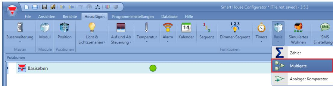
Eine Multigate-Funktion kann verschiedene Aufgaben übernehmen. Z. B. können Sie damit mehrere Überwachungssignale (Türkontakte oder Fensterschalter) in einer Alarmfunktion erfassen oder mehrere Signale und/oder Funktionen überwachen, um einen schnellen Überblick über den Status zu gewinnen. Sie können Multigate-Funktionen auch miteinander verknüpfen und auf diese Weise komplexe logische Funktionen erstellen.
