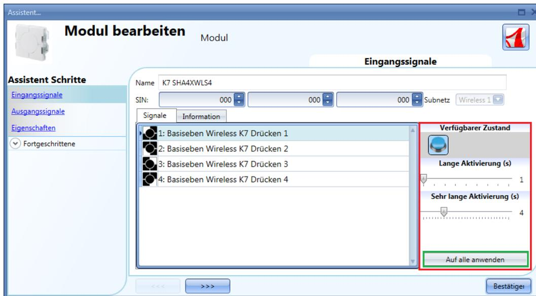
Im Fenster „Eingangssignale“ müssen die Zeiten für die lange Betätigung („Lange Aktivierung“) und die sehr lange Betätigung („Sehr lange Aktivierung“) definiert werden.
