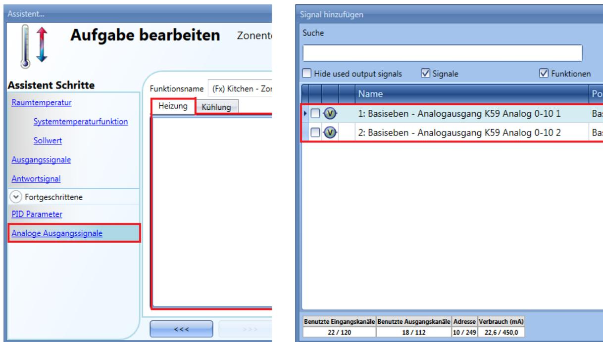
Bei den Ausgangstypen, die in diesem Feld zur Verfügung stehen, handelt es sich um die Ausgangstypen des Moduls SHPOUTV224 (zur Steuerung von Aktoren mit einem Eingang 0...10 V).
