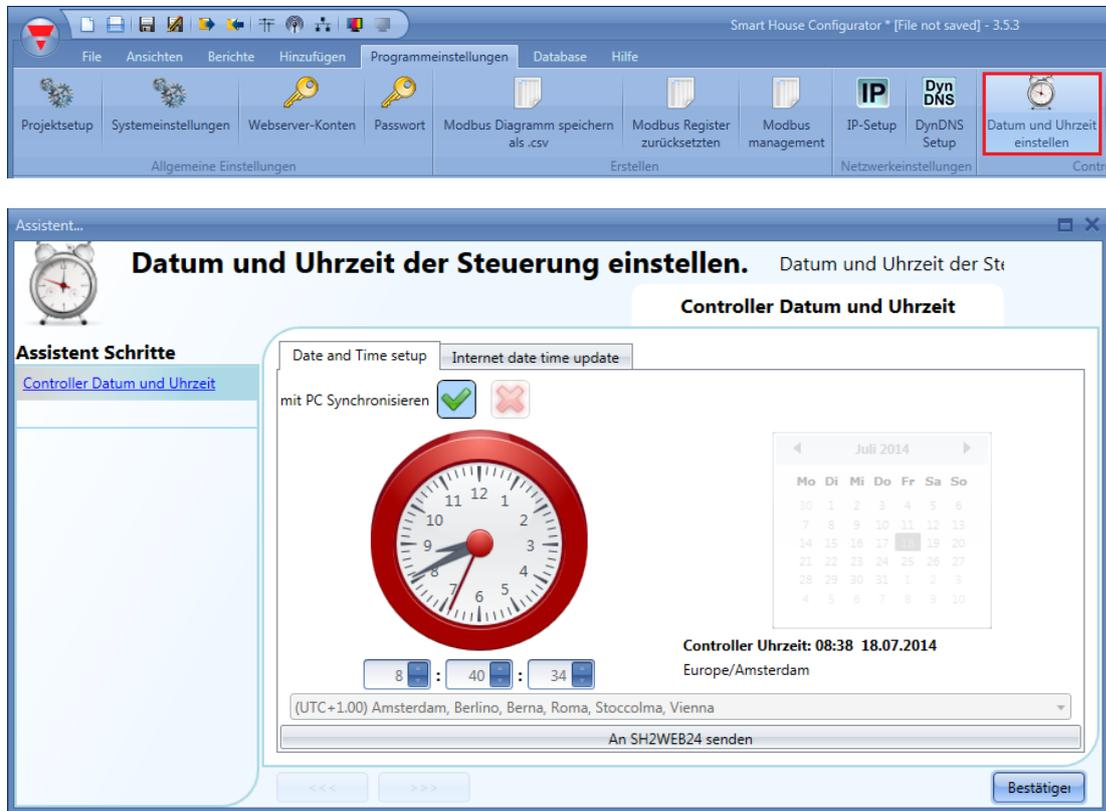
Wenn Sie die Option „Synchronise with PC“ aktivieren und anschließend auf „Send to Sx2WEB24“ klicken, synchronisiert das Tool die Uhr des Sx2WEB24 mit Ihrer PC-Uhr. Wenn die PC-Uhr nicht auf die richtige Zeit eingestellt ist, wird eine falsche Zeit an den Controller übertragen. Datum und Uhrzeit des Sx2WEB24 werden am unteren Rand des Sx-Tools angezeigt (siehe Abbildung unten).
