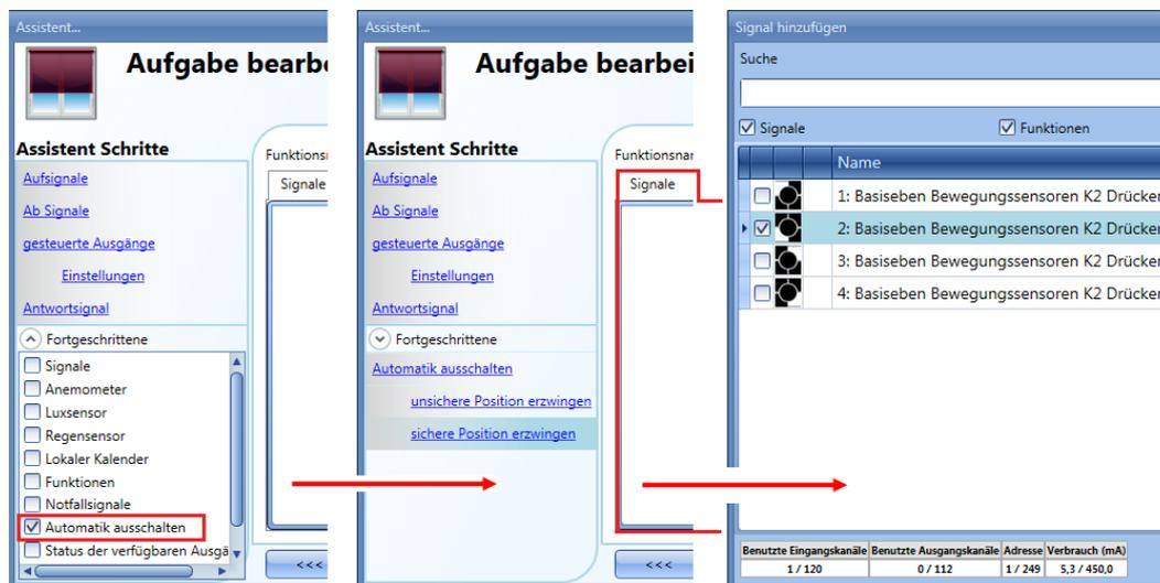
Alle Signale im Fenster „sichere Position erzwingen“ fungieren als Pegelsignale: Solange das Signal aktiv ist, befindet sich der Rollladen zwangsweise in der Sicherheitsposition.
