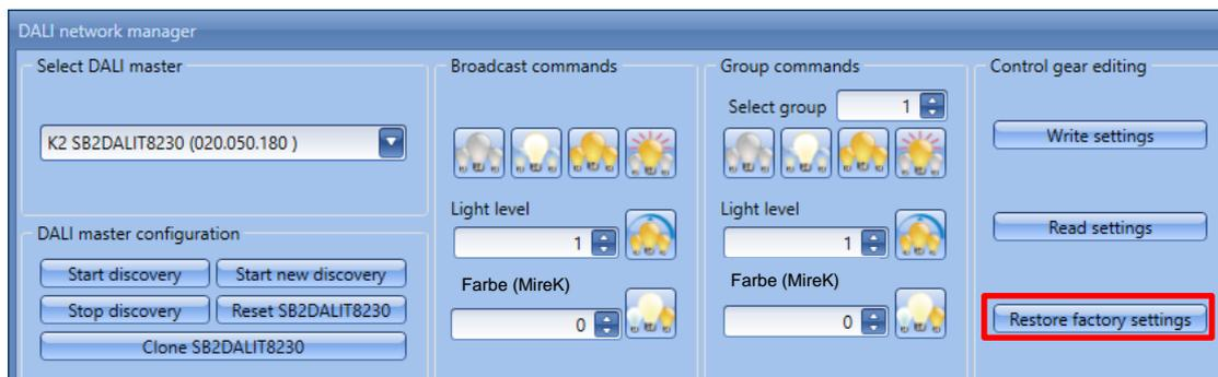
Die Vorschaltgeräte werden auf Werksvoreinstellungen zurückgesetzt: Dies bedeutet, dass alle in den Geräten gespeicherten Einstellungen verloren gehen.
