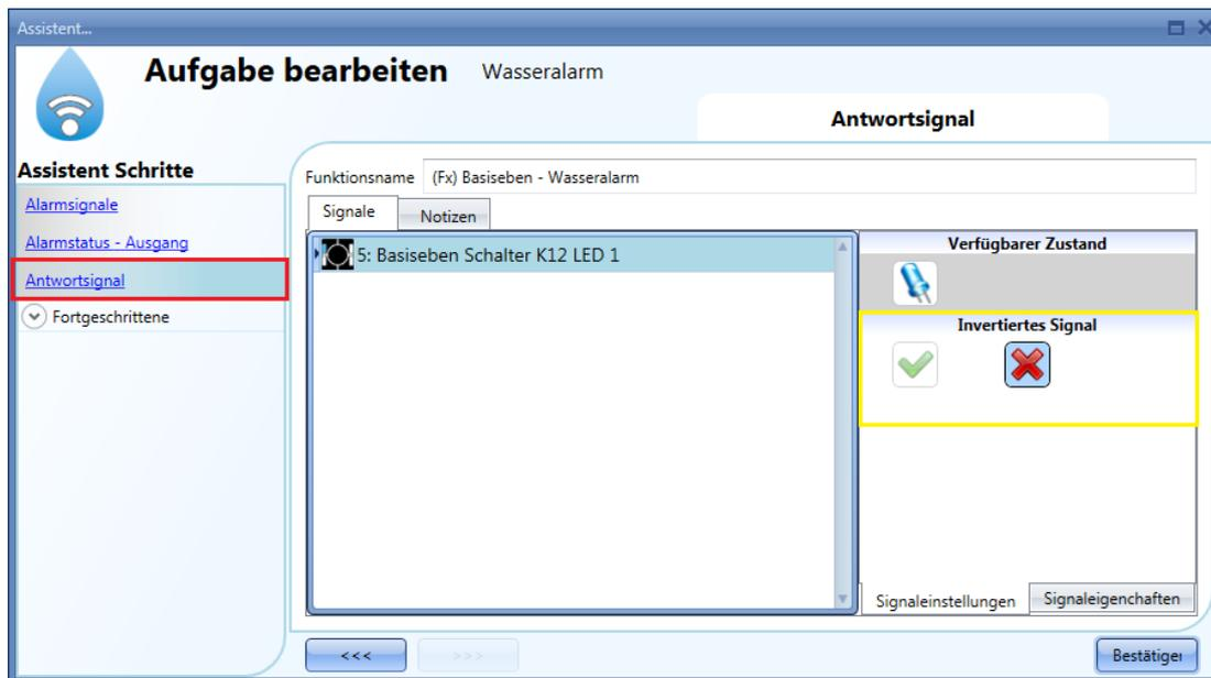
Auf der Registerkarte „Signaleinstellungen“ können Sie die Logik des hinzugefügten Signals invertieren (Abbildung unten, gelber Rahmen).
