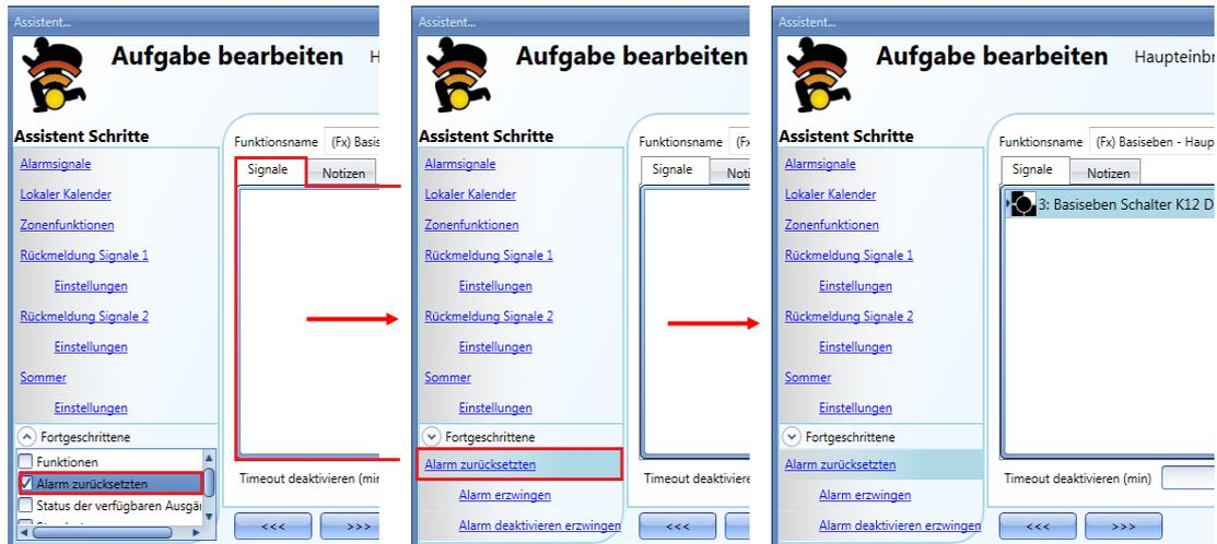
Bei einem Rücksetzsignal kann es sich um ein Ereignis- oder um ein Pegelsignal handeln. Ein Ereignissignal löst einen „Timeout deaktivieren (min)“ aus. Wenn dieser „Timeout deaktivieren (min)“ abgelaufen ist, werden alle Zonen erneut aktiviert.
