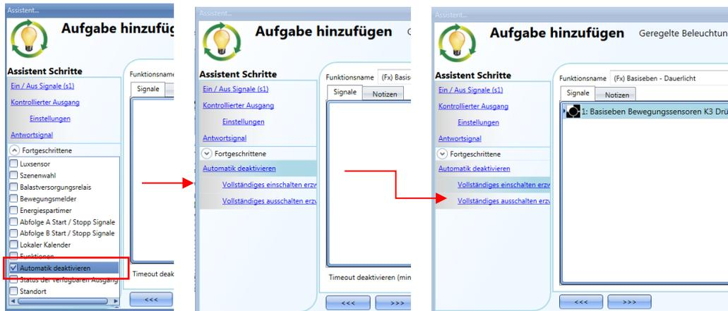
Alle Signale im Fenster „Vollständiges einschalten erzwingen“ fungieren als Pegelsignale: Solange das Signal aktiv ist, ist die Beleuchtung mit einer Stärke von 100% eingeschaltet. Bei Inaktivität des Signals kehrt die Beleuchtung zum vorherigen Status zurück. Wenn sowohl das „Vollständiges einschalten erzwingen“ -Signal als auch das „Vollständiges ausschalten erzwingen“ -Signal aktiv sind, hat das „Vollständiges einschalten erzwingen“ -Signal Vorrang.
