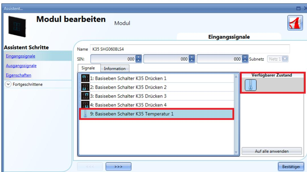
Die Module SHG060WLS4 und SHG060BLS4 sind Glasschalter mit Temperatursensoren, die für alle
