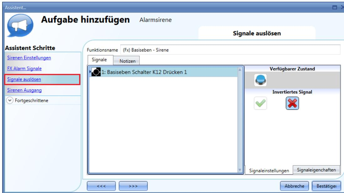
Das bewirkte Verhalten ist beim manuellen Auslösesignal dasselbe wie bei einer Alarmfunktion: Der EIN-Zustand des Signals aktiviert die Sirene. Die Sirene bleibt EIN, bis die „Sirenenzeit (s)“ abgelaufen ist.
