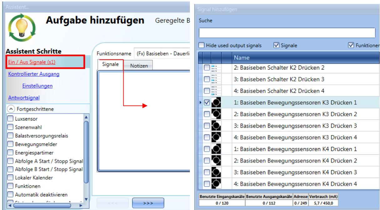
Eine kurze Betätigung (unter 1 Sekunde) schaltet die Beleuchtung ein bzw. aus. Die lange Betätigung hat keine Funktion.
