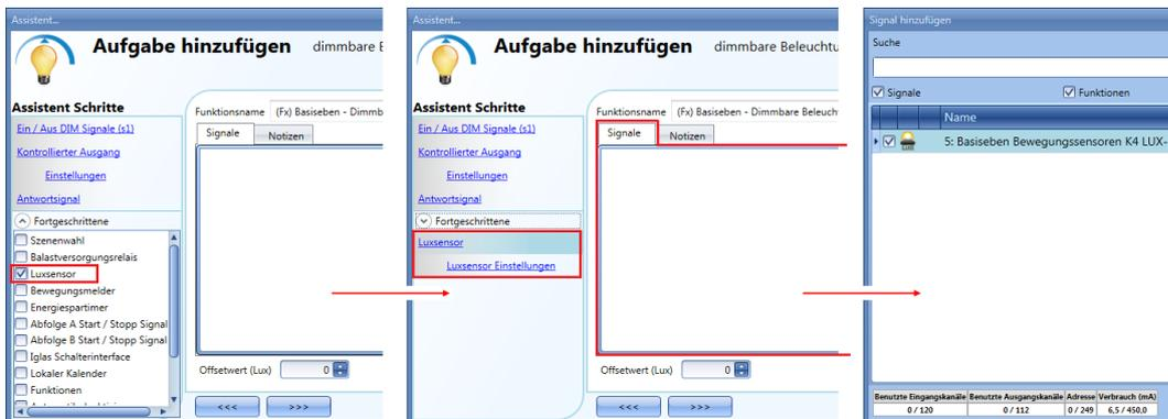
Fügen Sie die gewünschten Helligkeitssensoren (bis zu zehn) hinzu. Wenn mehrere Helligkeitssensoren mit der Funktion verknüpft sind, wird der Durchschnittswert verwendet. Legen Sie anschließend unter „Luxsensor Einstellungen“ die Einstellungen für die Helligkeitssensoren fest.
