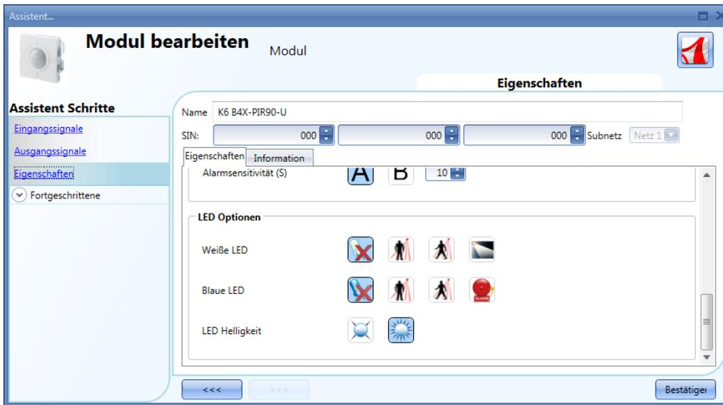
In diesem Fenster wird neben der Empfindlichkeit des Sensors auch das Verhalten der LEDs festgelegt. Die LEDs können als Führungsbeleuchtung, als Feedback für die Anwesenheits- und Bewegungserkennung sowie als Feedback für einen Alarm verwendet werden.
