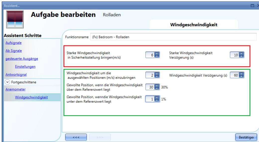
Roter Rahmen: Hier können Sie einen Schwellwert (m/s) für „starken Wind“ festlegen. Ab dieser Windgeschwindigkeit werden die Rollläden automatisch in die Sicherheitsposition gefahren, d. h. in die Position „100%“ (vollständig geöffnet – Standardeinstellung) oder „0%“ (vollständig geschlossen), je nach den Einstellungen unter „gesteuerte Ausgänge“ > „Einstellungen“ > „Sicherheitsposition ist 100%“.
