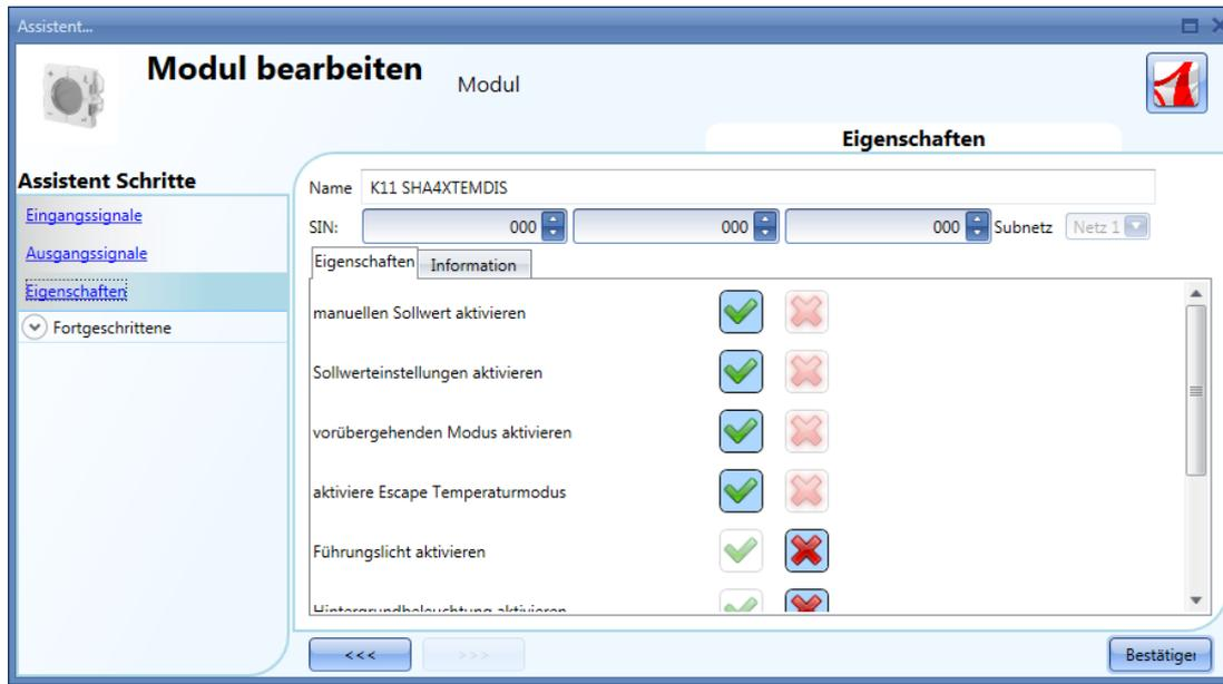
Im Fenster „Eingangssignale“ werden die verfügbaren Temperaturwerte angezeigt. Konfigurationseinstellungen sind nur im Fenster „Eigenschaften“ vorzunehmen.
