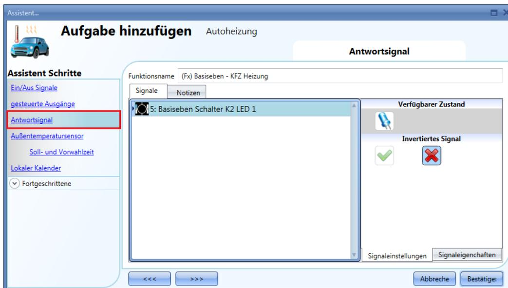
Bei einem Feedback-Signal kann es sich um ein Relais, eine LED oder einen Summer handeln. Das Verhalten des Feedback-Signals richtet sich nach dem Status der Funktion. Wenn die Funktion EIN ist, ist das Feedback-Signal EIN, und wenn sie AUS ist, ist auch das Feedback-Signal AUS.
