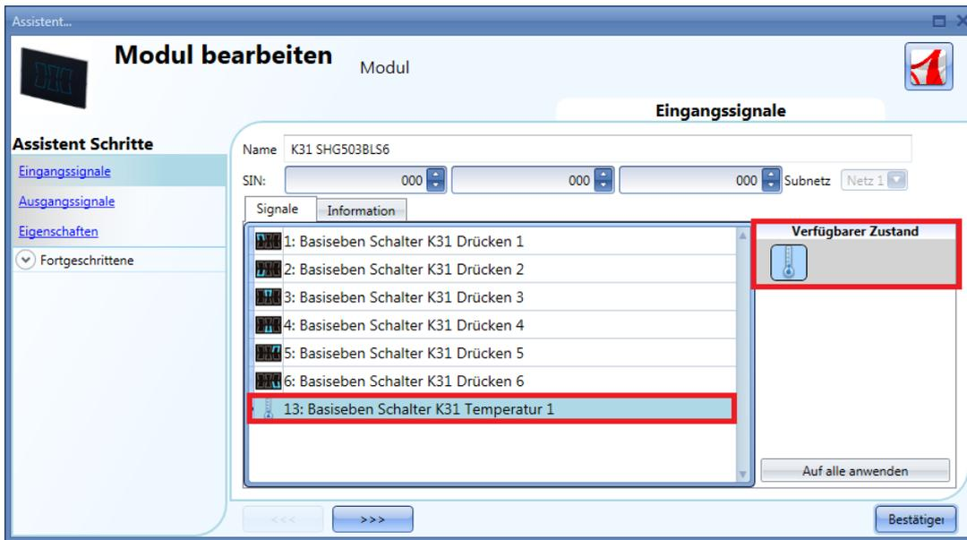
Die Module SHG503WLS6 und SHG503BLS6 sind Glasschalter mit Temperatursensoren, die für alle Temperaturfunktionen verwendet werden können.
