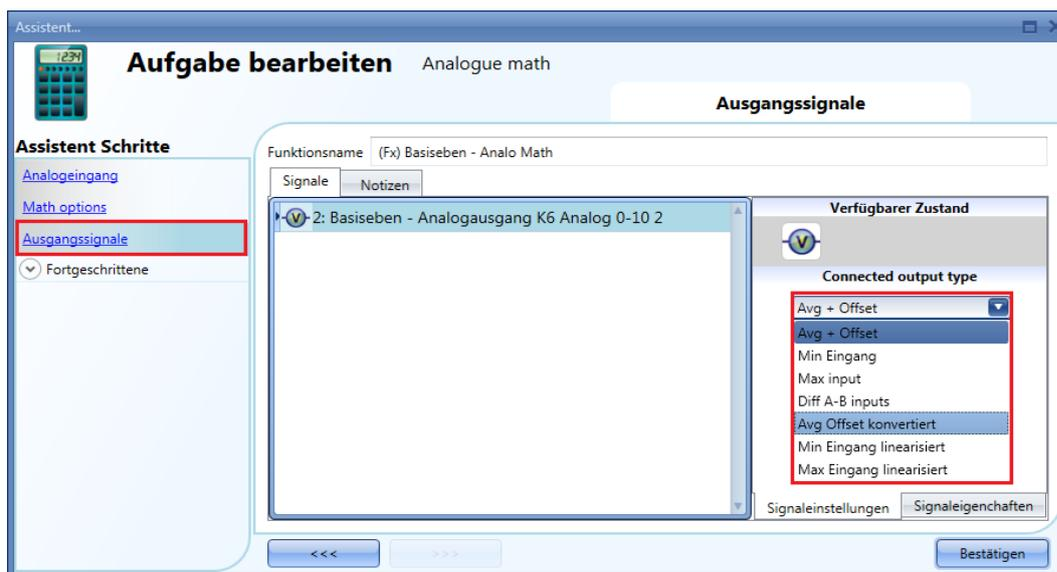
Der Ausgangswert 0–10 V wird anhand eines linearen Verhältnisses zwischen dem Eingangs- und Ausgangswert der *mathematischen Funktion* berechnet.
