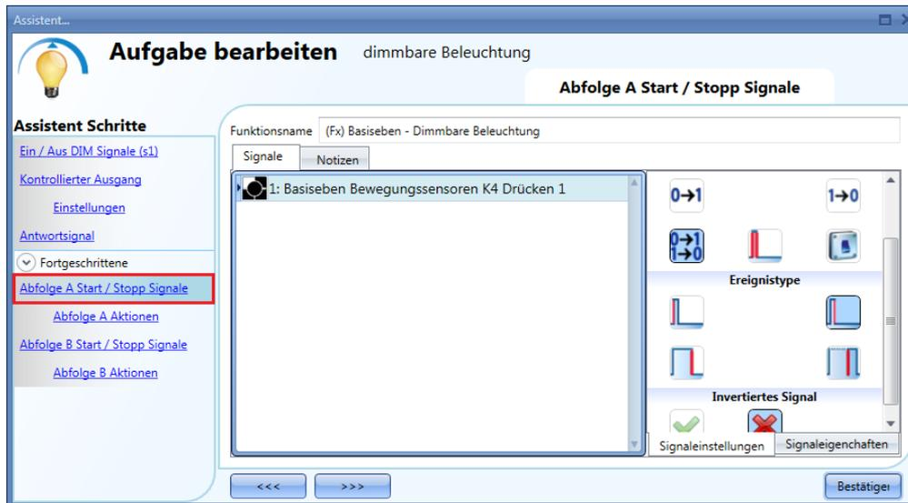
Bei jeder Art von Dimmerbefehl wird die Sequenz gestoppt. Für jedes Signal kann die Logik invertiert werden.
