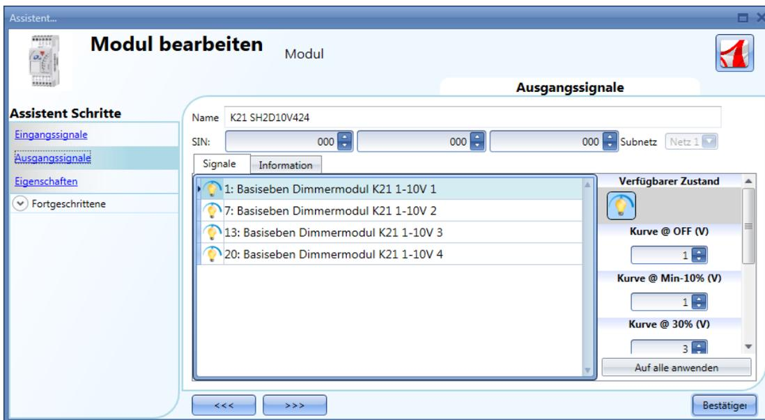
Im Feld „Ausgangssignale“ können Sie die Ausgangskurve gemäß dem Eingangsspannungspegel festlegen, der von der angeschlossenen Last benötigt wird. Die Kurve ist in sechs Schritte unterteilt (0 %, 5 %, 30 %, 50 %, 70 %, 90 %), und für jeden Schritt kann der Spannungspegel definiert werden.
