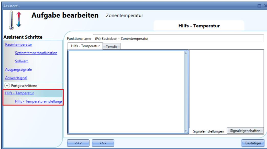
Im Bereich „Aux. temperature settings“ können Sie zwei Schwellwerte festlegen, einen oberen („High temperature threshold“) und einen unteren („Low temperature threshold“). Hysterese und Verzögerungszeit gelten für beide Schwellwerte.
