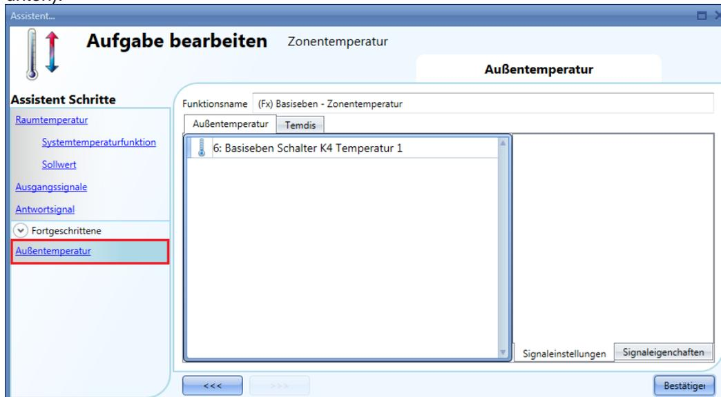
Der Bereich „Outdoor temperature“ wird angezeigt. Dort stehen zwei Signalfenster zur Verfügung: Im Signalfenster „Outdoor temperature“ können Sie die Temperatursignale von gewöhnlichen Sensormodulen (z. B. BSI-TEMANA-U, SHA4XLS4TH und SHE5XLS4TH) hinzufügen. Im Signalfenster „Temdis“ fügen Sie das Tauxiliary-Signal eines TEMDIS-Moduls hinzu.
