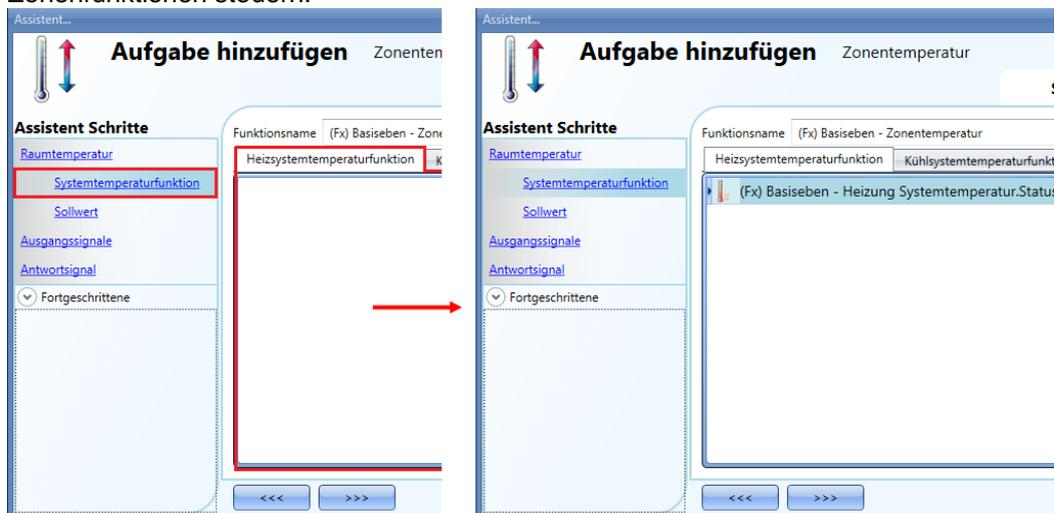
Je nach der hinzugefügten Systemtemperaturfunktion kann die Zonenfunktion nur die Heizung, nur die Kühlung oder beides steuern.
