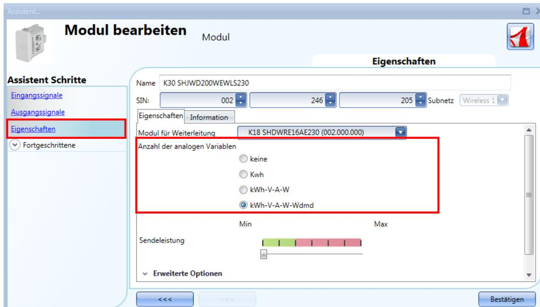
Im Feld „Tx radio power“ können Sie außerdem die Sendeleistung des Moduls einstellen, indem Sie den Schieberegler betätigen.
