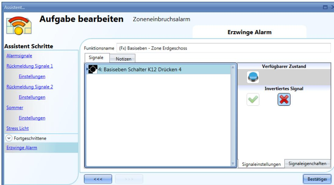
Alle Signale im Fenster „Alarm erzwingen“ fungieren als Pegelsignale: Solange das Signal aktiv ist, befindet sich der Alarm (bzw. befinden sich die Alarmer in den verknüpften Zonen) zwangsweise im EIN-Zustand. Wenn sowohl das „Alarm erzwingen“-Signal als auch das „Alarm deaktivieren erzwingen“-Signal aktiv sind, hat das „Alarm erzwingen“-Signal Vorrang.
