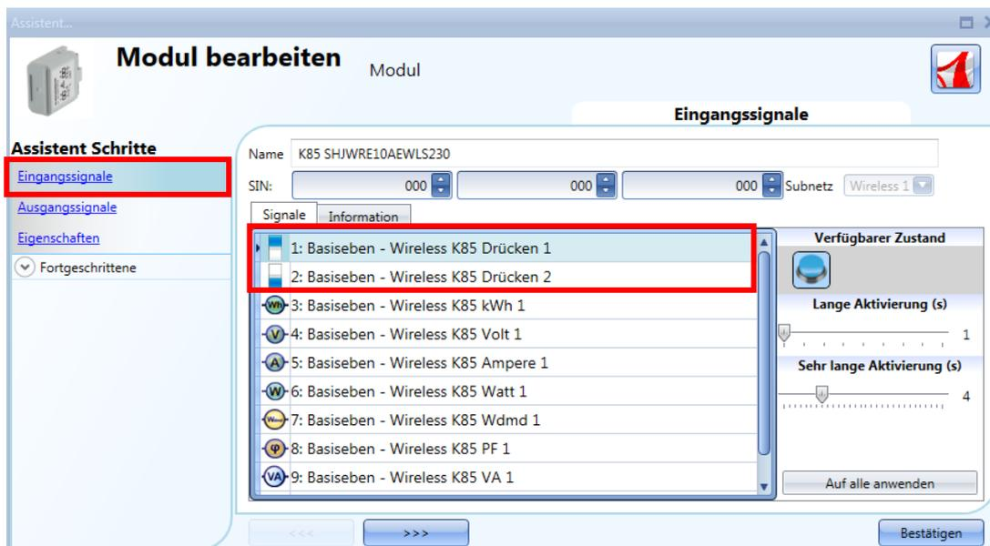
Das Modul SHJWRE10AEExLS230 ist mit zwei programmierbaren kapazitiven Drucktastern ausgestattet und kann für alle Funktionen des Sx-Tools verwendet werden, wie in der Abbildung oben im roten Rahmen dargestellt.
