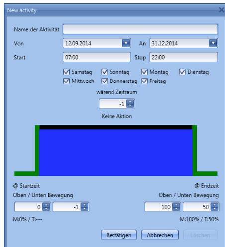
Alle Jalousiefunktionen, in denen der Kalender hinzugefügt wird, werden dann zu den festgelegten Zeiten in die gewünschte Position gefahren. Die folgende Abbildung zeigt einen globalen Kalender, der in allen Jalousiefunktionen verwendet wird. Um 7.00 Uhr morgens werden die Jalousien geöffnet, und um 22.00 Uhr abends werden sie geschlossen sowie um 50 % gekippt.
