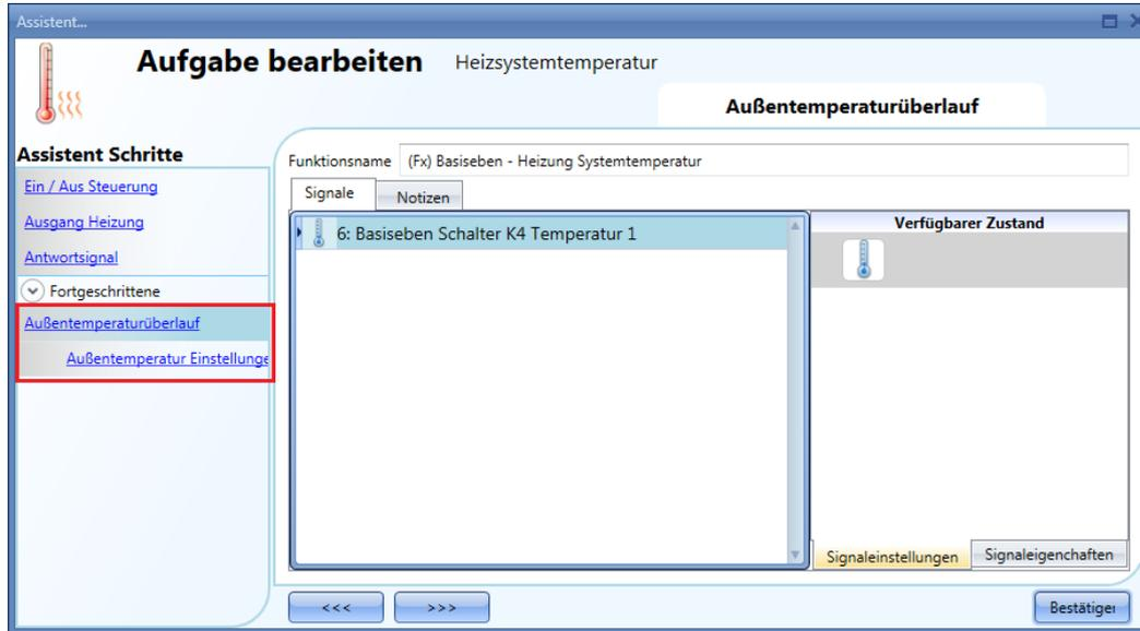
Fügen Sie zunächst die gewünschten Temperatursignale (Sensoren) hinzu. Sie können ein bis zehn Signale hinzufügen. Es wird der Durchschnittswert aller hinzugefügten Signale verwendet. Defekte Temperatursensoren bleiben dabei unberücksichtigt. Im Bereich „Outdoor temperature settings“ können Sie die die genauen Einstellungen festlegen (siehe Abbildung unten).
