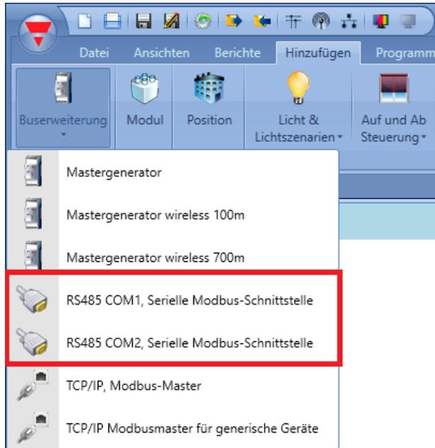
Das virtuelle Gerät „RS485COMxMASTER“ wird im Fenster „*Modules*“ hinzugefügt.
