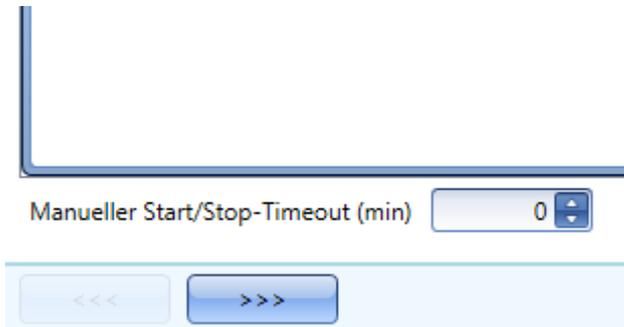
Der Timer startet jedes Mal, wenn ein Eingangssignal aktiviert wird. Nach Ablauf des Timers kehrt der Ausgang zum vorherigen Status zurück. Maximal lassen sich 59 Minuten einstellen. Der Wert 0 deaktiviert den Timer.
