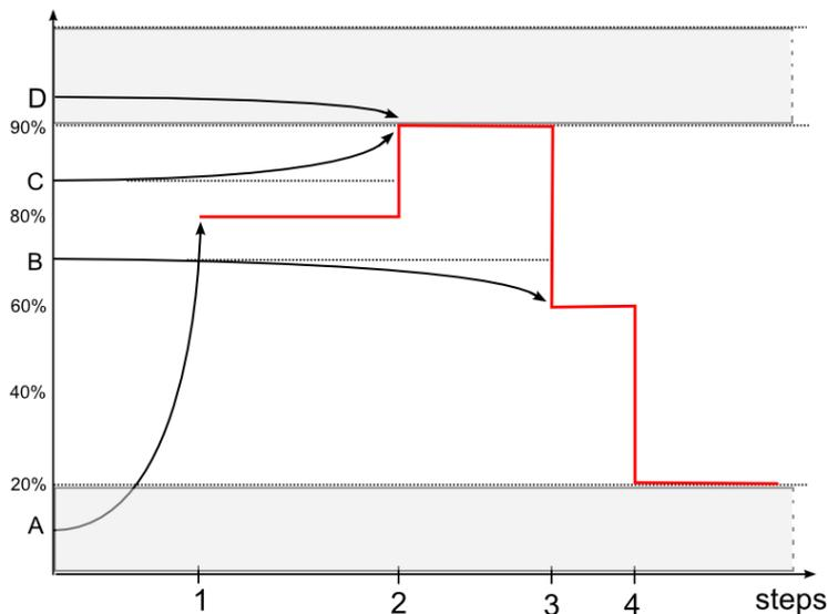
Wenn ein Dimmer bei laufender Sequenz ausgeschaltet wird, greift die Sequenz nicht ein, und der Dimmer bleibt ausgeschaltet.
