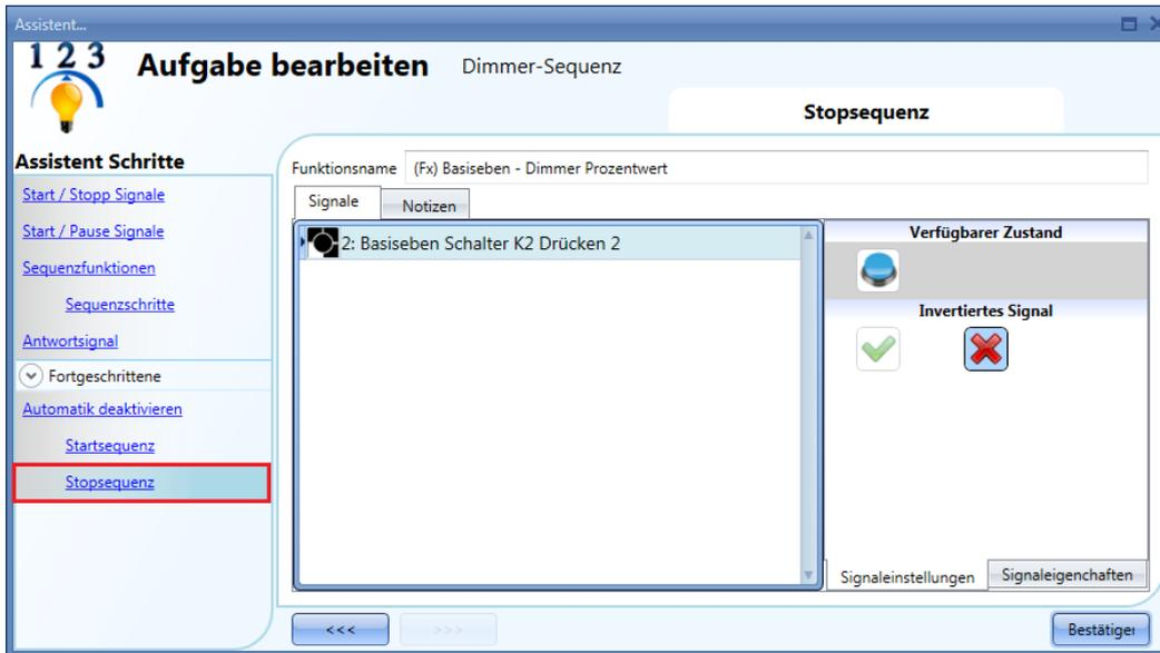
Alle Signale im Fenster „Stopsequenz“ fungieren als Pegelsignale: Solange das Signal aktiv ist, wird die Sequenz gestoppt. Sie kann erst wieder aktiviert werden, wenn das Stoppsignal verschwindet. Wenn sowohl das „Startsequenz“-Signal als auch das „Stopsequenz“-Signal aktiv sind, hat das „Startsequenz“-Signal Vorrang, d. h. die Funktion bleibt aktiviert.
