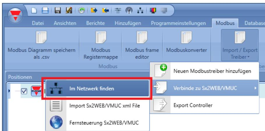
Das Fenster „Discover manager“ mit allen im selben Netzwerk verfügbaren VMUCs und Sx2WEB24s wird angezeigt.
