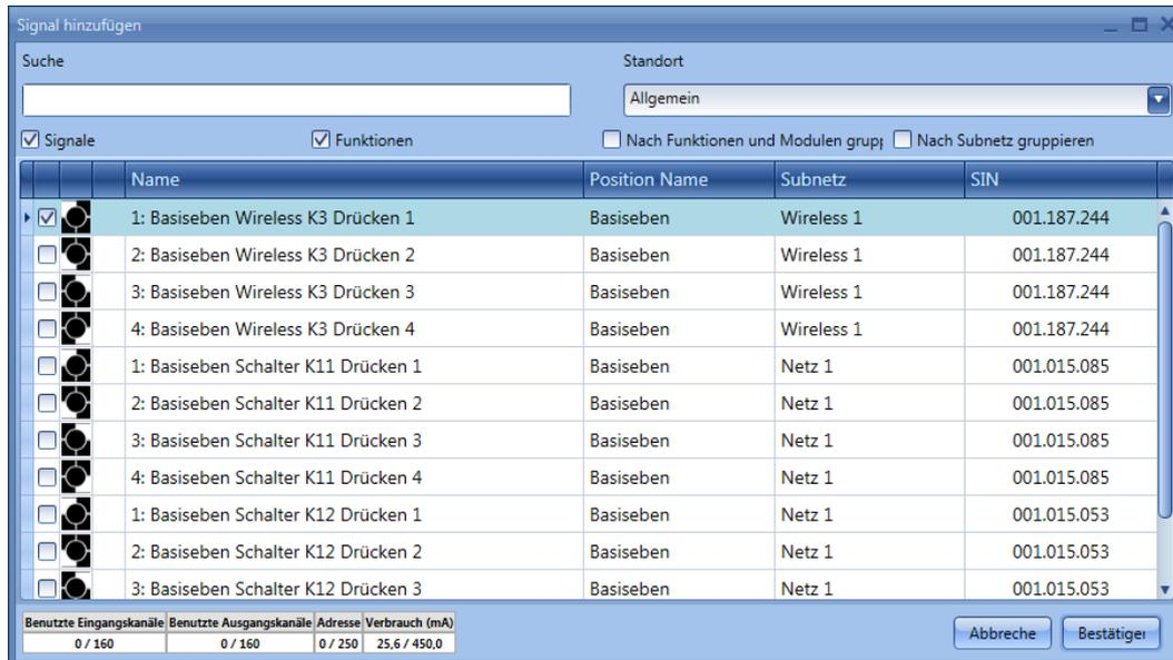
Wählen Sie die Signale aus, mit denen Sie die Beleuchtung steuern möchten. Wenn Sie hier mehr als ein Signal auswählen (maximal 50 sind möglich), wird die Funktion aktiviert bzw. deaktiviert, wenn mindestens ein Signal aktiv ist, weil das smart-house-System die Signale mit einem logischen OR verknüpft.
