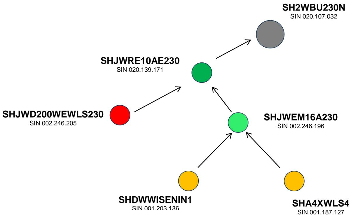
Die Abbildung unten zeigt, welche Einstellungen Sie im Fenster „Properties“ der beiden Module vornehmen müssen, um sie indirekt mit dem drahtlosen Grundmodul zu verbinden, wenn zwei Routing-Ebenen verwendet werden.
