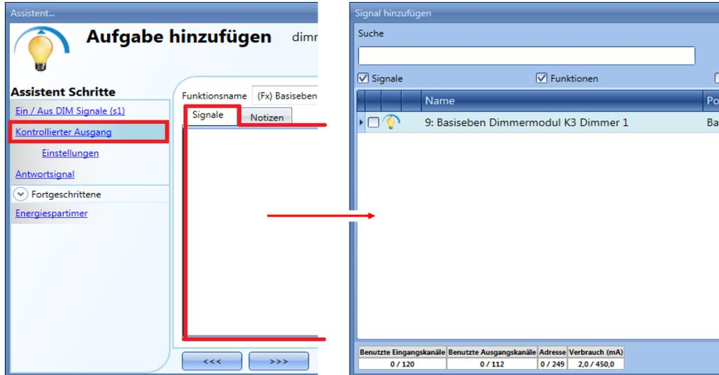
Im Fenster „Signale“ werden nur Ausgänge vom Typ „Dimmer“ angezeigt. Es können bis zu 50 Signale ausgewählt werden, die alle parallel verarbeitet werden.
