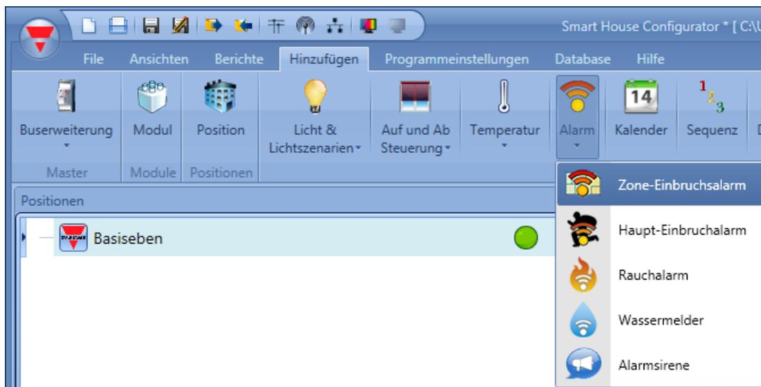
Nachdem Sie die Zonenalarmfunktion hinzugefügt haben, wählen Sie im Menü „Hinzufügen“ die Option „Alarm“ und dann „Haupteinbruchsalarm“ (siehe Abbildung unten). Der Assistent zum Hinzufügen einer Hauptalarmfunktion kann auch mit Alt + A + A + M geöffnet werden (siehe Tabelle mit den Tastenkombinationen).
