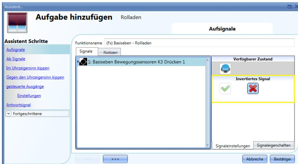
Alle hinzugefügten Aufwärts- bzw. Abwärtssignale arbeiten parallel (OR-Verknüpfung). Das Verhalten des Ausgangs variiert je nach Dauer der Tasterbetätigung:
