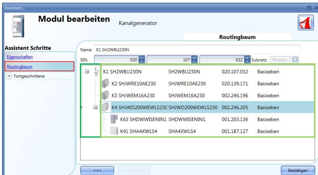
Beispiel 2: Die Module SHDWWISENIN1 und SHA4XWLS4 sind indirekt verbunden und verwenden das Modul SHJWD200WEWLS230 als Router, um mit dem drahtlosen Grundmodul zu kommunizieren (siehe grüner Rahmen in der Abbildung unten). Das SHJWRE10AE230 und das SHJWEM16AE230 sind direkt mit dem drahtlosen Grundmodul verbunden.
