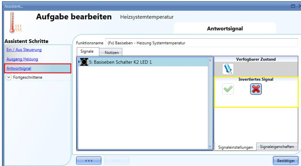
Auf der Registerkarte „Signal settings“ können Sie die Logik des hinzugefügten Signals invertieren (Abbildung oben, gelber Rahmen).
