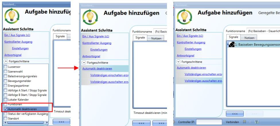
Alle Signale im Fenster „Vollständiges ausschalten erzwingen“ fungieren als Pegelsignale: solange das Signal aktiv ist, ist die Beleuchtung ausgeschaltet. Bei Inaktivität des Signals kehrt die Beleuchtung zum vorherigen Status zurück. Wenn sowohl das „Vollständiges einschalten erzwingen“-Signal als auch das „Vollständiges ausschalten erzwingen“-Signal aktiv sind, hat das „Vollständiges einschalten erzwingen“-Signal Vorrang.
