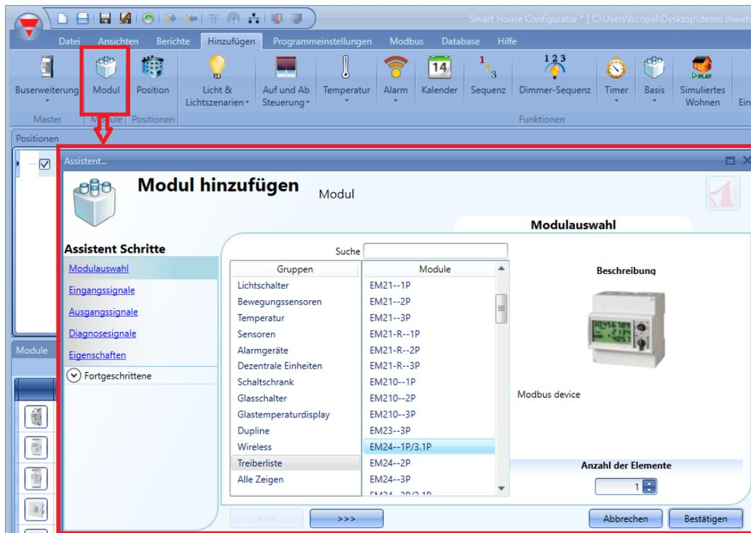
Klicken Sie auf das Bild des Moduls, um den mit dem seriellen Modbus-Modul verbundenen Modbus-Konverter auszuwählen.
