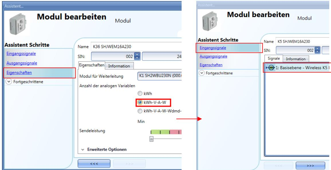
Bei Auswahl des Symbols Kwh-V-A-W-Wdmd-PF-VA-var übermittle das Modul sämtliche zu dieser Gruppe gehörenden Größen: Im Fenster „Input signals“ werden in einer dynamischen Liste alle analogen Messgrößen angezeigt, die zur ausgewählten Gruppe gehören. Ein Beispiel ist in der folgenden Abbildung dargestellt.
