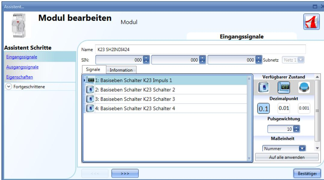
Wie auch beim Modul SH2INDI424 müssen Sie den Betriebsmodus festlegen. Das Modul SH2INDI424 kann als Schalter (Schalter-Symbol) oder als Impulszähler (Zähler-Symbol) konfiguriert werden. Bei der Konfiguration als Impulszähler können Sie im Feld „Pulse weight“ das Gewicht der Impulse angeben.
