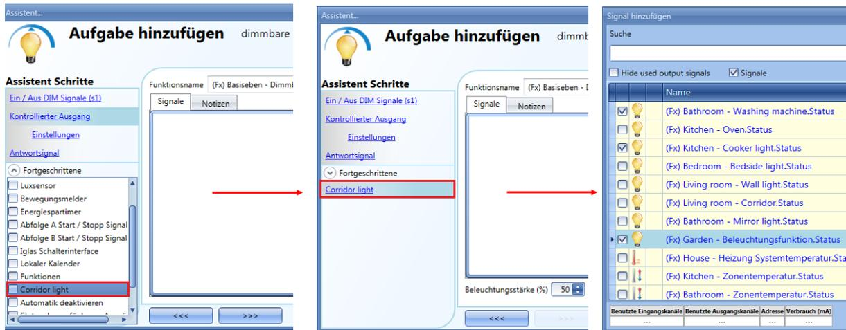
Das Menü „Corridor light“ wird angezeigt. Nach Auswahl dieses Menüs und Doppelklick auf das Fenster „Signale“ (Signale) wird die Liste der verfügbaren Signale angezeigt.
