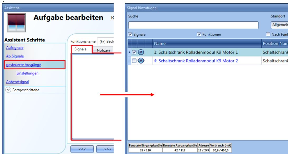
Im Fenster „Signal hinzufügen“ werden nur Ausgänge vom Typ „Motor“ angezeigt. Sie können bis zu 10 Motorausgänge auswählen, die alle parallel verarbeitet werden. Die Ausgänge müssen sich allerdings im selben Dupline-Netzwerk befinden.
