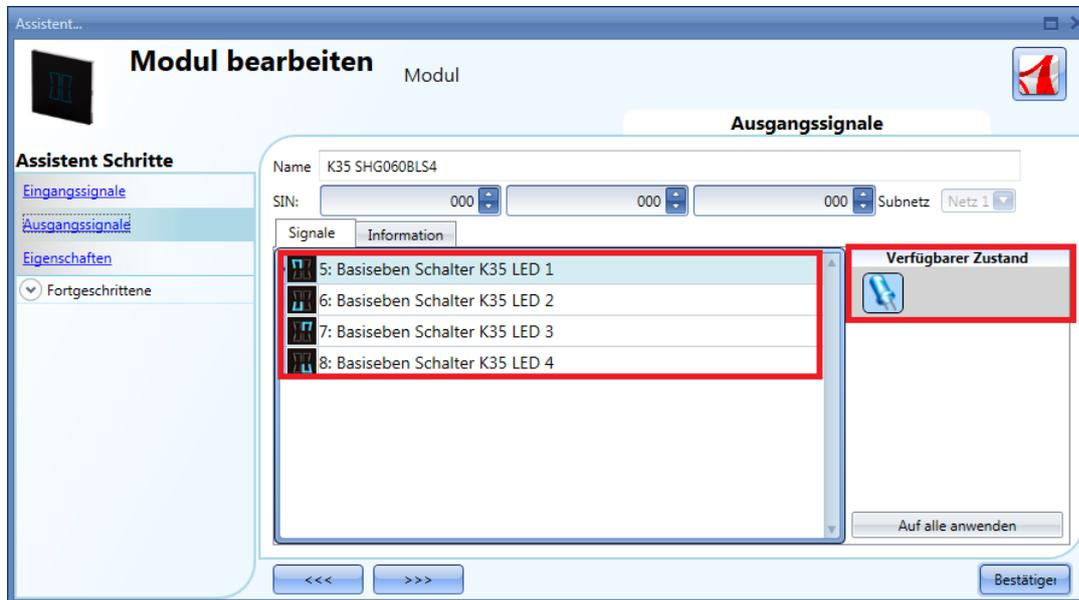
Im Fenster „Ausgangssignale“ werden alle verfügbaren Feedback-LEDs angezeigt. Die LEDs können als Status-LEDs für beliebige smart-house-Funktionen frei programmiert werden.
