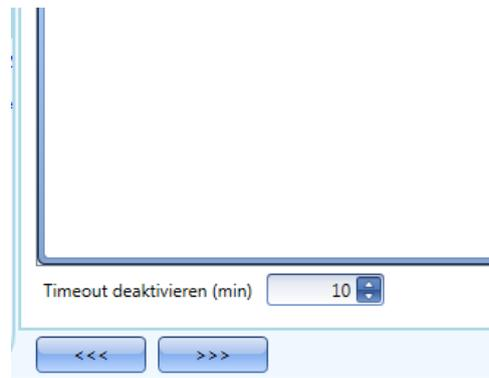
In der Abbildung oben wurde ein „*Timeout deaktivieren (min)*“ von 10 Minuten gewählt. Maximal lassen sich 59 Minuten einstellen.
