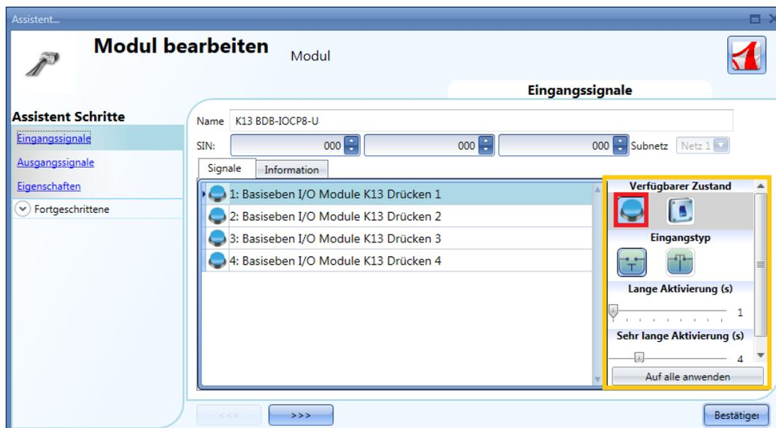
Die konfigurierbaren Einstellungen befinden sich ausschließlich im Fenster „Eingangssignale“. Jeder Eingang kann über eigene Einstellungen verfügen, und als Erstes muss das Verhalten festgelegt werden: Ein Eingang kann als Taster oder als Schalter konfiguriert werden.
