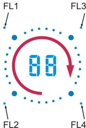
Im Fenster „Ausgangssignale“ werden alle verfügbaren Feedback-LEDs angezeigt. Die Feedback-LEDs können im Feld „Feedback“ einer Funktion verwendet werden.
