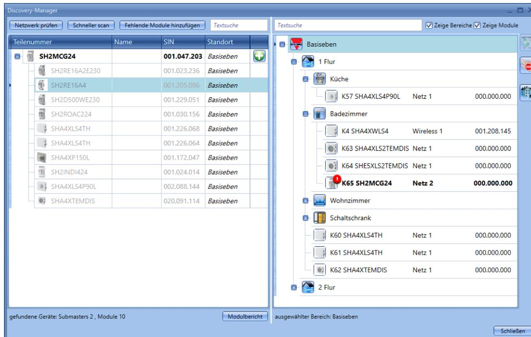
Für jeden gefundenen Master-Generator, wie z.B. der SH2MCG24, SH2DUG24 oder SH2WBU230N zeigt das System ein kleines rotes Symbol (1) über einem Modul, für das eine Zuordnung gemacht werden kann.
