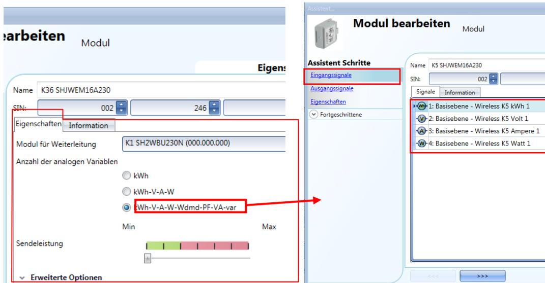
Neben dem Modul SHJWEM16Axxx können Sie auch in allen anderen drahtlosen Modulen mit Energiemessfunktion die Übertragung der analogen Daten deaktivieren.
