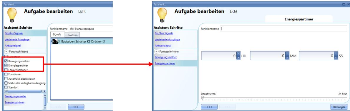
Die Mindestdauer für den Energiespar-Timer beträgt eine Sekunde. Sie können die gewünschte Dauer entweder per Schieberegler oder über die Felder für Stunden, Minuten und Sekunden festlegen.
