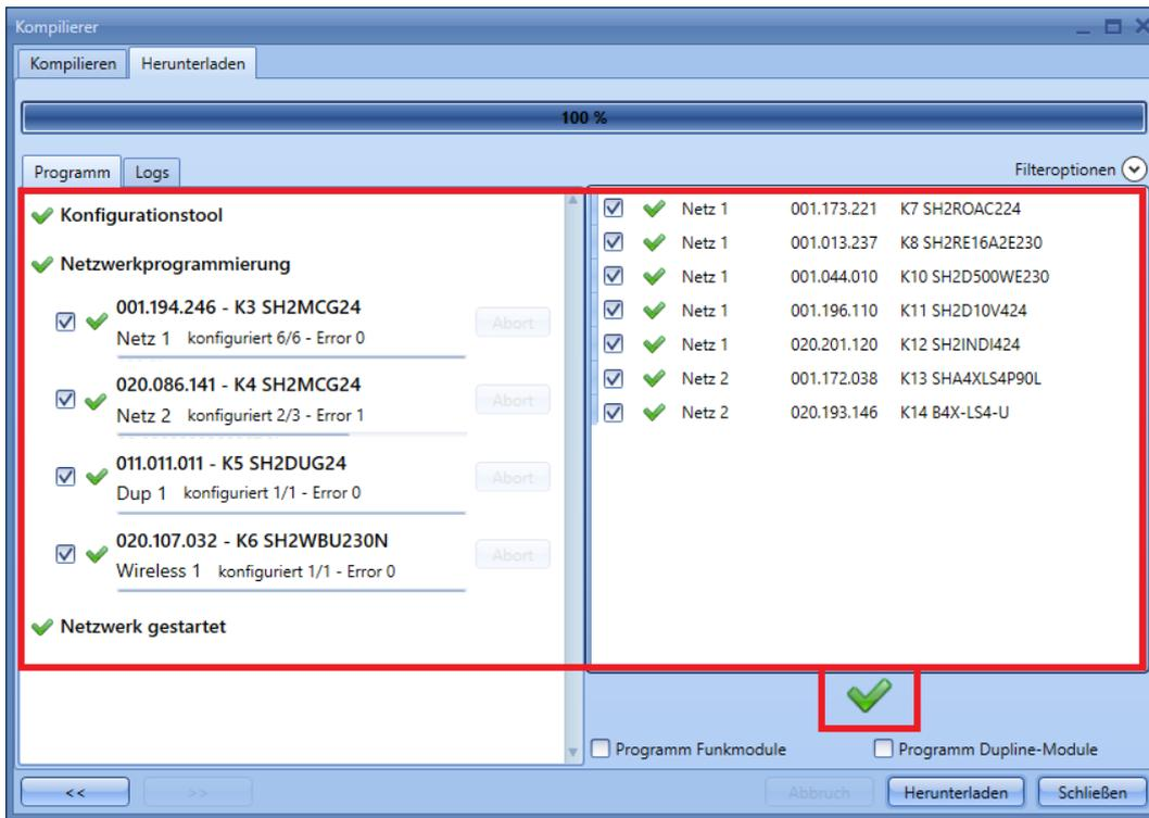
Wenn der Download abgeschlossen ist und alle Module ordnungsgemäß programmiert wurden (grünes Häkchensymbol bei jedem Modul und Netzwerk), wird in der Mitte des rechten Fensterbereichs ein grünes Häkchensymbol angezeigt. Schließen Sie das Fenster „Download“, indem Sie auf die Schaltfläche „Close“ klicken.
