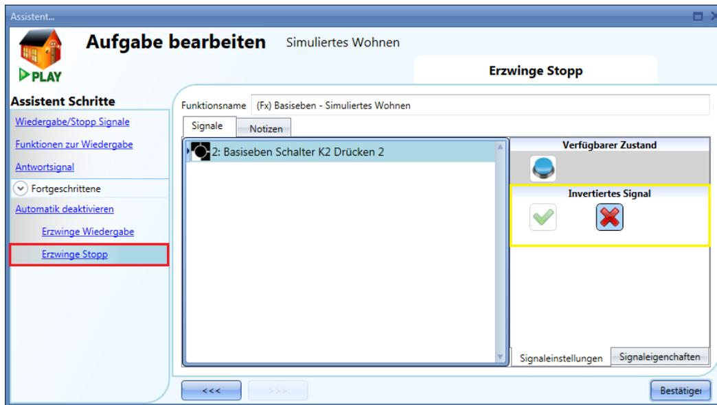
Alle Signale im Fenster „Erzwinge Stopp“ fungieren als Pegelsignale: Solange das Signal aktiv ist, wird der Wiedergabestopp erzwungen (keine Simulation aktiv). Wenn sowohl das „Erzwinge Wiedergabe“-Signal als auch das „Erzwinge Stopp“-Signal aktiv sind, hat das „Erzwinge Wiedergabe“-Signal Vorrang.
