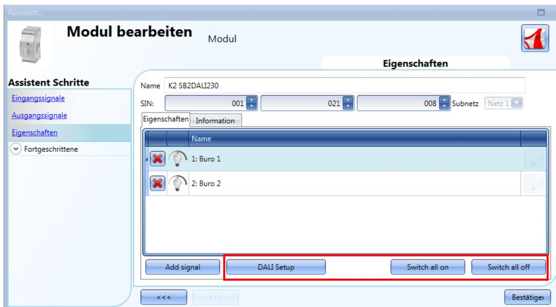
Mithilfe der Schaltfläche „*DALI Setup*“ können Sie einen DALI-Netzwerkscan starten, bei dem das System die am DALI-Bus angeschlossenen Vorschaltgeräte selbständig erkennt.
