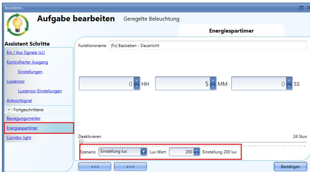
Im unten abgebildeten Beispiel ist im Flur ein PIR vorhanden: wenn dieser eine Bewegung erkennt, wird das Flurlicht mit einer Beleuchtungsstärke von 500 Lux eingeschaltet und verbleibt bei dieser Beleuchtungsstärke, solange der PIR im Flur eine Bewegung erkennt.
