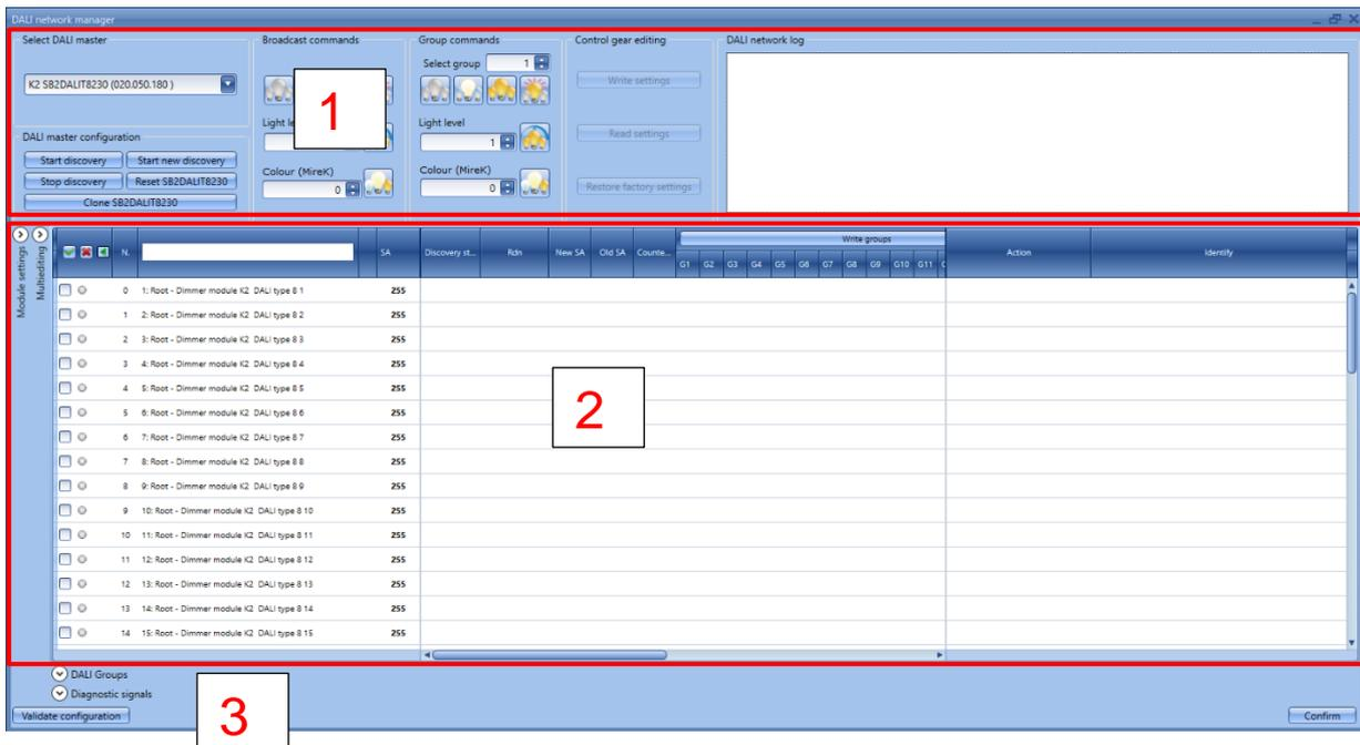
Das Fenster „DALI network manager“ hilft dem Benutzer beim Konfigurieren, Testen und Parametereinstellen für DALI-Vorschaltgeräte. Es kann auch zum Gruppieren von DALI-Vorschaltgeräten und zum Aussenden von Broadcast- und Gruppen-Befehlen benutzt werden. Dieses Fenster ist in drei Bereiche aufgeteilt:
