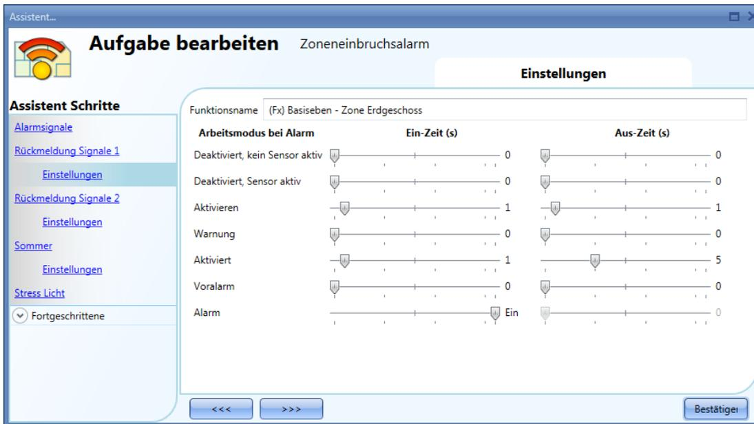
Beispiel 2: Das zweite Beispiel zeigt, wie Sie die Rückmeldung-Aktivierung für den Hauptalarm anpassen können. Wenn alle Zonen aktiviert sind, blinkt das Rückmeldung-Signal im Rhythmus 5 s EIN, 5 s AUS. Bei einem Alarm ist das Rückmeldung-Signal kontinuierlich EIN. Wenn die Funktion nach einem Alarm ein Rücksetzen durch den Benutzer erwartet, blinkt das Rückmeldung-Signal im Rhythmus 1 s EIN, 1 s AUS.
