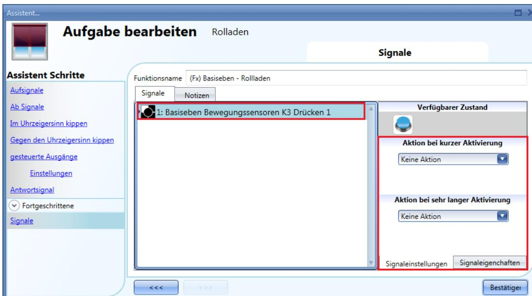
Der Taster in der folgenden Abbildung ist so konfiguriert, dass er bei einer kurzen Betätigung das Signal „Vollständig AUF“ und bei einer langen Betätigung das Signal „Vollständig im Uhrzeigersinn Kippen“ ausgibt.
