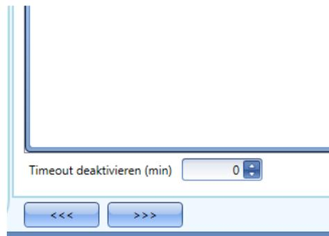
Dieser Timer startet jedes Mal, wenn der Rücksetzstatus aktiviert wird. Die Funktion wird dann nach Ablauf der festgelegten Zeit automatisch wieder aktiviert.
