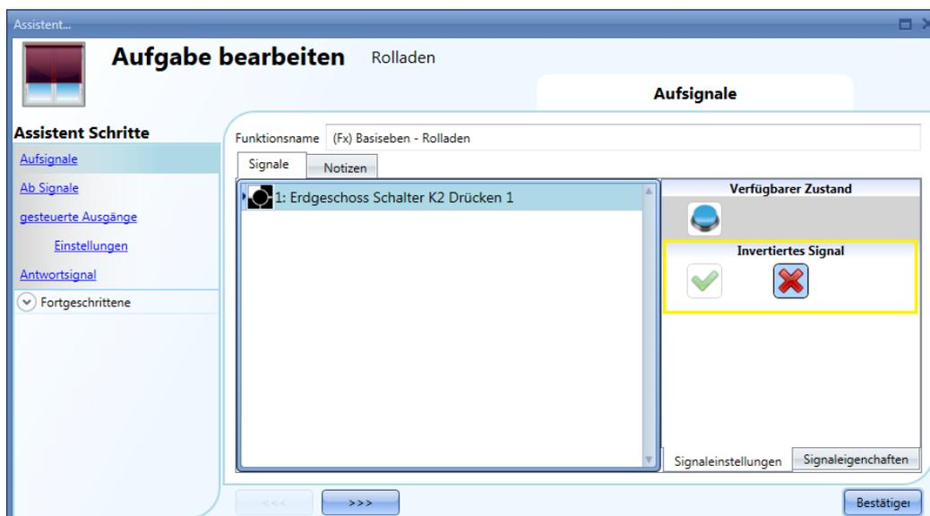
Alle hinzugefügten Aufwärts- bzw. Abwärtssignale arbeiten parallel (OR-Verknüpfung). Das Verhalten des Ausgangs variiert je nach Dauer der Signalaktivität (Tasterbetätigung):
