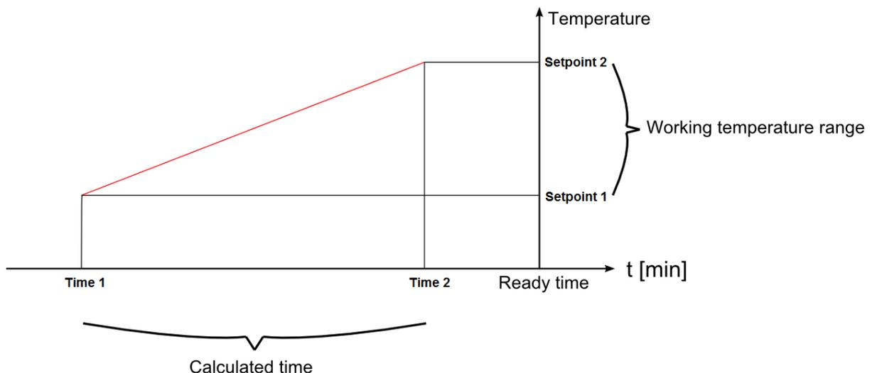
Bei Außentemperaturen kleiner oder gleich „Setpoint 1“ wird die maximale Vorlaufzeit („Time 1“) angewendet. Bei Temperaturen oberhalb von „Setpoint 2“ wird die Heizung gar nicht aktiviert. Bei Außentemperaturen zwischen „Setpoint 1“ und „Setpoint 2“ wird die Vorlaufzeit für die Heizung anhand der roten Linie berechnet.
