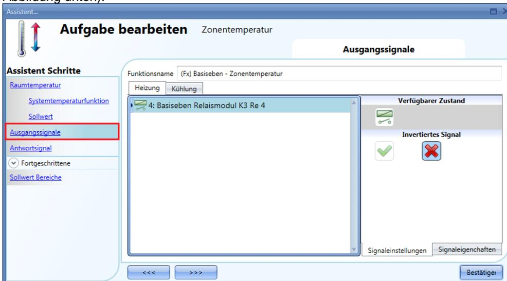
Das Ein-/Ausschalten des Ausgangs wird von der Systemtemperaturfunktion gesteuert. Es gelten dabei die Verzögerungszeiten („Delay On/Off“), die Sie bei der Konfiguration der Systemtemperaturfunktion im Bereich „Heating output“ festgelegt haben.
