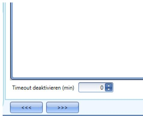
Dieser Timer startet jedes Mal, wenn die Automatisierung deaktiviert wird. Die Automatisierung wird dann nach Ablauf der festgelegten Zeit automatisch wieder aktiviert.
