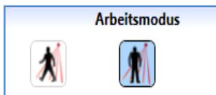
Bei Bewegung wird das Licht auch bei aktivierter Option „PIR einschalen, erlauben“ **nicht** eingeschaltet. Bei Anwesenheit wird der Energiespar-Timer neu gestartet.
