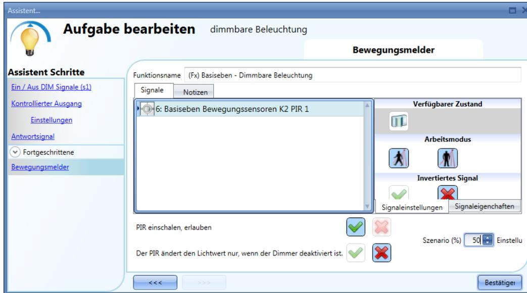
Jedes Mal, wenn der Bewegungssensor eine Bewegung erkennt, wird die Beleuchtungsstärke auf 50% eingestellt, unabhängig von der bisherigen Beleuchtungsstärke der Dimmfunktion.
