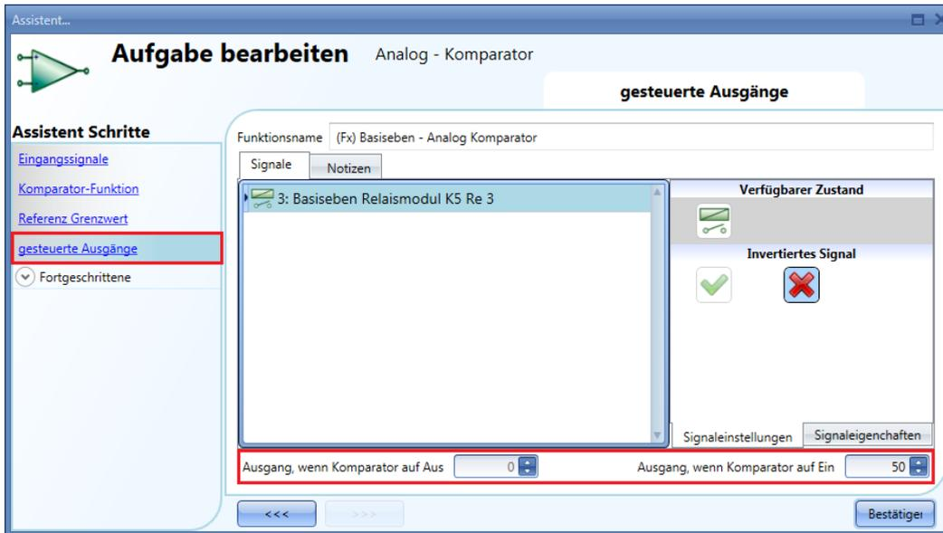
In den Feldern „Ausgang, wenn Komparator auf Aus“ und „Ausgang, wenn Komparator auf Ein“ können Sie die Analogwerte festlegen, die der Ausgang annehmen soll, wenn der Ausgang AUS bzw. EIN ist (Abbildung oben, roter Rahmen).
