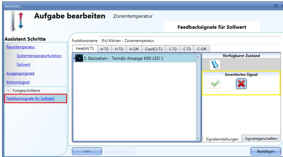
Wie in der Abbildung oben dargestellt, können die LEDs für das Ein- oder Ausschalten programmiert werden, um anzuzeigen, ob die Temperaturfunktion den Sollwert 1, 2 oder 3 zur Regelung nutzt. Auf der Registerkarte „Signal settings“ können Sie die Logik des hinzugefügten Signals invertieren (Abbildung oben, gelber Rahmen).
