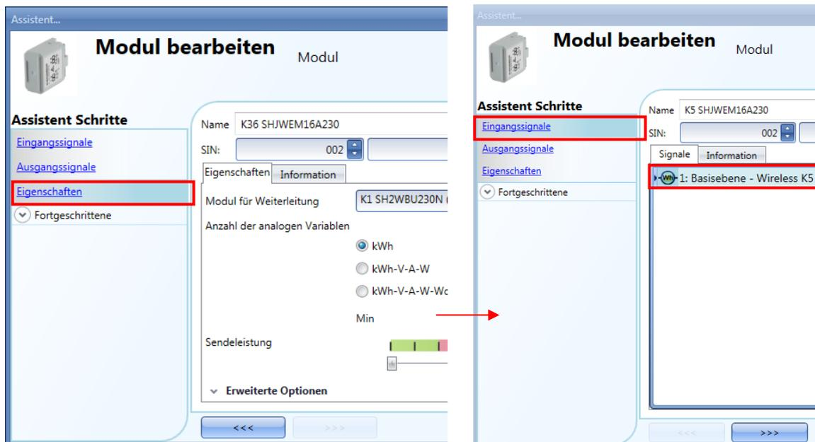
Bei Auswahl des Symbols Kwh - V-A-W übermittle das Modul sämtliche zu dieser Gruppe gehörenden Größen: Im Fenster „Input signals“ werden in einer dynamischen Liste alle analogen Messgrößen angezeigt, die zur ausgewählten Gruppe gehören. Ein Beispiel ist in der folgenden Abbildung dargestellt.
