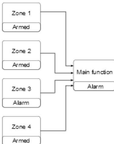
Auch wenn das Alarmeingangssignal nicht mehr aktiv ist, wird die Alarmbedingung gespeichert, und der Status der Hauptalarmfunktion lautet „Warten auf zurücksetzen und Alarm“. So sieht der Benutzer, dass ein Eindringen erkannt wurde. Der Status wird bei der nächsten Deaktivierung der Hauptalarmfunktion zurückgesetzt.
