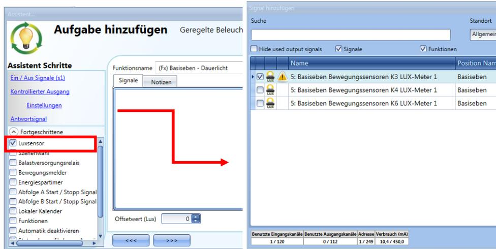
Fügen Sie die gewünschten Helligkeitssensoren (bis zu zehn) hinzu. Wenn mehrere Helligkeitssensoren mit der Funktion verknüpft sind, wird der Durchschnittswert verwendet.
