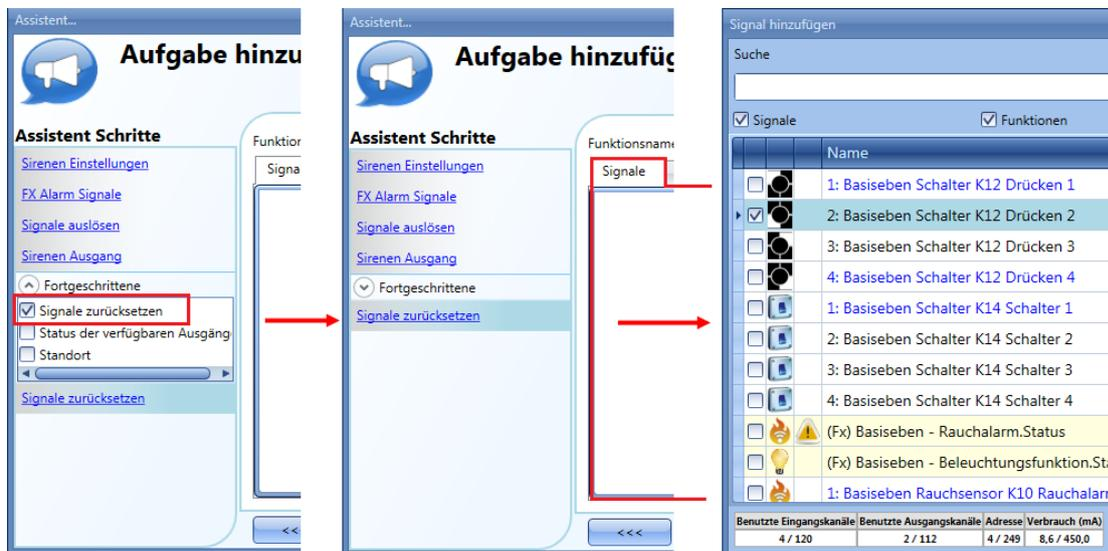
Solange das Rücksetzsignal aktiv ist, ist die Sirene deaktiviert. Erst wenn das Rücksetzsignal in den AUS-Zustand wechselt, kann ein weiteres Alarmsignal die Sirene erneut auslösen.
