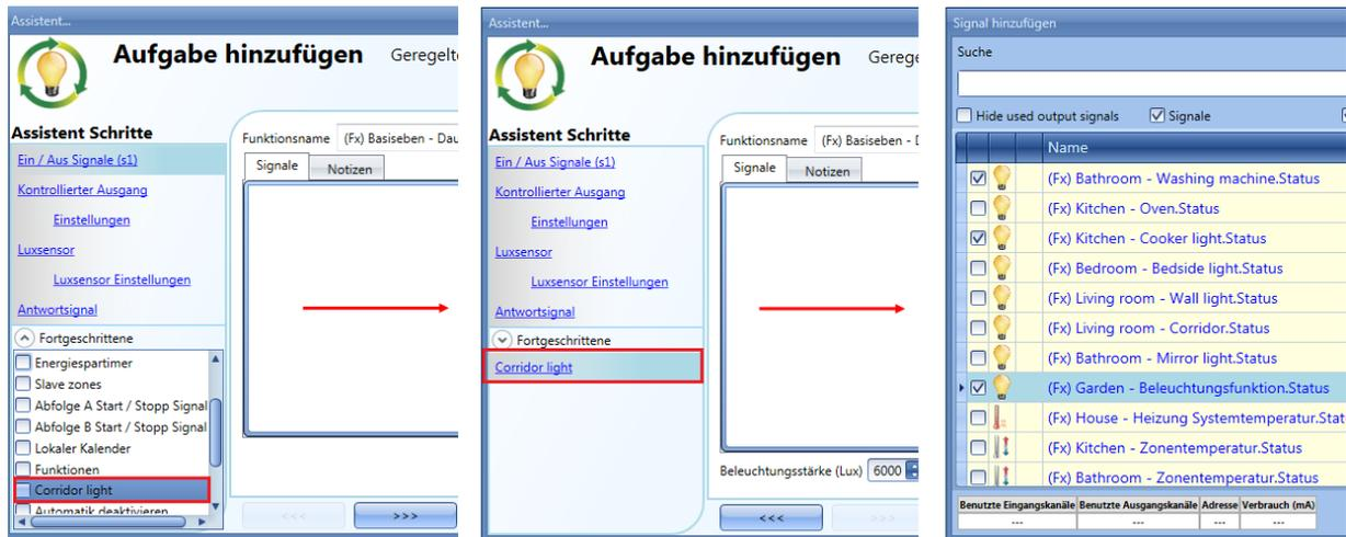
Das Menü „Corridor light“ wird angezeigt. Nach Auswahl dieses Menüs und Doppelklick auf das Fenster „Signale“ (Signale) wird die Liste der verfügbaren Signale angezeigt.
