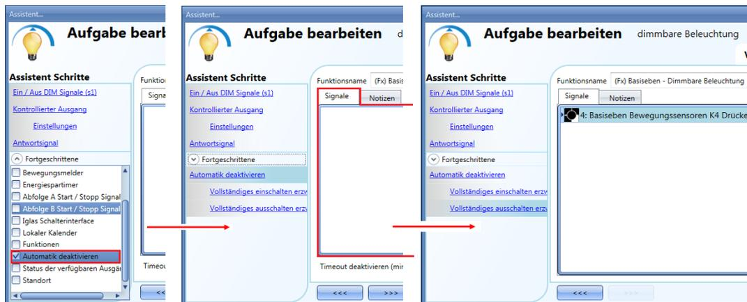
Alle Signale im Fenster „Vollständiges ausschalten erzwingen“ fungieren als Pegelsignale: Solange das Signal aktiv ist, ist die Beleuchtung ausgeschaltet. Bei Inaktivität des Signals kehrt die Beleuchtung zum vorherigen Status zurück. Wenn sowohl das „Vollständiges einschalten erzwingen“-Signal als auch das „Vollständiges ausschalten erzwingen“-Signal aktiv sind, hat das „Vollständiges einschalten erzwingen“-Signal Vorrang.
