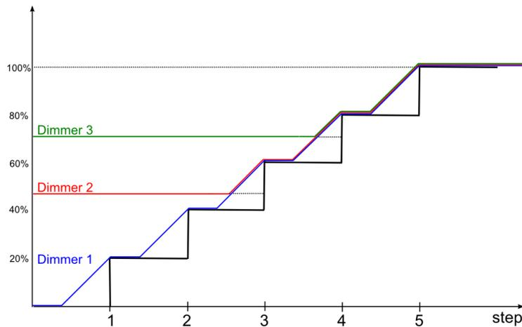
Es gibt Sonderfälle, in denen die einzelnen Schritte einer Sequenz keine lineare Sequenz bilden. Die folgende Abbildung veranschaulicht anhand von vier Dimmern A-D mit jeweils unterschiedlichem Ausgangsniveau, welche Regeln in solchen Fällen gelten. Die Regeln lauten:
