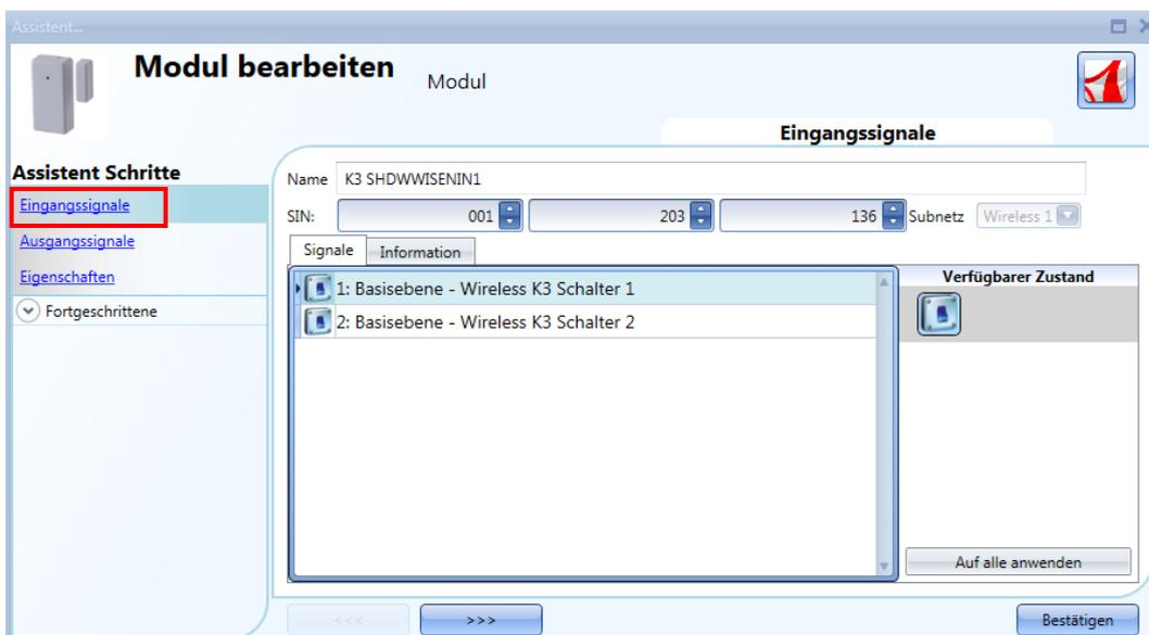
Im Fenster „Input signals“ wird für den SHDWWISEN ein Eingangssignal angezeigt, während für den SHDWWISENIN1 zwei Eingangssignale angezeigt werden, da er zusätzlich einen potenzialfreien Eingang besitzt.
