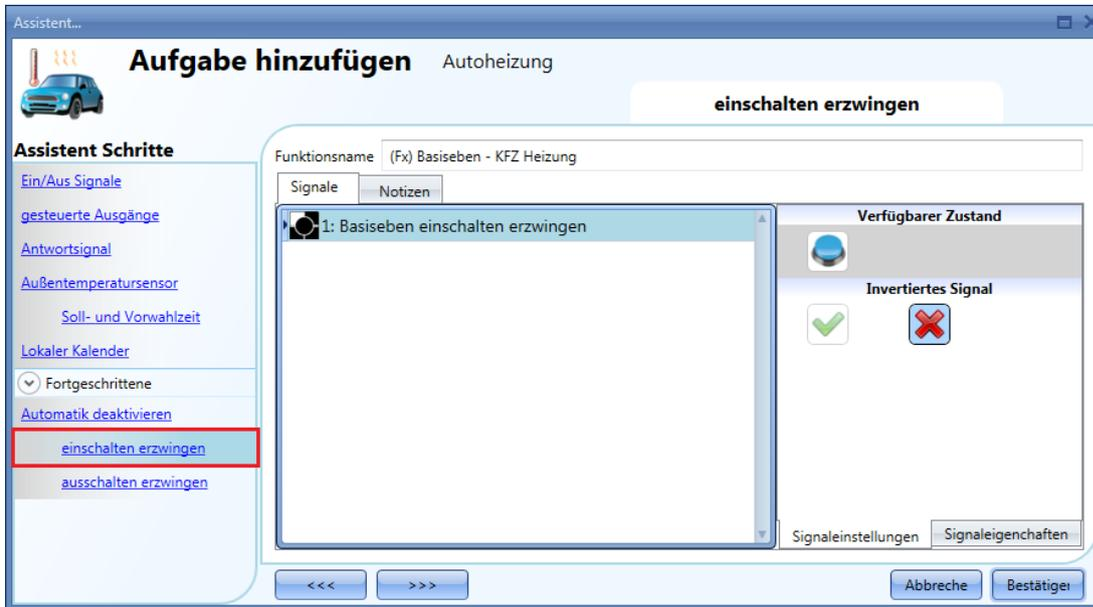
Alle Signale im Fenster „Force output on“ fungieren als Pegelsignale: Solange das Signal aktiv ist, ist die Autoheizungsfunktion eingeschaltet.
