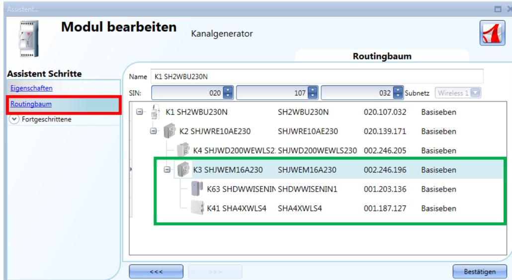
In der Abbildung unten sind die Module SHDWWISENIN1 und SHA4XWLS4 über zwei Router indirekt mit dem drahtlosen Grundmodul verbunden: Der erste Router ist das Modul SHJWEM16AE230, welches direkt mit dem drahtlosen Grundmodul verbunden ist. Der zweite Router ist das SHJWD200WEWLS230, das sich zwischen dem ersten Router und den anderen beiden Slave-Modulen befindet (SHDWWISENIN1 und SHA4XWLS4), wie im grünen Rahmen in der Abbildung unten dargestellt.
