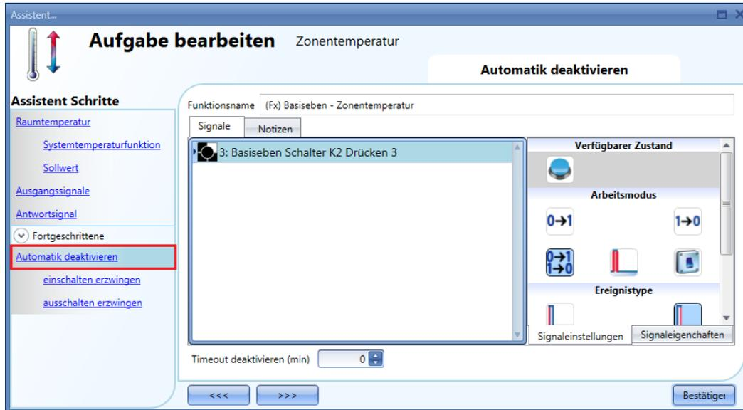
Um sicherzustellen, dass die Automatisierung nach einer gewissen Zeit wieder aktiviert wird, müssen Sie im Feld „Disable Timeout“ einen Wert festlegen. Dieser Timer startet jedes Mal, wenn die Automatisierung deaktiviert wird. Die Automatisierung wird dann nach Ablauf der festgelegten Zeit automatisch wieder aktiviert.
