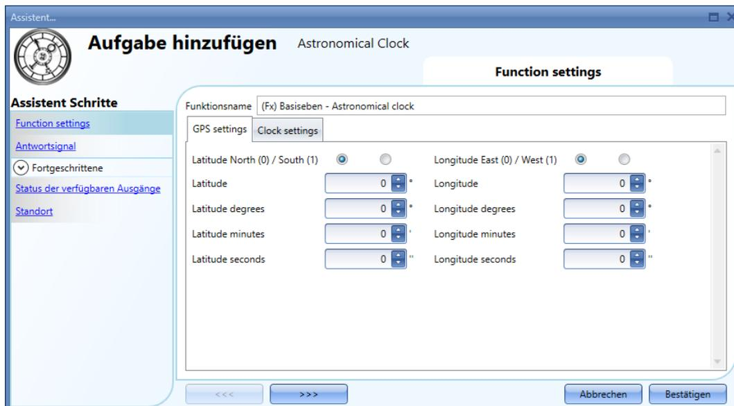
Zur Berechnung von Sonnenaufgang und -untergang muss der Benutzer *Breitengrad* und *Längengrad* des geografischen Standorts der Installation angeben. Diese Daten können in zwei verschiedenen Formaten angegeben werden:
