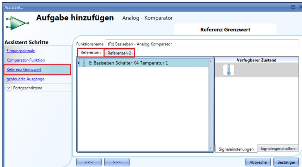
Bei einer Komparator Funktion mit zwei Referenzsignalen (Typen „Innerhalb des Bereichs“ und „Außerhalb des Bereichs“) wird Referenz 1 als unterer Schwellwert und Referenz 2 als oberer Schwellwert verwendet.
