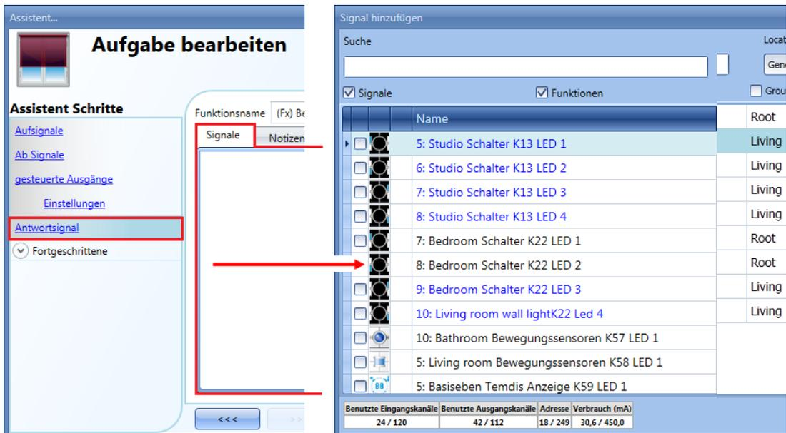
Die in diesem Fenster verfügbaren Signale sind LEDs und Relais. Es können bis zu 50 Signale ausgewählt werden, die alle parallel verarbeitet werden. Die Logik kann einzeln für jedes Feedback-Signal invertiert werden (Option „Invertiertes Signal“, gelber Rahmen).
