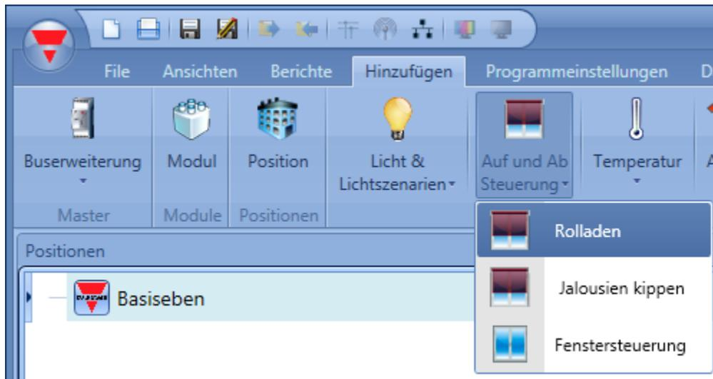
Diese Funktion steuert einen oder mehrere Motorausgänge anhand eines oder mehrerer Eingangsbefehle. Der Eingangsbefehl kann ein physisches Signal (z. B. ein Taster oder Schalter), eine Funktion oder ein Remote-Befehl (Webserver, SMS oder Modbus) sein.
