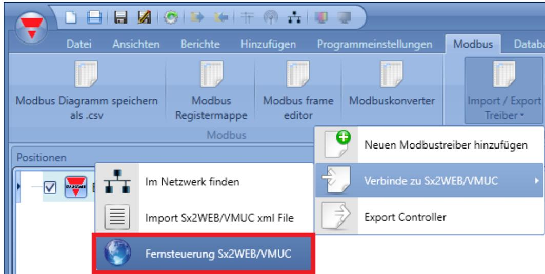
Nach dem Klick auf „Remote Sx2WEB/VMUC“ wird das Fenster „Import manager“ angezeigt. Geben Sie hier die IP-Adresse des entfernten Slave-Moduls ein.
