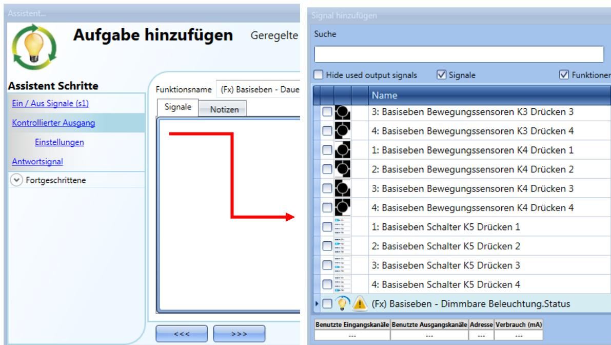
Im Fenster „Signal hinzufügen“ werden nur Ausgänge vom Typ „Dimmer“ angezeigt. Es können bis zu 50 Signale ausgewählt werden, die alle parallel verarbeitet werden. Wenn ein Dimmermodul 1–10 V als Ausgang gewählt wird, muss ein Relaisausgang an das entsprechende Vorschaltgerät angeschlossen werden, um EIN und AUS zu steuern. Fügen Sie den Relaisausgang im Fenster „Antwortsignal“ hinzu.
