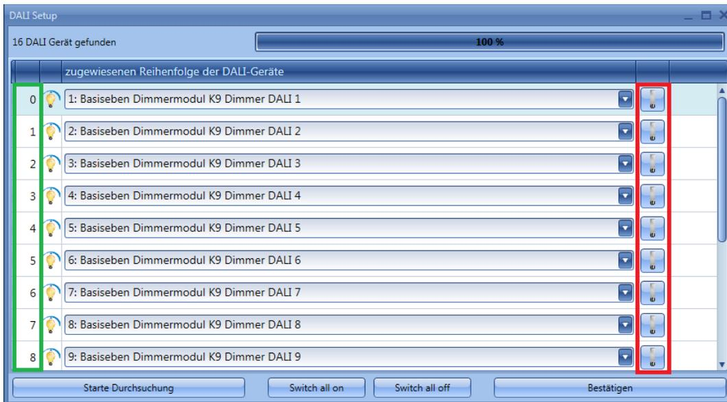
Die Funktion „*Volles Setup*“ weist allen Vorschaltgeräten eine neue Adresse zu, die in der ersten Spalte angezeigt wird (siehe grüner Rahmen). Jedes Vorschaltgerät kann über den entsprechenden Schalter im roten Rahmen ein- und ausgeschaltet werden. Mit dieser Funktion kann der Installateur das Vorschaltgerät lokalisieren, um ihm einen geeigneten Namen zuzuweisen.
