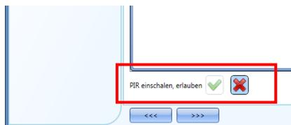
Damit der PIR-Sensor das Licht ausschalten kann, muss der Energiespar-Timer aktiviert sein. Zusätzlich müssen Sie eine Dauer für den Energiespar-Timer festlegen (siehe vorherigen Abschnitt). Die Mindestdauer beträgt eine Sekunde.
