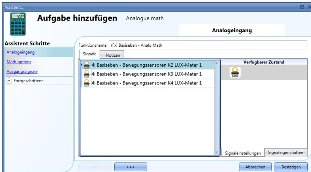
Alle hinzugefügten Signale sind vom gleichen Typ (drei Luxmeter).
