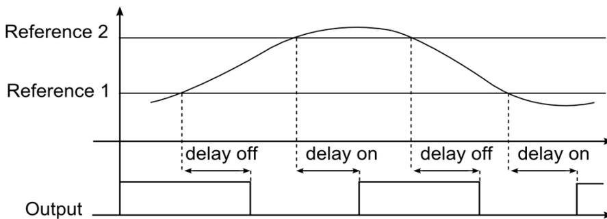
Legen Sie den Schwellwert und die Hysterese für den ausgewählten Komparator typ fest. Bei einem Komparator mit zwei Schwellwerten gilt die Hysterese für beide Schwellwerte. In den Feldern „Einschaltverzögerung (s)“ und „Ausschaltverzögerung“ können Sie festlegen, mit welcher Verzögerung der Ausgang bei einem positiven Komparator Status eingeschaltet bzw. bei einem negativen Komparator Status ausgeschaltet wird.
