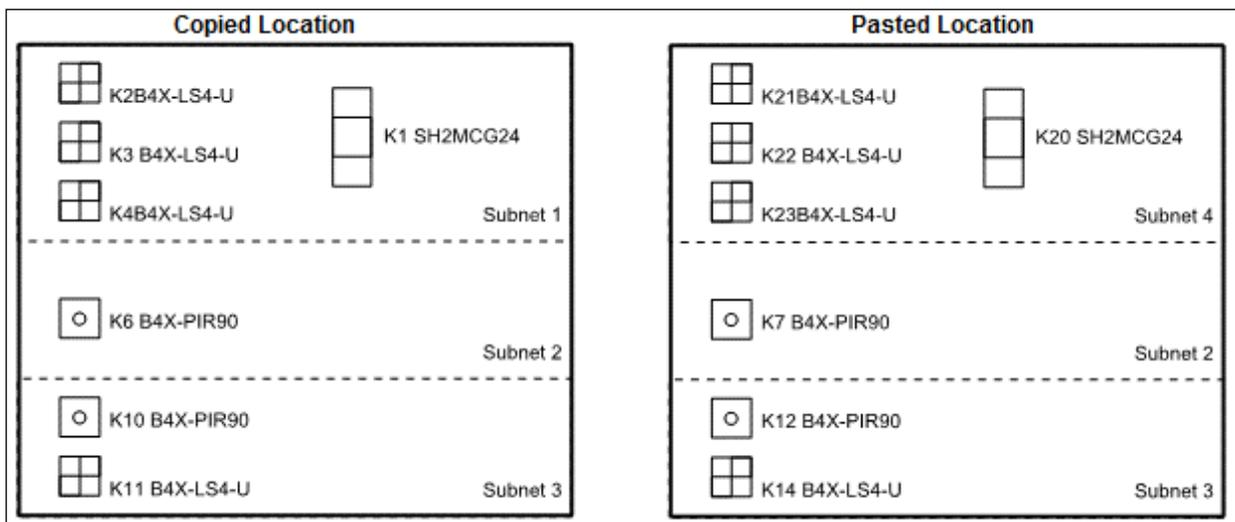
Wenn die Anzahl eingefügter Module zu einer Überschreitung der maximalen Anzahl in einem Subnetz führt, ändert der Kreis rechts vom Baum seine Farbe nach rot. Für alle Module mit ungültigen Adressen (weil sie die für das Subnetz zulässige Anzahl von Modulen überschreiten) wird der Mangel an verfügbaren Kanälen während der Kompilationsphase gemeldet, und es fällt deshalb dem Benutzer zu, das Subnetz für jedes einzelne Modul von Hand einzusetzen, wie in der folgenden Abbildung gezeigt:
