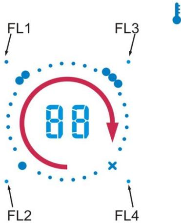
Im Fenster „Ausgangssignale“ werden alle verfügbaren Feedback-LEDs angezeigt. Die Feedback-LEDs können im Feld „Feedback“ einer Funktion verwendet werden.
