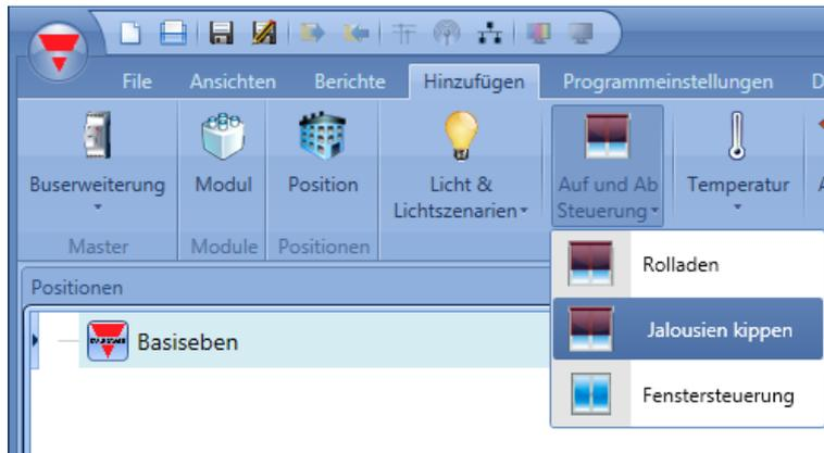
Diese Funktion steuert einen oder mehrere Motorausgänge anhand eines oder mehrerer Eingangsbefehle. Der Eingangsbefehl kann ein physisches Signal (z. B. ein Taster oder Schalter), eine Funktion oder ein Remote-Befehl (Webserver, SMS oder Modbus) sein.
