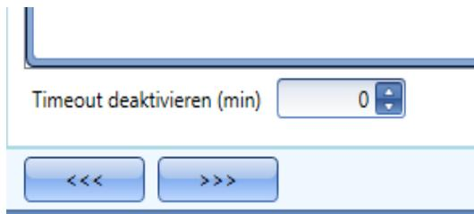
Wenn Sie das „Disable Timeout“ auf 0 setzen, wird die Deaktivierung der Automatisierung nicht automatisch aufgehoben.
