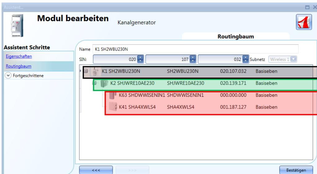
**7.14.7 Modul indirekt über zwei Routing-Ebenen mit einem drahtlosen Grundmodul verbinden**
