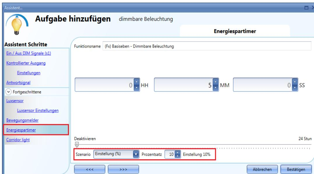
Im unten abgebildeten Beispiel ist im Flur ein PIR vorhanden: wenn dieser eine Bewegung erkennt, wird das Flurlicht gemäß Szenario S2 eingeschaltet und verbleibt bei dieser Beleuchtungsstärke, solange der PIR im Flur eine Bewegung erkennt.
