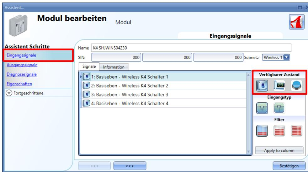
Für die Einstellungen des SHJWINS04xxx muss der Benutzer im *Eingangssignale*-Feld den Betriebsmodus wählen: Dieser kann als Schalter (das Schalter-Symbol muss gewählt werden), als Pulszähler durch Wahl des Symbols mit der 123-Anzeige oder als Drucktaste (das dritte Symbol muss gewählt werden) konfiguriert werden.
