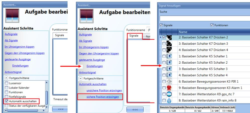
Alle Signale im Fenster „sichere Position erzwingen“ fungieren als Pegelsignale: Solange das Signal aktiv ist, befinden sich die Jalousien zwangsweise in der Sicherheitsposition. Wenn sowohl das „sichere Position erzwingen“-Signal als auch das „unsicheren Position erzwingen“-Signal aktiv sind, hat das „sichere Position erzwingen“-Signal Vorrang.
