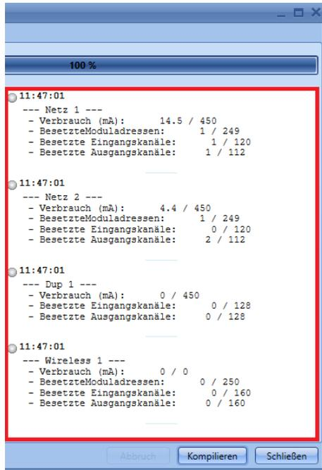
Dieselbe Übersicht wird auch angezeigt, wenn Sie den Mauszeiger im Fenster „*Location*“ auf das kleine runde Symbol bewegen, welches jedes einzelne Netzwerk darstellt. Es wird eine Quickinfo mit den aktualisierten Daten angezeigt.
