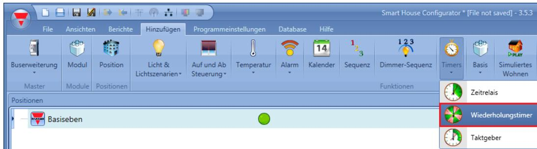
Bei der Zyklus-Timer-Funktion bewirkt das Startsignal, dass der Ausgang zyklisch zwischen EIN- und AUS-Zustand wechselt.
