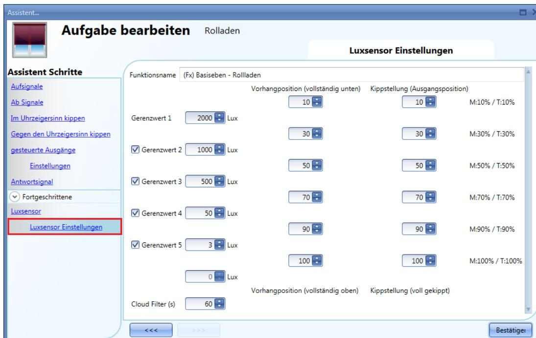
Die Aufwärts-/Abwärtsbewegungen sowie das Kippen werden nur einmal, bei Erreichen des Schwellwertes, ausgeführt. Spätere Veränderungen (manuell, z. B. per Taster, oder automatisch, z. B. per Kalender) bleiben so lange erhalten, bis erneut ein Schwellwert erreicht wird.
