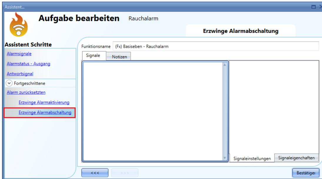
Alle Signale im Fenster „Erzwing Alarmabschaltung“ fungieren als Pegelsignale: Solange das Signal aktiv ist, befindet sich die Funktion zwangsweise im AUS-Zustand (Ausgang inaktiv). Wenn sowohl das „Erzwing Alarmaktivierung“-Signal als auch das „Erzwing Alarmabschaltung“-Signal aktiv sind, hat das „Erzwing Alarmaktivierung“-Signal Vorrang.
