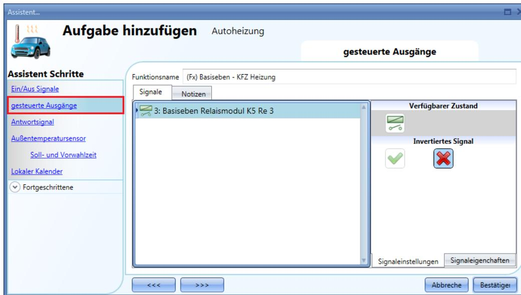
Bei einem Ausgangssignal kann es sich um ein Relais, eine LED oder einen Summer handeln. Das Verhalten des Ausgangssignals richtet sich nach dem Status der Funktion. Wenn die Funktion EIN ist, ist der Ausgang aktiv, und wenn sie AUS ist, ist auch der Ausgang inaktiv.
