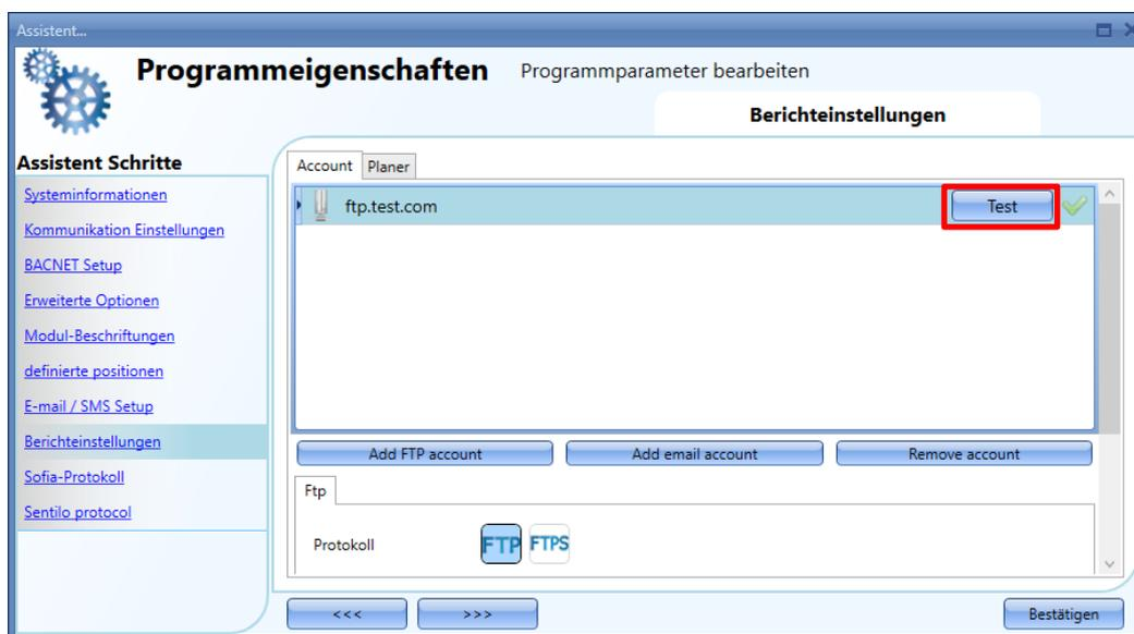
Der Kommunikationstest wird sofort gestartet: Das Testergebnis wird durch ein Symbol auf der rechten Seite angezeigt:
