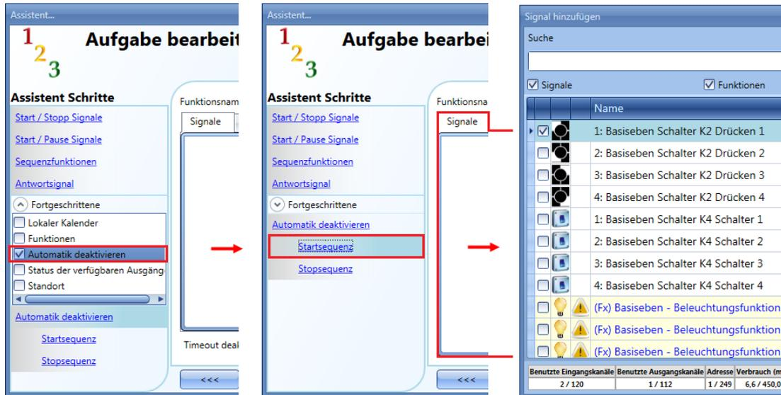
Alle Signale im Fenster „Startsequenz“ fungieren als Pegelsignale: Solange das Signal aktiv ist, wird die Sequenz ausgeführt. Sie kann erst wieder gestoppt werden, wenn das Startsignal verschwindet. Wenn sowohl das „Startsequenz“-Signal als auch das „Stopsequenz“-Signal aktiv sind, hat das „Startsequenz“-Signal Vorrang, d. h. die Funktion bleibt aktiviert.
