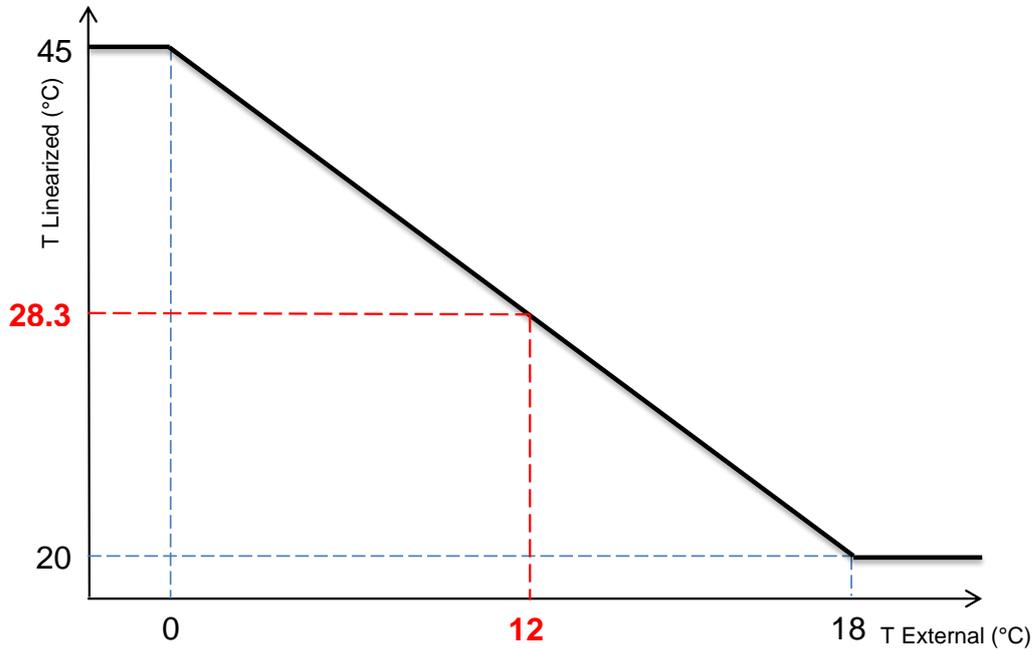
Die linearisierten Werte werden als *Virtual Range* (Virtueller Bereich) für die *Output Range* (Ausgangsbereich, in Volt) verwendet.
