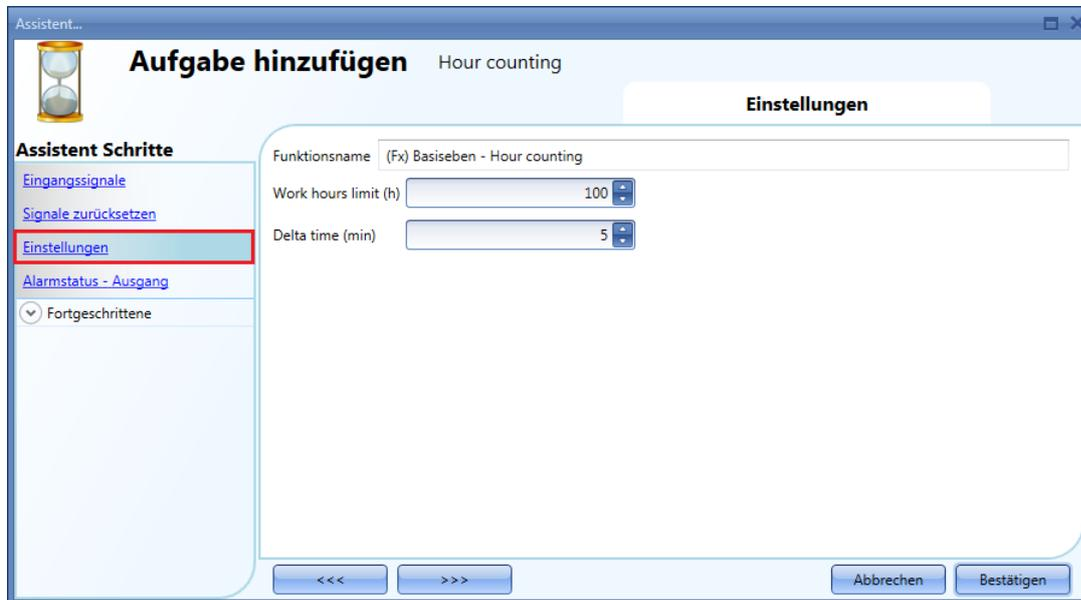
In diesem Fenster kann im Feld „Working time“ (Betriebsdauer) der Schwellwert festgelegt werden: Wenn der Zählerwert über dem Wert der Funktion „Hour counting“ liegt, wird der Alarmstatus aktiviert, andernfalls bleibt er deaktiviert.
