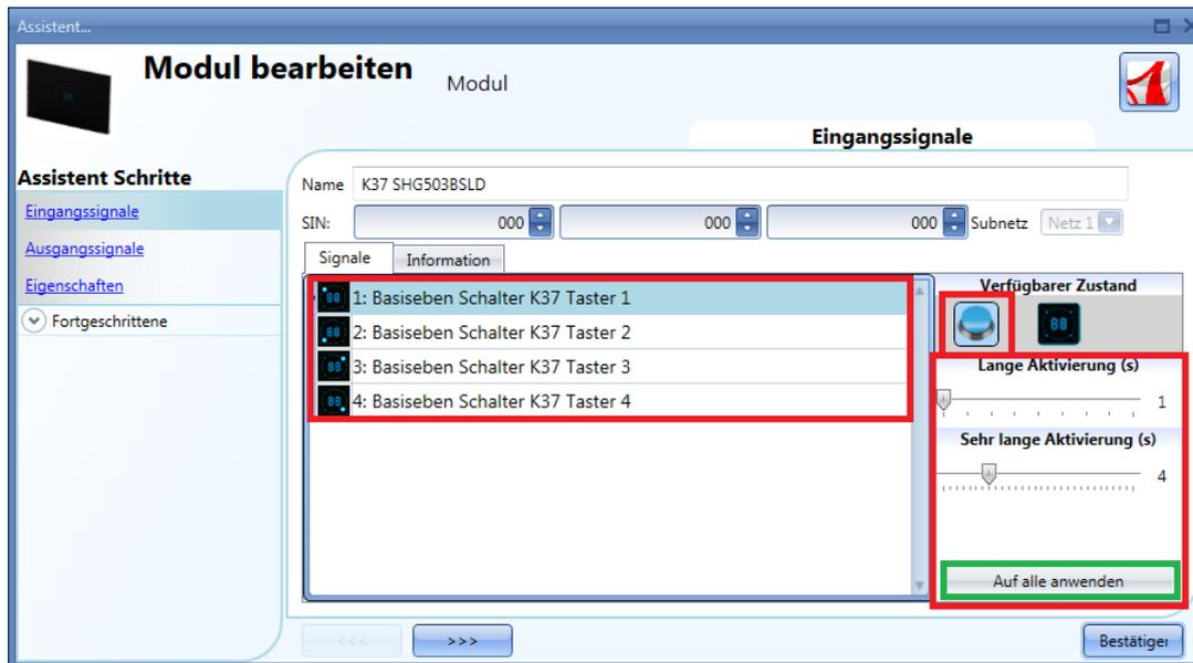
Im Fenster „Eingangssignale“ können Sie jede Taste jeweils als Taster oder als Dimmschalter („Dimmer Interface“) konfigurieren.
