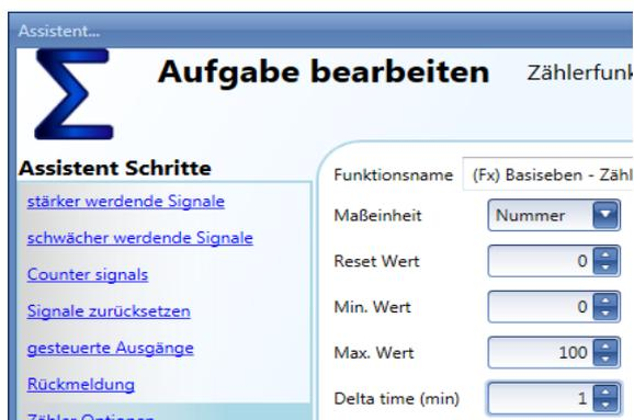
Wenn der Maximalwert der Counting-Funktion 100 und der Minimalwert 0 beträgt, liefert das SHPOUTV224 bei einem virtuellen Ausgangswert von 30 eine Ausgangsspannung von 3 V.
