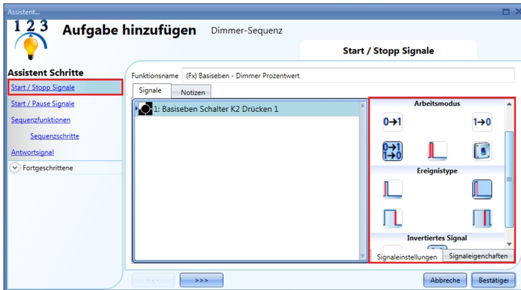
Ob das Eingangssignal die Sequenz startet und/oder stoppt, hängt vom Betriebsmodus des Signals ab.
