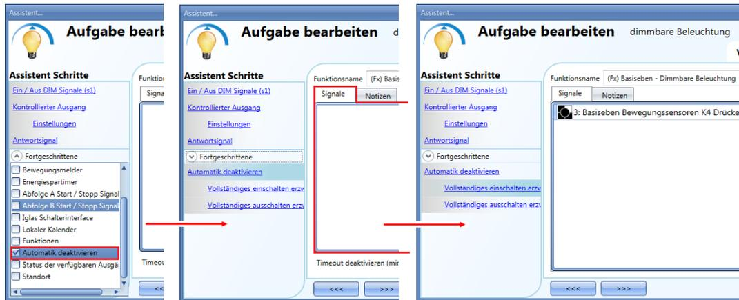
Alle Signale im Fenster „Vollständiges ausschalten erzwingen“ fungieren als Pegelsignale: Solange das Signal aktiv ist, ist die Beleuchtung mit einer Stärke von 100% eingeschaltet. Bei Inaktivität des Signals kehrt die Beleuchtung zum vorherigen Status zurück. Wenn sowohl das „Vollständiges einschalten erzwingen“-Signal als auch das „Vollständiges ausschalten erzwingen“-Signal aktiv sind, hat das „Vollständiges einschalten erzwingen“-Signal Vorrang.
