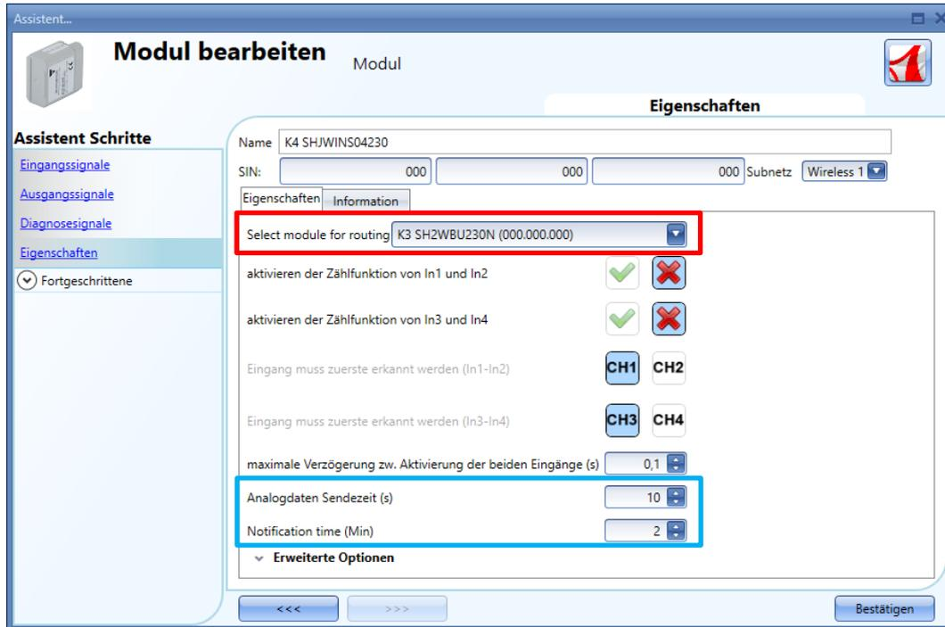
Zur Begrenzung des Datenverkehrs zwischen dem Funkbasisgerät und dem drahtlosen Eingangsmodul kann der Benutzer im Feld *Analogue data sending time (s)* die Periode in Sekunden festlegen, mit der analoge Werte zum Sx-Tool geschickt werden.
