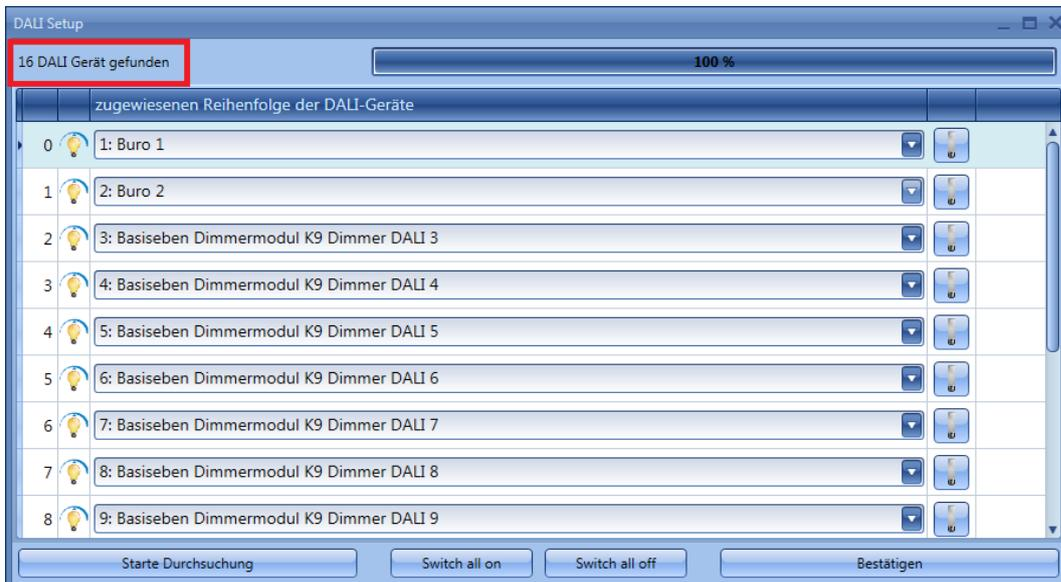
Im folgenden Beispiel wurde ein neues DALI-Vorschaltgerät erkannt und mit der Adresse 16 der Konfiguration hinzugefügt.
