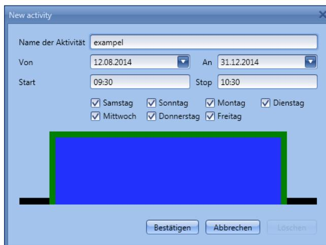
In der nebenstehenden Abbildung dient eine globale Kalenderfunktion dazu, einen der beiden Eingänge einer Multigate-Funktion zu aktivieren. Der andere Eingang wird von einem Taster aktiviert. Das Ausgangssignal der Multigate-Funktion ist nur dann aktiv, wenn beide Eingänge aktiv sind. Das Kalendersignal (Multigate-Eingang 1) wird um 9.30 Uhr ein- und um 10.00 Uhr wieder ausgeschaltet.
