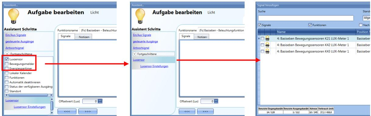
Wenn Sie die Option „Luxsensor“ aktivieren, wird das Standardfenster für das Hinzufügen von Signalen angezeigt. Sie können bis zu zehn Signale hinzufügen. Das System arbeitet dann mit dem Durchschnittswert.
