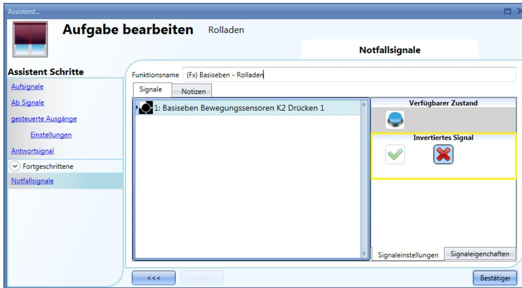
Im folgenden Beispiel wird der Motor in dem Moment gestoppt, wo das Notfallsignal aktiviert wird.
