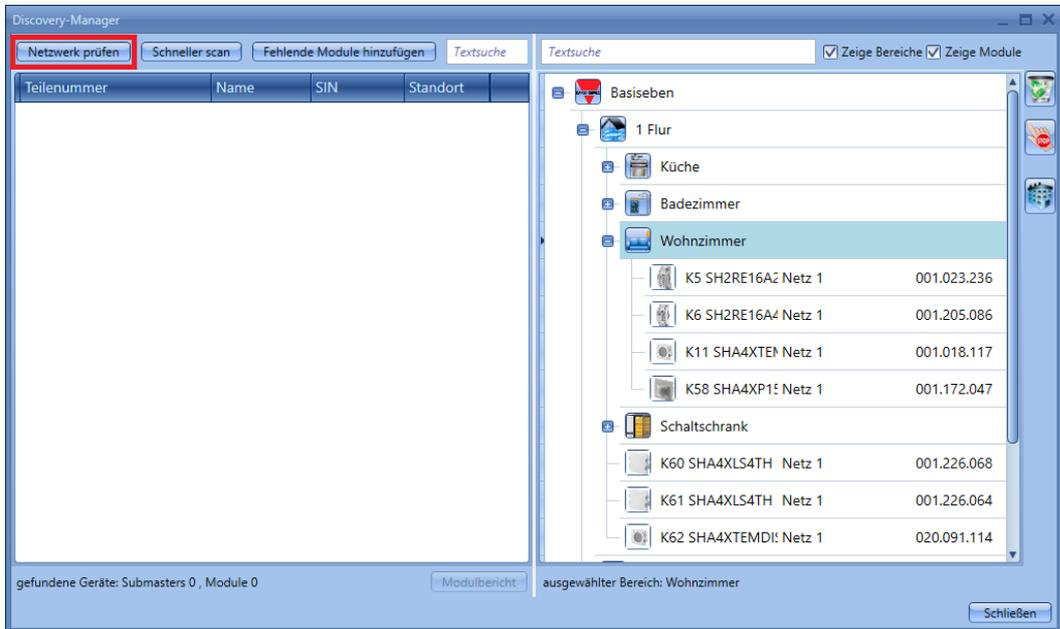
Wenn der Scan beendet ist, zeigt das Sx-Tool die Liste der gefundenen Geräte, gruppiert nach dem Dupline-Netzwerk, mit dem sie verbunden sind. Damit zeigt das System auch, mit welchem Dupline-Generator SH2MCG24 jedes Modul verbunden ist.
