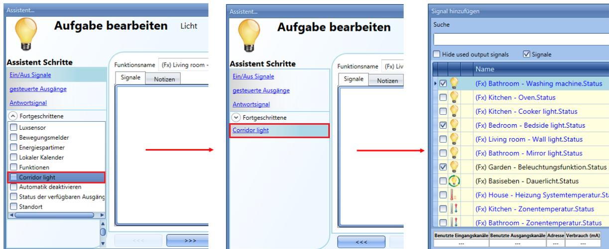
Das Menü „Corridor light“ wird angezeigt. Nach Auswahl dieses Menüs und Doppelklick auf das Fenster „Signals“ (Signale) wird die Liste der verfügbaren Signale angezeigt.
