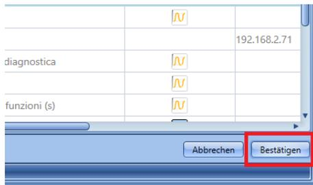
Die ausgewählten Variablen werden im Fenster „Modules“ hinzugefügt, wo sie wie im roten Rahmen unten dargestellt mit der IP-Adresse des Geräts angezeigt werden, zu dem sie gehören.
