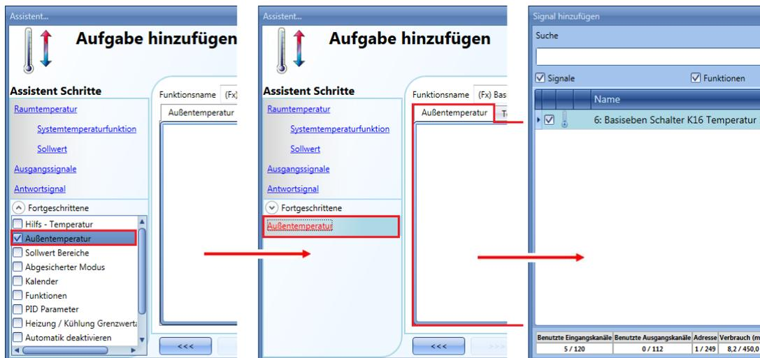
Das Außentemperatursignal wird hinzugefügt, indem Sie im Assistenten für die Zonenfunktion das Kontrollkästchen „Außentemperatur“ aktivieren, dann im Signalfenster einen Doppelklick ausführen und aus der Liste der verfügbaren Eingangssignale das gewünschte Signal auswählen (siehe Abbildung oben).
