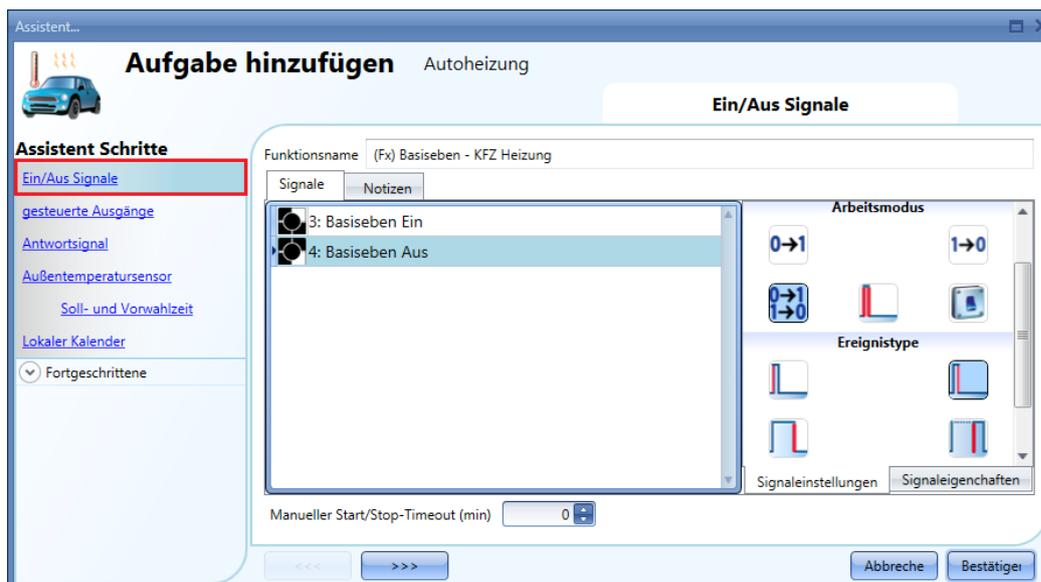
Ob das Eingangssignal die Autoheizung startet und/oder stoppt, hängt vom Betriebsmodus des Signals ab.
