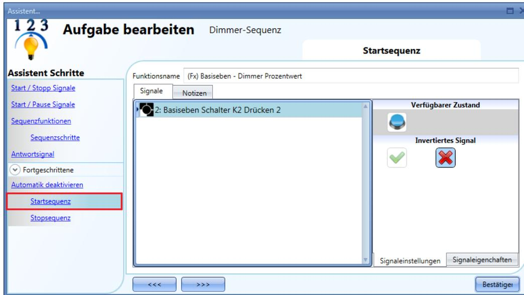
Alle Signale im Fenster „Startsequenz“ fungieren als Pegelsignale: Solange das Signal aktiv ist, wird die Sequenz ausgeführt. Sie kann erst wieder gestoppt werden, wenn das Startsignal verschwindet. Wenn sowohl das „Startsequenz“-Signal als auch das „Stopsequenz“-Signal aktiv sind, hat das „Startsequenz“-Signal Vorrang, d. h. die Funktion bleibt aktiviert.
