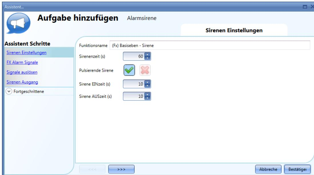
Im Feld „Sirenenzeit (s)“ geben Sie an, wie lange der Sirenenausgang aktiv sein soll, nachdem er von einer Alarmfunktion ausgelöst wurde. Mit der Option „Pulsierende Sirene“ können Sie festlegen, dass die Sirene pulsieren soll. Die Sirene wird dann abwechselnd ein- und ausgeschaltet. Die entsprechenden Intervalle sind über die Felder „Sirene EINzeit (s)“ und „Sirene AUSzeit (s)“ frei wählbar. Bei deaktivierter Option „Pulsierende Sirene“ bleibt die Sirene für die ganze „Sirenenzeit (s)“ EIN.
