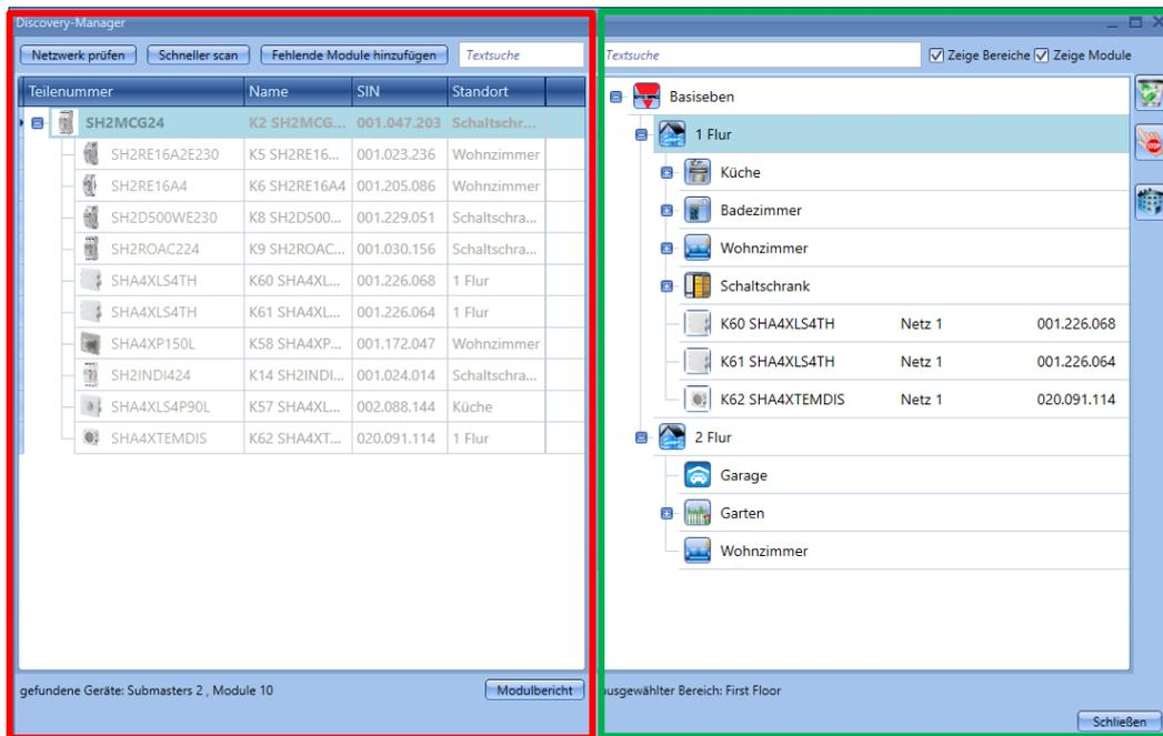
Im linken Teil des Fensters (Rot umrandet) werden alle am Bus angeschlossenen Module angesprochen, nachdem die Taste *Netzwerk prüfen* gedrückt wurde.
