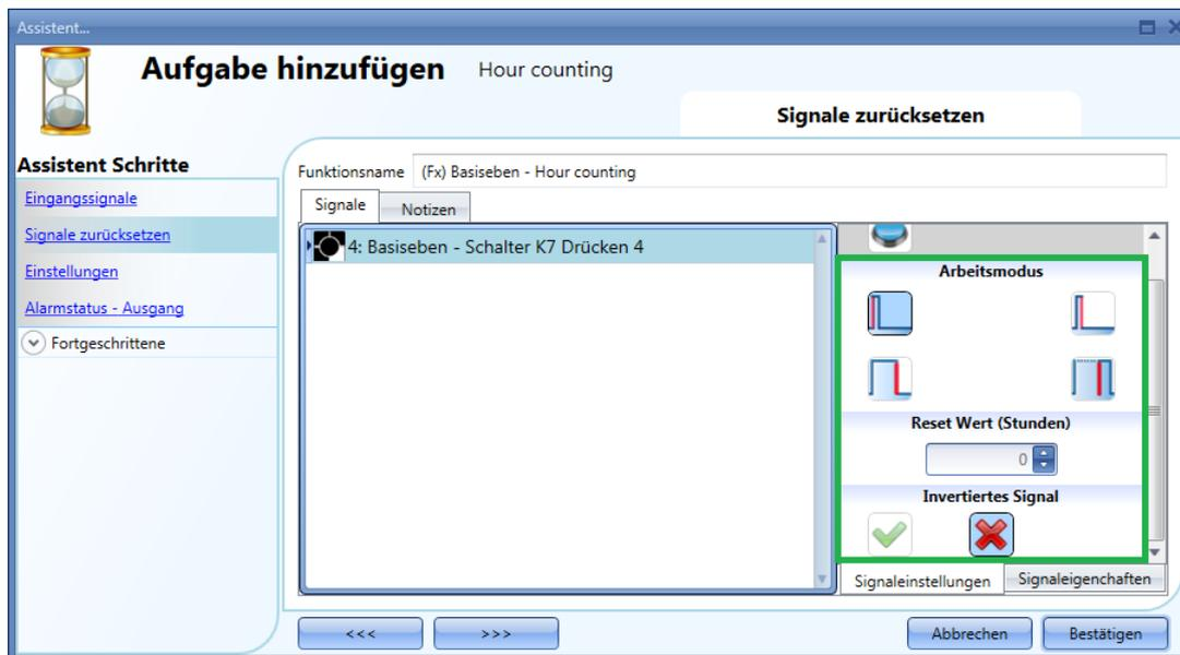
Sie können für jedes Signal einen bestimmten Rücksetzwert festlegen, der beim Auslösen des Rücksetzsignals gesetzt werden soll (d. h., wenn der Taster gedrückt wird): Geben Sie den Wert im Feld „Reset value (hour)“ (Rücksetzwert (Stunden)) ein.
