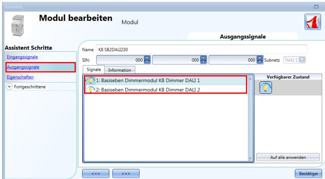
Im Fenster „Ausgangssignale“ werden alle DALI-Dimmer angezeigt, die im Fenster „Eigenschaften“ hinzugefügt wurden.
