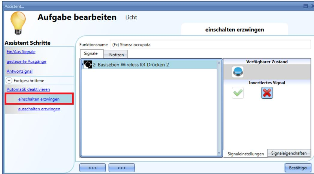
Alle Signale im Fenster „Vollständiges einschalten erzwingen“ fungieren als Pegelsignale: Solange das Signal aktiv ist, ist die Beleuchtungsfunktion eingeschaltet. Wenn sowohl das „Vollständiges einschalten erzwingen“-Signal als auch das „Vollständiges ausschalten erzwingen“-Signal aktiv sind, hat das „Vollständiges einschalten erzwingen“-Signal Vorrang.
