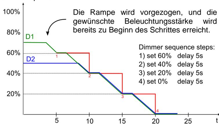
Es wird empfohlen, dass alle Schritte einer Dimmsequenz in dieselbe Richtung (aufwärts/abwärts) weisen.
