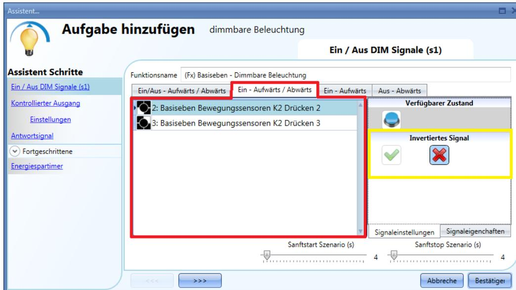
Registerkarte 3: „EIN-AUFWÄRTS“ Eine kurze Betätigung (unter 1 Sekunde) schaltet die Beleuchtung ein. Wenn die Beleuchtung eingeschaltet ist, löst eine Betätigung von mehr als 1 Sekunde ein Aufwärtsdimmen aus, bis das Maximum erreicht ist. Auf der Registerkarte „Signaleinstellungen“ können Sie jedes hinzugefügte Signal auch invertieren (gelber Rahmen).
