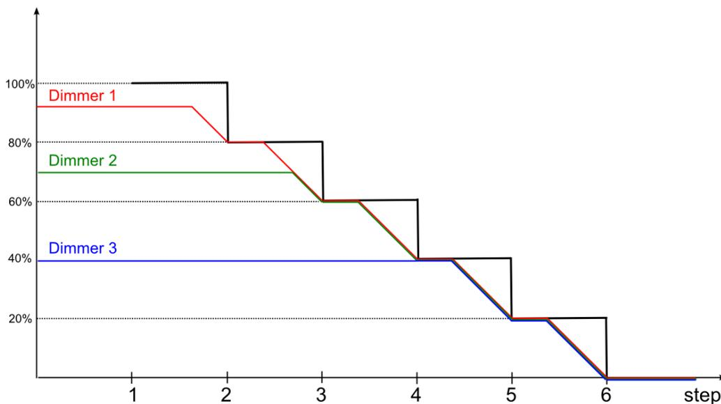
Die folgende Abbildung zeigt ein Einschaltzenario. Die Schritte wurden so konfiguriert, dass alle Dimmer der Sequenz die maximale Beleuchtungsstärke gleichzeitig erreichen.
