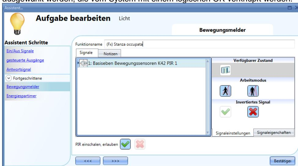
Sie können ein Signal invertieren, indem Sie auf der Registerkarte „Signaleinstellungen“ unter „Invertiertes Signal“ das grüne Häkchen auswählen.
