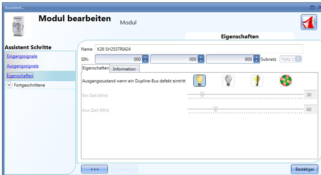
Für die Ausgangsmodule SH2SSTRI424 und SH2RE16A2E230 müssen Sie einen Sicherheitsmodus für den Fall festlegen, dass der Bus fehlerhaft oder nicht verbunden ist.
