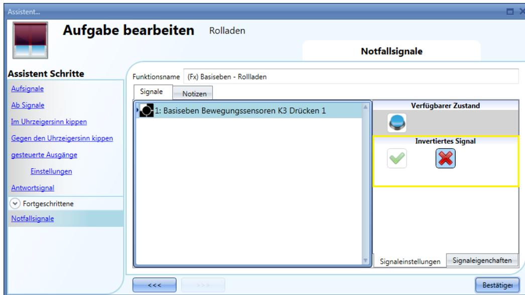
Im folgenden Beispiel wird der Motor in dem Moment gestoppt, wo das Notfallsignal aktiviert wird.
