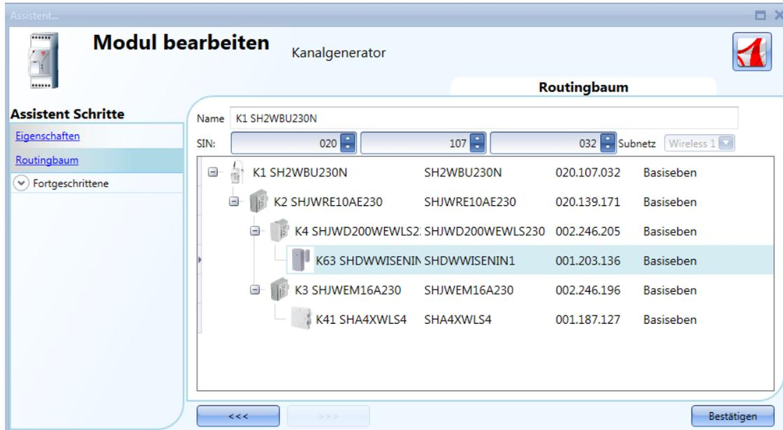
**Hinweis:** Das Zielmodul muss ein drahtloses Grundmodul oder ein drahtloses Modul mit Routing-Fähigkeit sein. Wenn ein Drag-and-Drop-Vorgang mit einem unzulässigen Repeater-Modul ausgeführt wird, wird das in der QuickInfo angezeigte Feld „Target“ rot hervorgehoben. Im Beispiel unten kann das Modul SHA4XWLS4 nicht als Routermodul für den SHDWWISENIN1 verwendet werden, da es keine Routing-Fähigkeit besitzt.
