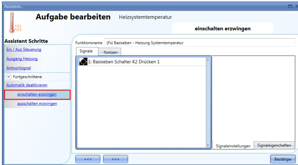
Alle Signale im Fenster „Force output on“ fungieren als Pegelsignale: Solange das Signal aktiv ist, bleibt der Ausgang eingeschaltet. Wenn sowohl das „Force output on“-Signal als auch das „Force output off“-Signal aktiv sind, hat das „Force output on“-Signal Vorrang.
