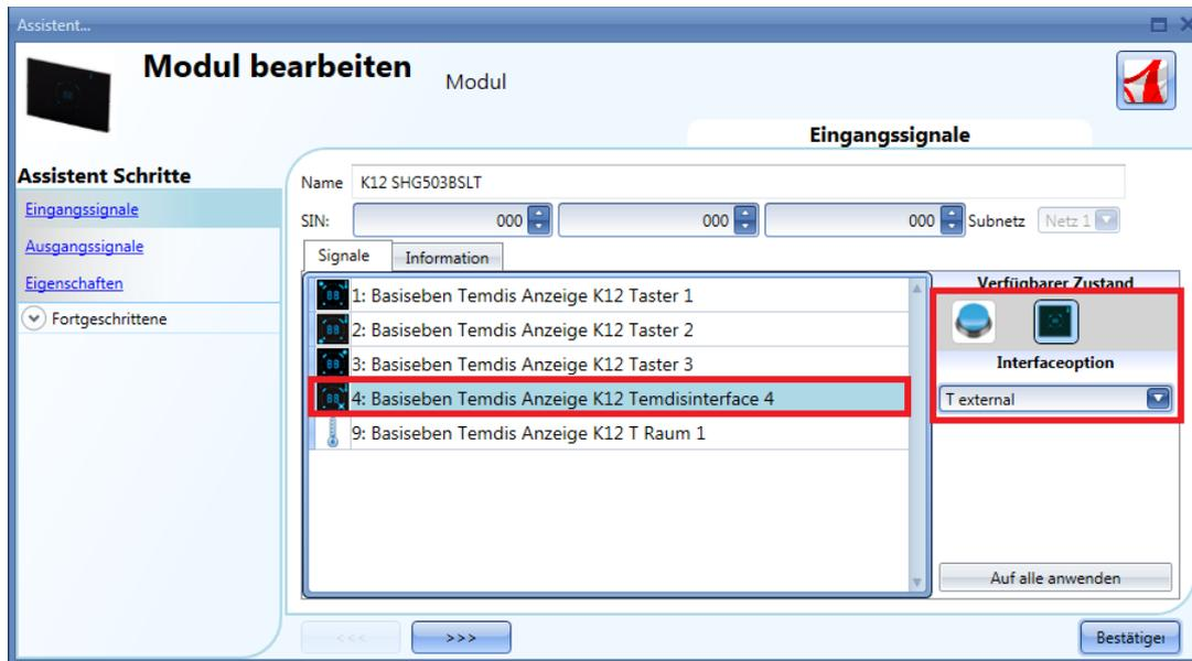
Um ein Anzeigen der Außentemperatur zu ermöglichen, müssen Sie eine Taste als Temdis-Interface konfigurieren und dann „T external“ (Außentemperatur) als „Glass switch working mode“ festlegen.
