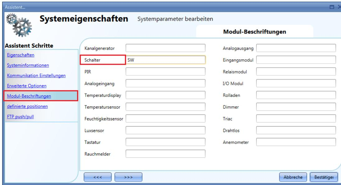
Jedem neu hinzugefügten Schaltermodul wird zusätzlich zu diesem Kennzeichen eine Zahl vorangestellt, die jedes Mal um 1 erhöht wird. Somit lautet die vorangestellte Zeichenfolge beim ersten Schaltermodul „SW1“, beim zweiten „SW2“ usw. (siehe Abbildung unten).
