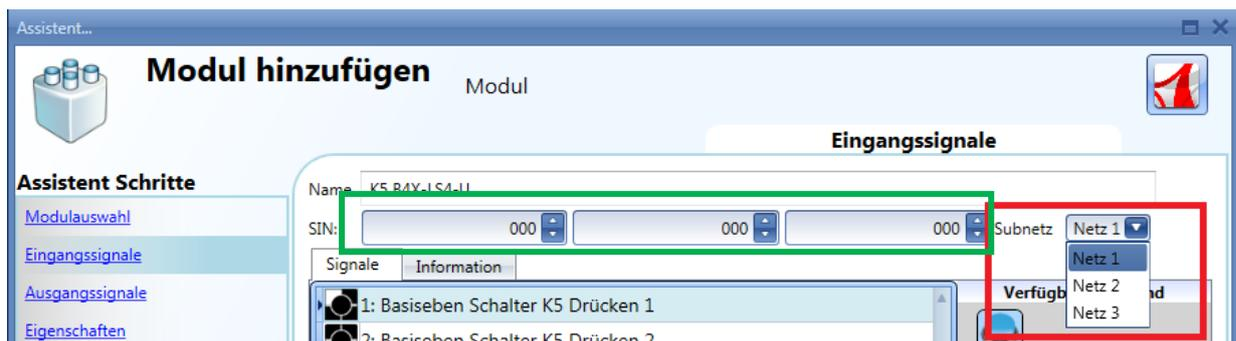
Wenn für ein Modul ein falsches Subnetz eingegeben wurde, z. B. *Net 1* anstelle von *Net 2*, können Sie auf das entsprechende Bild im Fenster „Modules“ klicken und das Subnetz im Feld „Subnetz“ des Fensters „Edit module“ ändern, wie in der Abbildung unten dargestellt.
