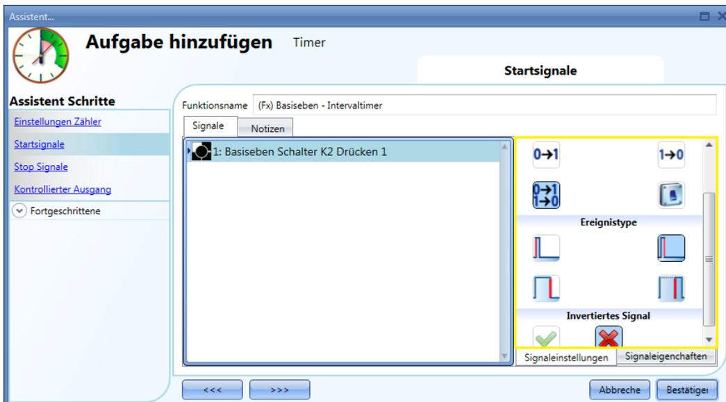
Die Aktivierung des Ausgangs hängt vom Betriebsmodus des Startsignals ab. Beispiel: Wenn Sie für ein Startsignal den Betriebsmodus „Einschalt - Ereignis“ (0 > 1) wählen, startet der Timer bei einer Aktivierung des Signals bereits mit der ansteigenden Flanke. Wenn Sie den Betriebsmodus „Ausschalt - Ereignis“ (1 > 0) wählen, startet der Timer erst mit der fallenden Flanke.
