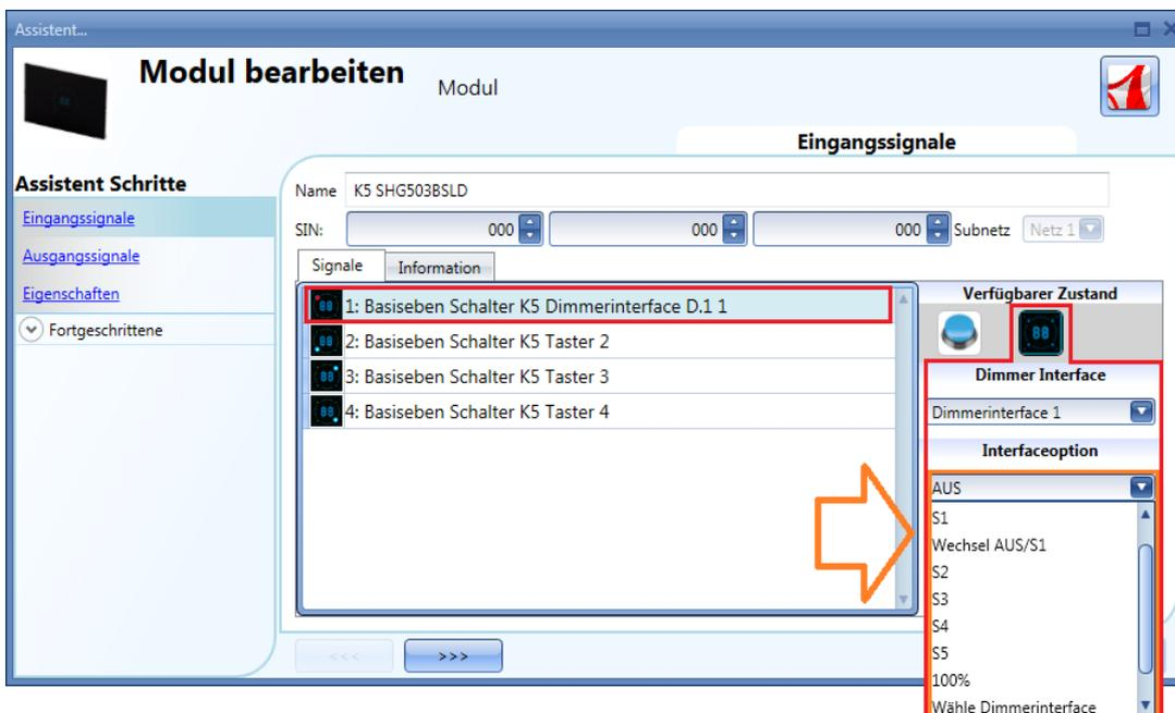
Jede der vier Tasten des Moduls kann frei einem Dimmer-Interface und dort wiederum einer Dimmfunktion zugeordnet werden. Es ist auch möglich, mehrere Tasten demselben Dimmer-Interface und auch derselben Dimmfunktion zuzuordnen.
