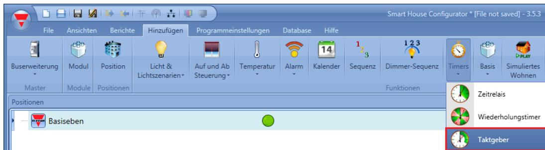
Beim Intervall-Timer aktiviert das Startsignal den Ausgang für eine konfigurierbare Intervallzeit. Der Ausgang des Timers wird bei folgenden Ereignissen aktiviert:
