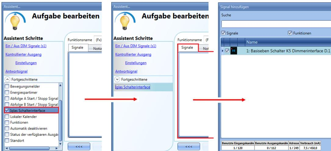
Um eine als Dimmschalter programmierte Taste in einer Funktion „Dimmbare Beleuchtung“ zu verwenden, aktivieren Sie im Fenster „Fortgeschrittene“ die Option „Glasschalter“, führen einen Doppelklick auf „Signale“ aus und wählen das gewünschte Dimmer-Interface aus.
