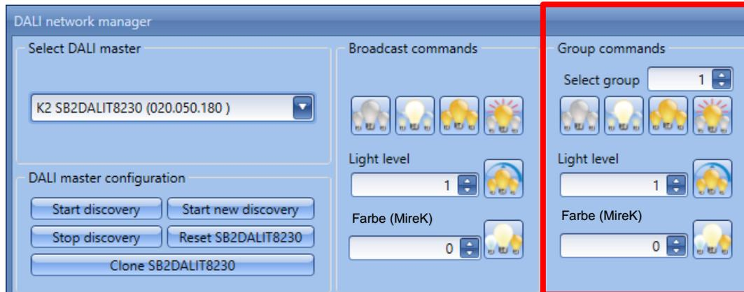
Zum Testen der Vorschaltgeräte in einer spezifischen DALI-Gruppe muss der Benutzer die Gruppennummer (von 1 bis 16) in das Textfeld *Select group* eingeben und auf eine der verfügbaren Befehlstasten drücken.
