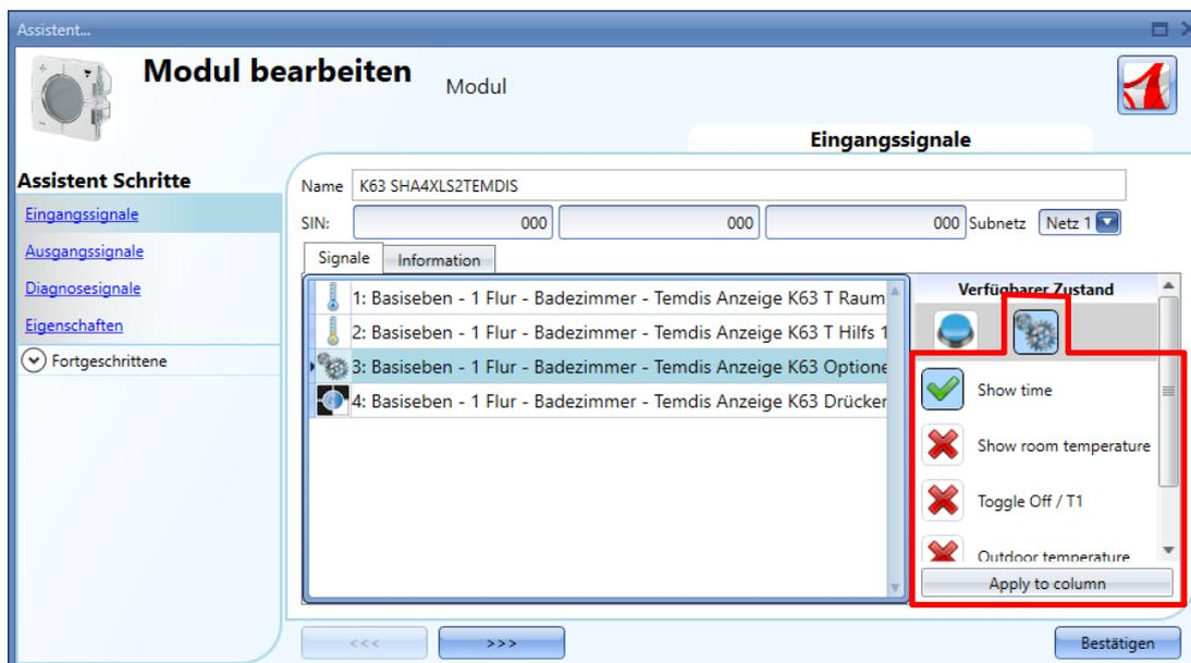
Mithilfe der Liste *Verfügbare Zustand* kann der Benutzer der Taste die benötigte Funktion zuweisen:
