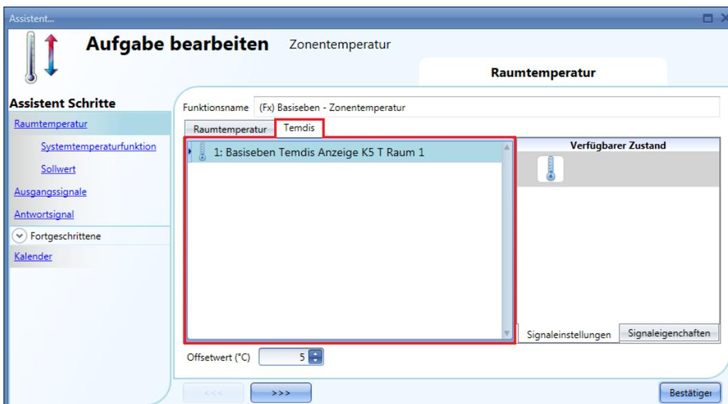
Wenn mehrere Temperaturwerte verwendet werden, wird für die Steuerung der Durchschnitt aller hinzugefügten Signale zugrunde gelegt (Raumtemperatursignale und Temdis- und/oder Glass switch -Temperatursignale). Der vom TEMDIS-Modul angezeigte Wert ist die Summe aus diesem Durchschnittswert und dem konfigurierten Offset-Wert.
