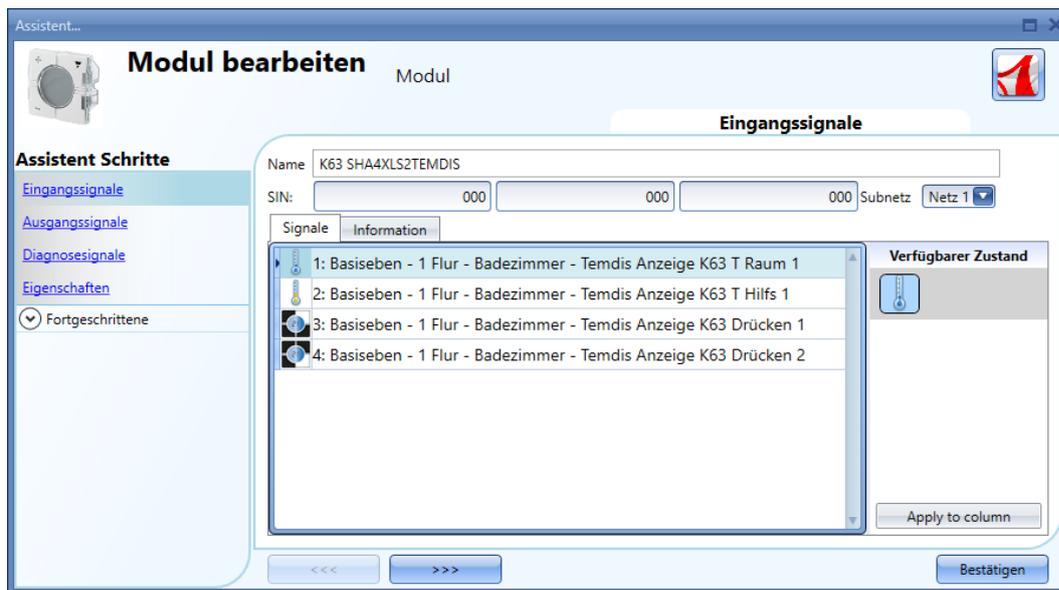
Im Feld *Eingangssignale* können die Temperatursensoren wie z.B. das *TRaum1*-Signal und das optionale *THilfs1*-Signal in jeder Temperaturfunktion verwandt werden.
