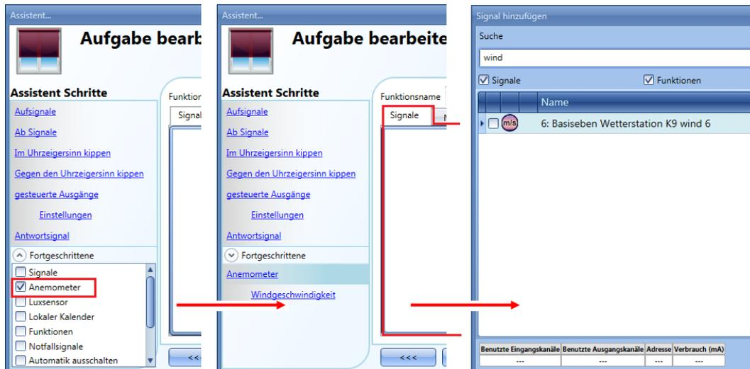
Klicken Sie anschließend auf „Windgeschwindigkeit“, um den Windgeschwindigkeitssensor zu konfigurieren. Das folgende Dialogfeld wird angezeigt:
