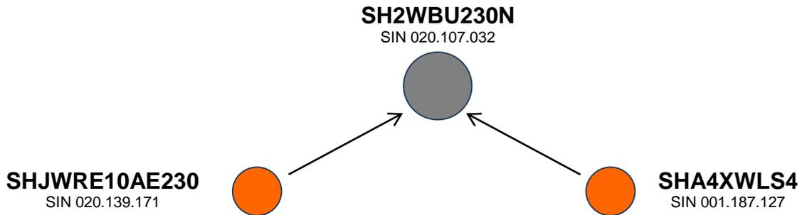
Die folgende Abbildung zeigt, welche Einstellungen Sie im Fenster „Properties“ der beiden Module vornehmen müssen, um sie direkt mit dem drahtlosen Grundmodul zu verbinden. Entscheidend ist, dass Sie jeweils das drahtlose Grundmodul als „Module for routing“ konfigurieren.
