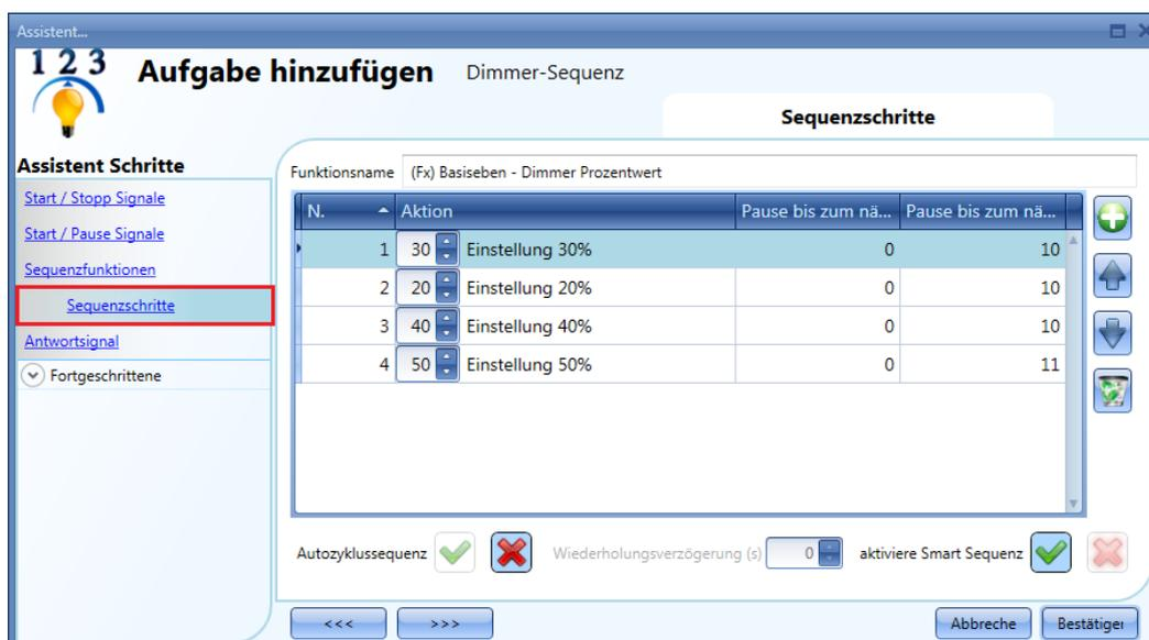
„Autozyklussequenz“: Bewirkt eine kontinuierliche Wiederholung der Sequenz. Nach Ausführung der letzten Funktion startet die Sequenz erneut von vorne. Alle Funktionen werden in einer Schleife ausgeführt, die nur mit einem Stoppsignal gestoppt werden kann.
