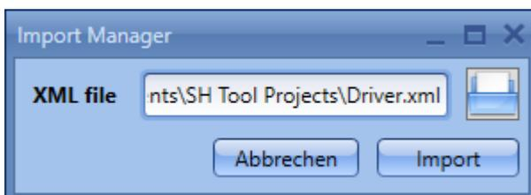
Der Treiber wird der Moduldatenbank des Sx-Tools hinzugefügt und steht anschließend im Fenster „Add module“ zur Verfügung.
