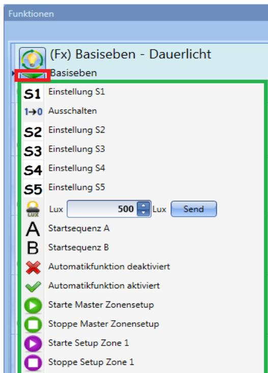
Sie können ein Konstantlichtszenario auswählen, um die Beleuchtungsstärke in der Hauptzone festzulegen: die dimmbaren Lampen der Hauptzone werden eingeschaltet.
