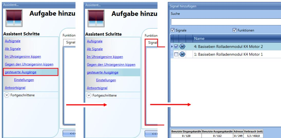
Im Fenster „Signal hinzufügen“ werden nur Ausgänge vom Typ „Motor“ angezeigt. Es können bis zu 10 Motorausgänge ausgewählt werden, die alle parallel verarbeitet werden.
