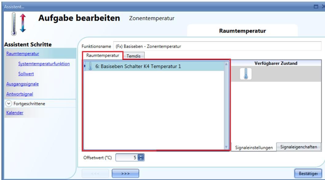
Im Signalfenster „Temdis und Glass switch“ können Sie die beiden Temperatursignale der Temdis- und Glass switch -Module (TRoom und TAuxiliary) hinzufügen.
