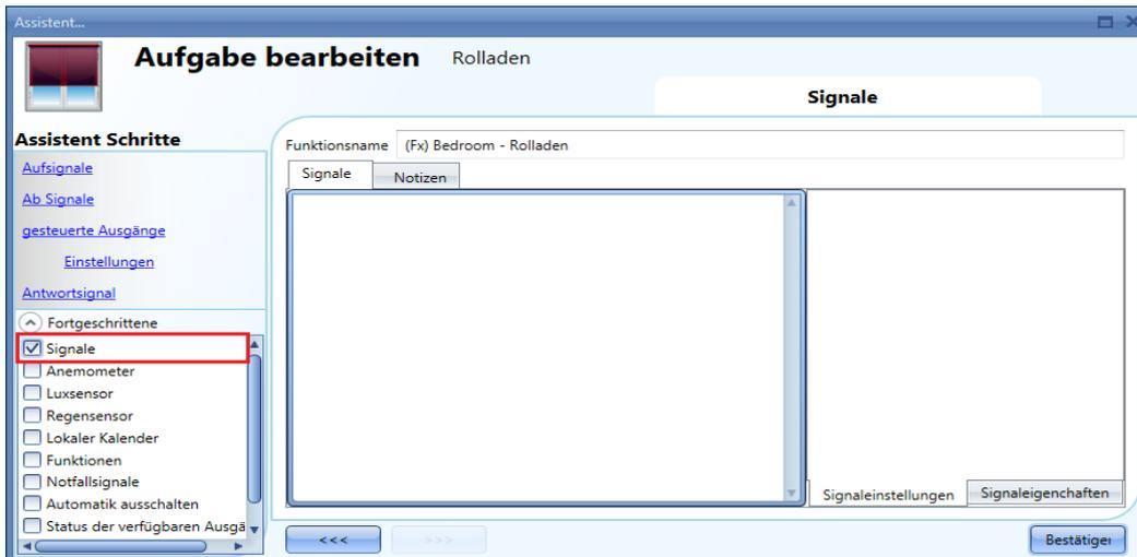
Wählen Sie dazu im Bereich „Fortgeschrittene“ die Option „Signale“, führen Sie im zugehörigen Signalfenster einen Doppelklick aus, und wählen Sie aus der Liste das gewünschte Eingangssignal (Taster) aus.
