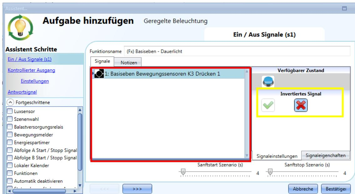
Beim ersten Einschalten der Beleuchtung wird der Ausgang auf 50% des unter „Kontrollierter Ausgang“ > „Einstellungen“ gewählten Beleuchtungsstärken-Skalenendwerts eingestellt. Dann wird das zuletzt festgelegte Niveau in Szenario S1 gespeichert. Der Benutzer kann die Beleuchtungsstärke mit anderen Szenarios ändern. Das zuletzt festgelegte Niveau wird in Szenario S1 gespeichert.
