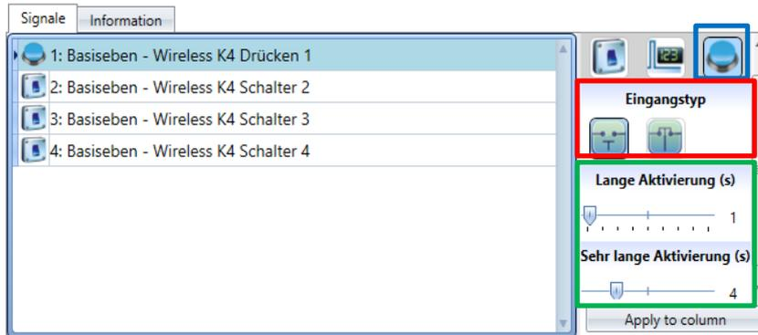
Der Benutzer kann verschiedene Zeiten für jede Drucktaste einstellen oder durch Klicken auf die Taste *Apply to column* alle auf dieselben Werte setzen.
