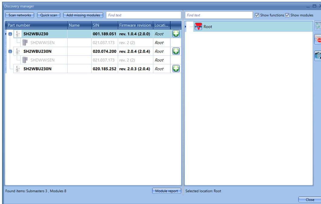
Wenn mehrere drahtlose Basisgeräte installiert sind, zeigt das Sx-Tool alle gefundenen Module für jedes Netzwerk an. Wenn zwei oder mehr SH2WBU230N-Geräte denselben Bereich abdecken, finden sie möglicherweise dieselben Module: Es fällt dann dem Installateur zu, die nie-programmierten Module dem gewünschten SH2WBU230N zuzuordnen.
