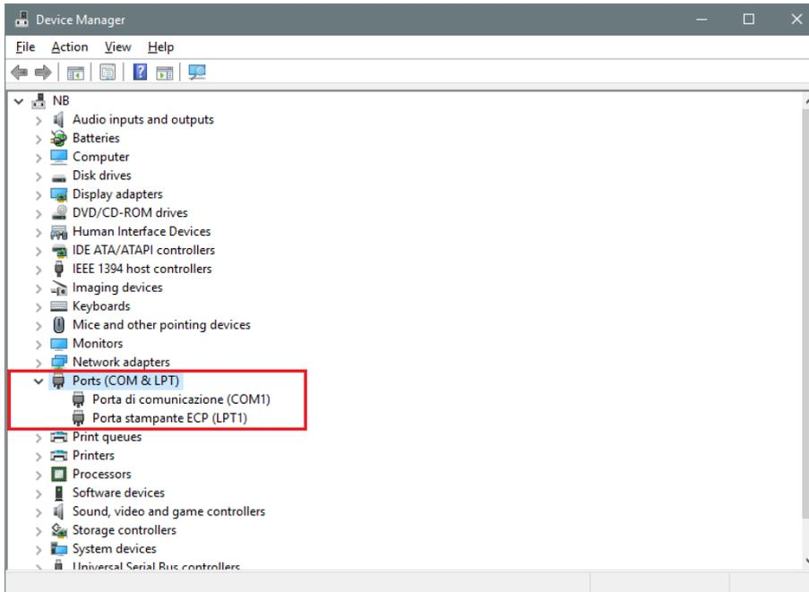
4. Verbinden Sie das Mini-USB-Kabel mit dem Computer und mit dem Sx2WEB24-Controller. Nach einigen Sekunden wird automatisch ein neuer Kommunikationsanschluss (COMx) hinzugefügt. Im Beispiel unten wurde der neue Anschluss **COM4** hinzugefügt.
