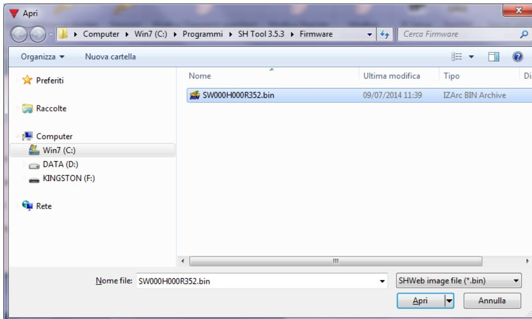
Wählen Sie die Datei aus. Der Sx2WEB24 wird automatisch aktualisiert und anschließend neu gestartet.
