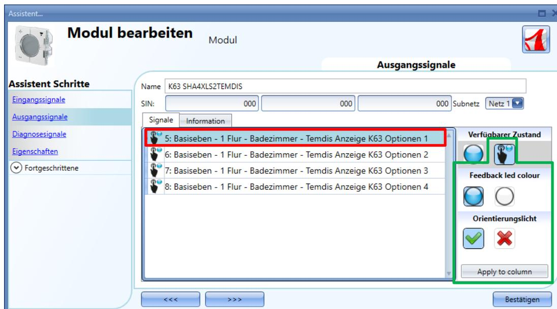
Im Feld *Feedback led colour* kann der Benutzer die Farbe der LED für den Feedback nach einem Tastendruck festlegen:
