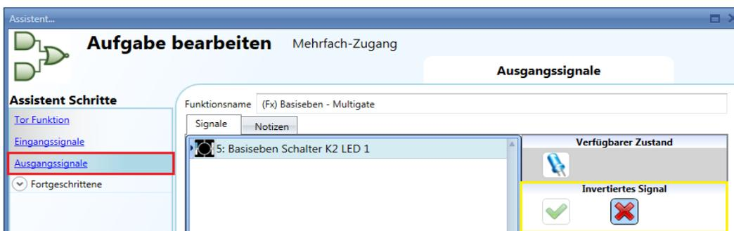
Wenn beide Beleuchtungen EIN sind, ist die Multigate-Funktion aktiv, und der LED-Ausgang ist EIN.
