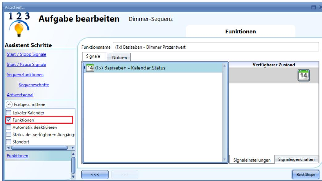
Die Sequenz wird dann gemäß dem Status der hinzugefügten Funktionen aktiviert und deaktiviert. Wenn Sie z. B. eine Beleuchtungsfunktion hinzufügen, würde das Einschalten des Lichts die Sequenz starten und das Ausschalten des Lichts die Sequenz stoppen.
