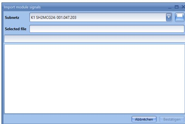
In diesem Fenster wählt der Benutzer in der **Subnetz**-Liste das Subnetz aus, welchem die Module hinzugefügt werden sollen: Zulässig ist **ausschließlich der SH2MCG24** Master Channel Generator. Mit einer Datei können nur Module spezifiziert werden, die an dasselbe Netz angeschlossen sind. Zur Verwaltung mehrerer Subnetze muss für jedes Subnetz im Projekt eine eigene Vorlagendatei erstellt werden.
