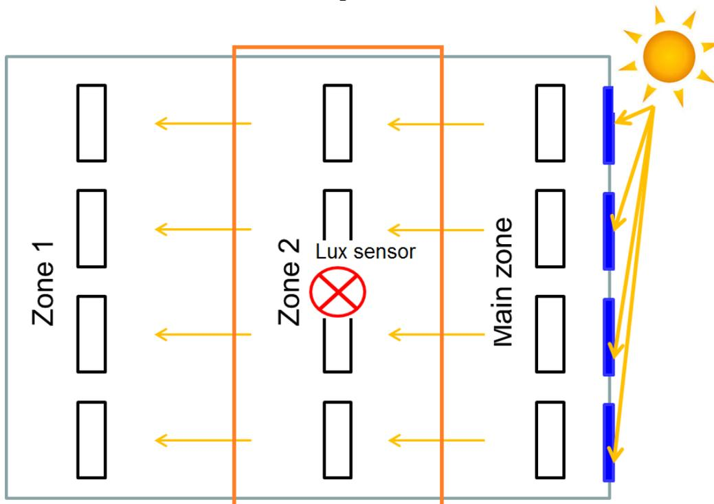
Die dritte Zone wird auf die gleiche Weise wie *Zone 1* als zusätzliche untergeordnete Zone konfiguriert. In der Haupt-Konstantlichtfunktion müssen Sie im Bereich „Advanced“ untergeordnete Zonen („Slave zones“) hinzufügen und dann in der Liste die Dimmermodule für *Zone 2* auswählen. Anschließend können Sie durch einen Doppelklick im Feld „Signals“ einen oder mehrere Ausgänge hinzufügen, welche die Gruppe „Zone 2“ bilden sollen.
