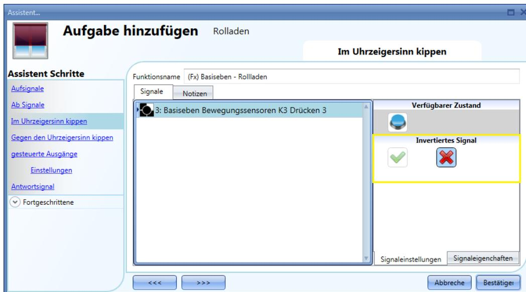
Die Signale der Bereiche „Im Uhrzeigersinn kippen“ und „Gegen den Uhrzeigersinn kippen“ arbeiten jeweils parallel (OR-Verknüpfung).
