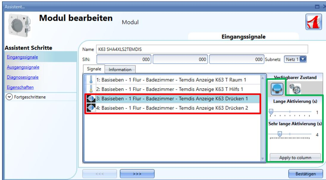
Der Benutzer kann verschiedene Zeiten für jede Drucktaste einstellen oder durch Klicken auf die Taste *Auf alle anwenden* alle auf dieselben Werte setzen.
