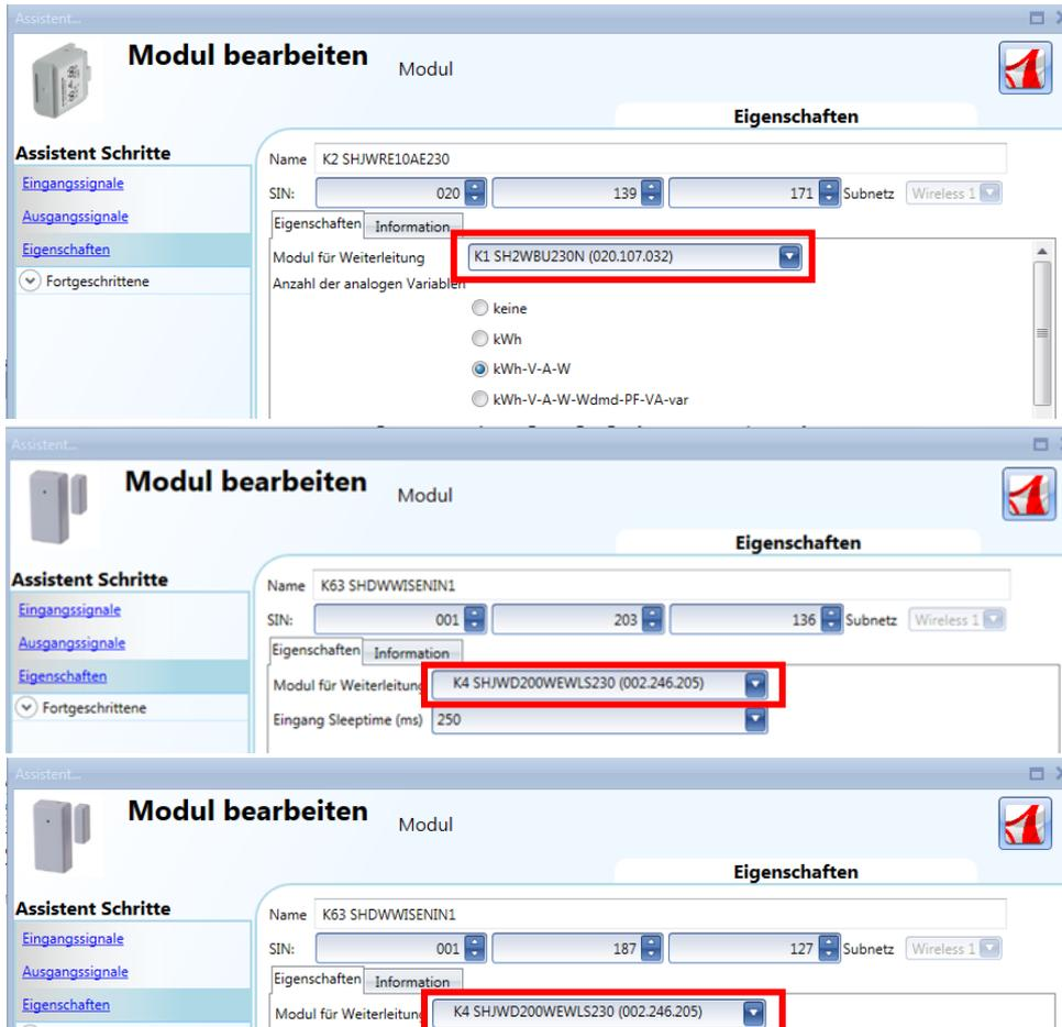
Die Abbildung unten zeigt ebenfalls das obige Beispiel einer indirekten Verbindung, bei der ein drahtloses Relaismodul als Router verwendet wird.
