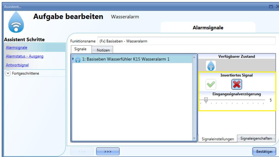
Den Alarmausgang fügen Sie hinzu, indem Sie auf „Alarmstatus - Ausgang“ klicken, im Signalfenster einen Doppelklick ausführen und aus der Liste der verfügbaren Signale das gewünschte Signal auswählen (siehe Abbildung unten). Bei den Ausgangssignalen kann es sich um ein Relais, eine LED oder einen Summer handeln. Das Ausgangssignal ist so lange aktiv, wie der Wassersensor Wasser erkennt.
