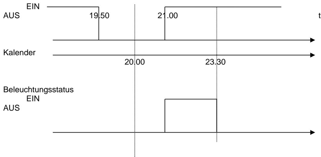
Das für 20.00 Uhr vorgesehene Ereignis wird um 21.00 Uhr nachträglich verarbeitet. Generell gilt: Wenn in einer Phase, in der das Licht durch den Kalender eingeschaltet ist, der Strom ausfällt und dann wieder verfügbar ist, so wird das Licht für den Rest der Phase wieder eingeschaltet.
