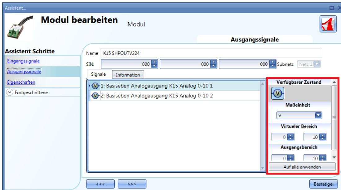
Beim SHPOUTV224 handelt es sich um ein Multifunktions-Ausgangsmodul mit zwei Ausgängen 0 bis 10 V. Der Ausgang kann in viele verschiedene Maßeinheiten umgerechnet werden.
