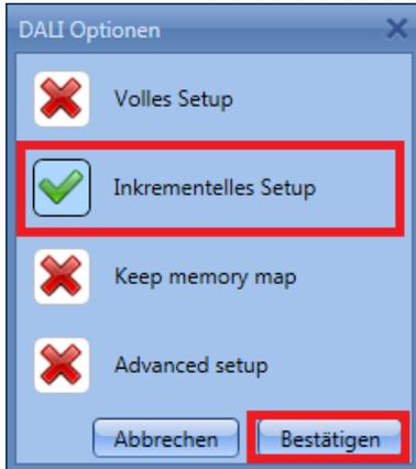
Diese Funktion führt einen neuen Netzwerkscan durch, wobei bereits konfigurierte Vorschaltgeräte unverändert belassen werden.
