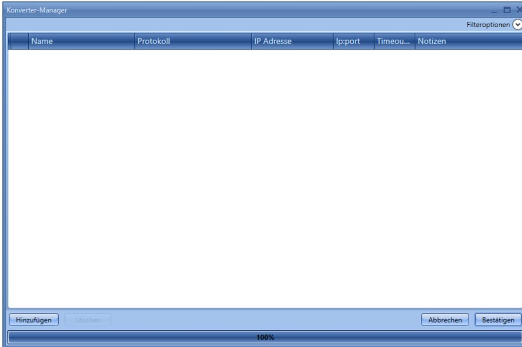
Um ein Modbus-Konvertermodul zu konfigurieren, klicken Sie auf „Add“, und geben Sie dann die benötigten Einstellungen ein:
