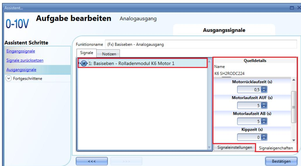
Hinweis: Sie müssen unter „Up running motor time“ die Motor-Aufwärtslaufzeit und unter „Down running motor time“ die Motor-Abwärtslaufzeit für den Rücksetzbefehl festlegen: ein eventuell für die „Tilting time“ (Kippdauer) festgelegter Wert wird nicht verwendet.
