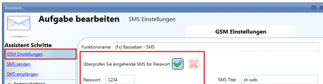
Für den Fall, dass Sie bei der GSM-Konfiguration ein Kennwort (z. B. 1234) festgelegt haben, ist folgender Nachrichtentext erforderlich: „1234,Light on“
