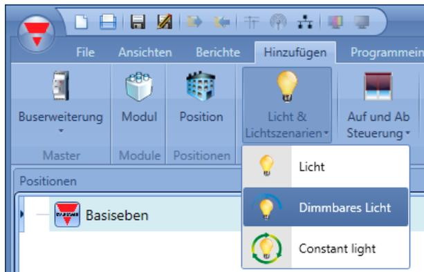
Diese Funktion steuert einen oder mehrere Dimmorausgänge anhand eines oder mehrerer Eingangsbefehle. Der Eingangsbefehl kann ein reales Signal (z. B. ein Taster), eine Funktion oder ein Remote-Befehl (Webserver, E-Mail, SMS oder Modbus) sein.
