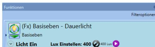
Es empfiehlt sich, die in der untergeordneten Zone 1 herrschende Beleuchtungsstärke mithilfe eines tragbaren Luxmeters zu messen und dann mit der Anpassung des prozentualen Dimmerniveaus zu beginnen, um die geforderte Beleuchtungsstärke zu erreichen.
