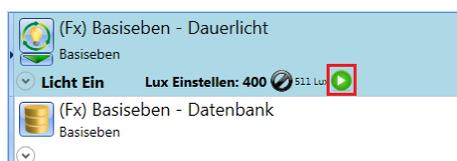
Es empfiehlt sich, die in der Hauptzone herrschende Beleuchtungsstärke mithilfe eines tragbaren Luxmeters zu messen, wenn die vom Sensor gemessene Beleuchtungsstärke näher am Sollwert liegt und der Dimmerausgang einen konstanten Wert erreicht hat. Anschließend kann der Offset-Wert für den Helligkeitswert angepasst werden.
