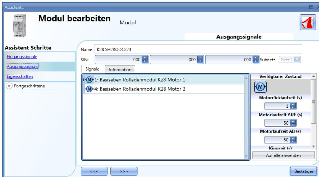
Bei der Konfiguration der Rolladenmodule SH2RODC224 und SH2ROCC224 müssen Sie die „Motorrücklaufzeit“ (Pause, bevor der Motor seine Richtung ändert), die „Motorlaufzeit“ (Zeit zwischen dem vollständig geschlossenen und dem vollständig geöffneten Zustand) sowie die „Kippzeit“ (Zeit für eine 180-Grad-Rotation der Lamellen) festlegen.
