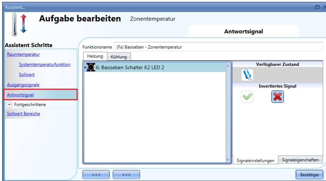
Auf der Registerkarte „Signal settings“ können Sie die Logik des hinzugefügten Signals invertieren.
