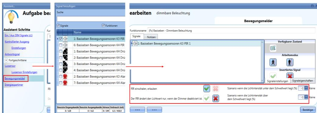
Aktivieren Sie befür das PIR-Signal die Option „PIR einschalten, erlauben“, und legen Sie anschließend zwei Aktionen fest: eine für den Fall, dass die Helligkeit unterhalb des Schwellwerts liegt, und eine für den Fall, dass die Helligkeit oberhalb des Schwellwerts liegt. Unter „Nacht-zustand Szenario“ geben Sie an, welche Aktion bei einem Bewegungssignal ausgeführt werden soll, wenn die Helligkeit unterhalb des Schwellwerts liegt.
