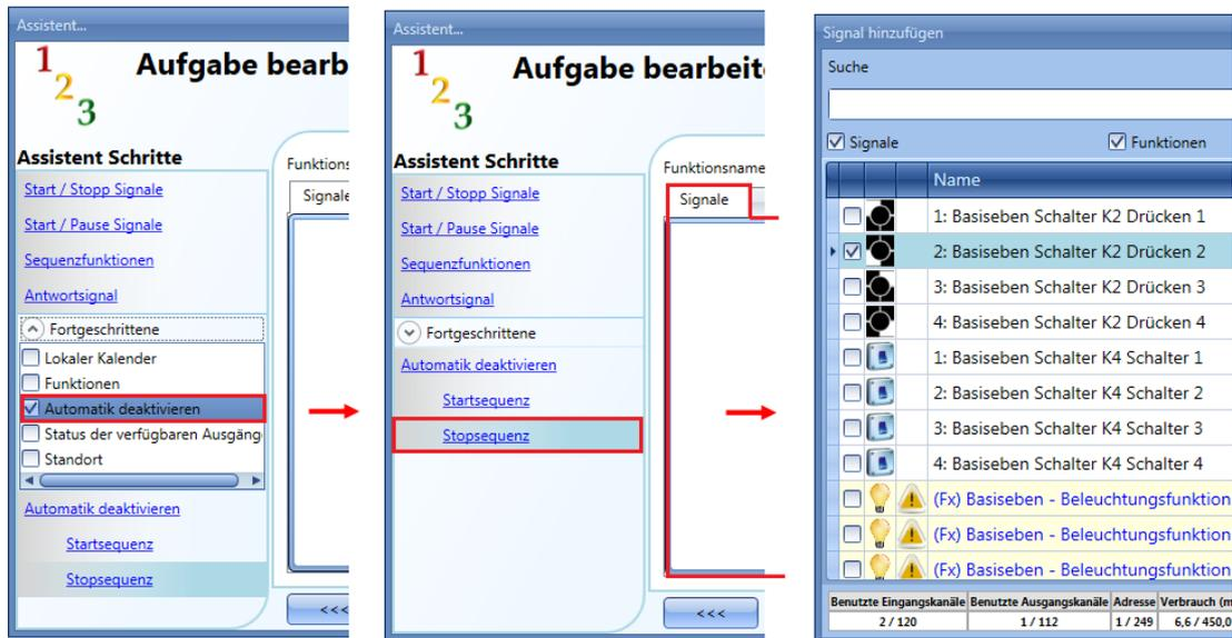
Alle Signale im Fenster „Stopsequenz“ fungieren als Pegelsignale: Solange das Signal aktiv ist, wird die Sequenz gestoppt. Sie kann erst wieder aktiviert werden, wenn das Stoppsignal verschwindet. Wenn sowohl das „Startsequenz“-Signal als auch das „Stopsequenz“-Signal aktiv sind, hat das „Startsequenz“-Signal Vorrang, d. h. die Funktion bleibt aktiviert.
