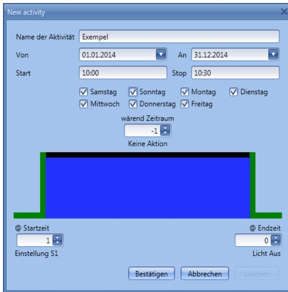
Im zweiten Beispiel ist der Kalender das gesamte Jahr über (vom 1. Januar bis zum 31. Dezember) und an allen Wochentagen (Montag bis Sonntag) aktiv. Zur Startzeit (10.00 Uhr) wird das Licht im Szenario 1 eingeschaltet. Nach Ablauf des Timers wird das Licht ausgeschaltet.
