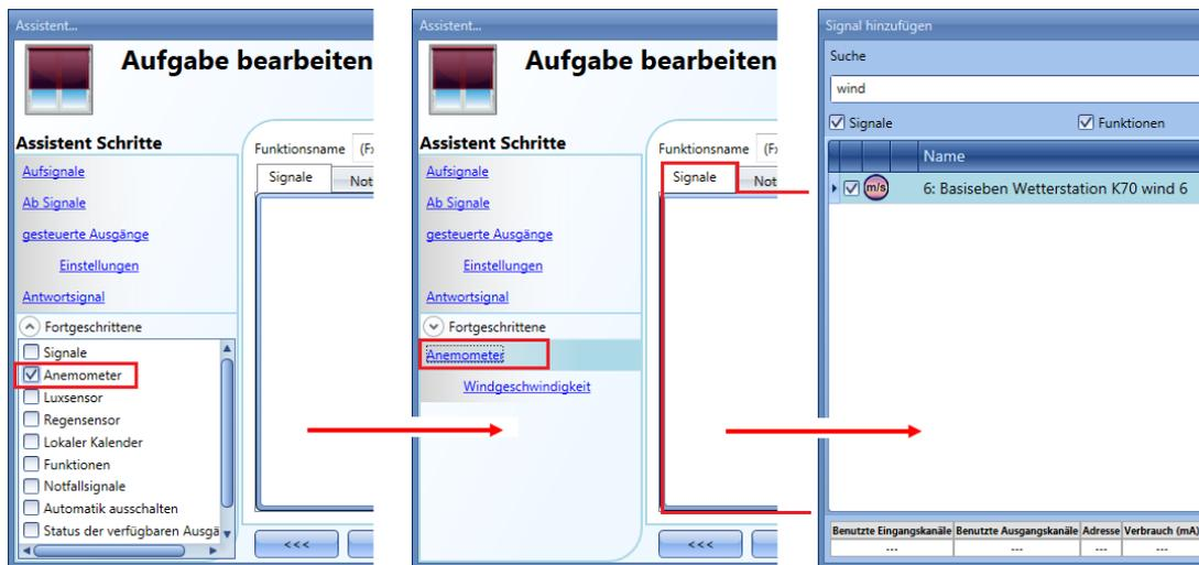
Klicken Sie anschließend auf „Windgeschwindigkeit“, um den Windgeschwindigkeitssensor zu konfigurieren. Das folgende Dialogfeld wird angezeigt:
