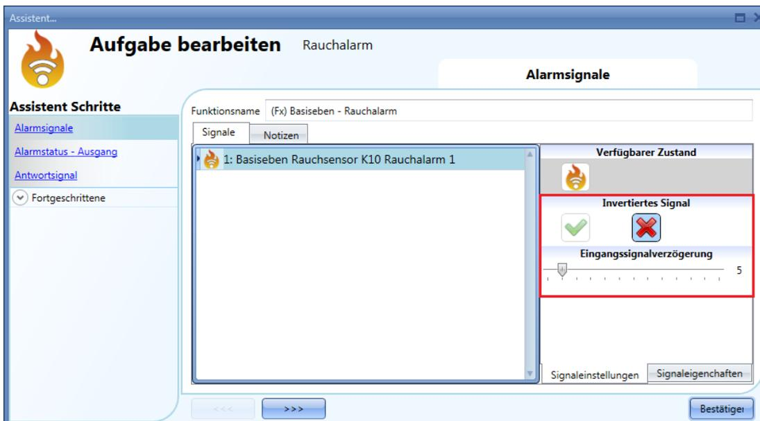
Den Alarmausgang fügen Sie hinzu, indem Sie auf „Alarmstatus - Ausgang“ klicken, im Signalfenster einen Doppelklick ausführen und aus der Liste der verfügbaren Signale das gewünschte Signal auswählen (siehe Abbildung unten). Bei den Ausgangssignalen kann es sich um ein Relais, eine LED oder einen Summer handeln. Das Ausgangssignal ist so lange aktiv, wie der Rauchsensor Rauch erkennt.
