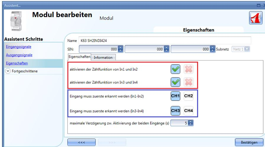
Im Feld „Autocount timeout“ können Sie eine Zeitdauer festlegen, nach deren Überschreiten der Zählerwert nicht mehr geändert wird. Der Zählerwert wird nicht mehr erhöht oder verringert, wenn das Zeitintervall, in dem die gekoppelten Sensoren eine Erkennung melden, die in diesem Feld festgelegte Zeitdauer in Sekunden überschreitet.
