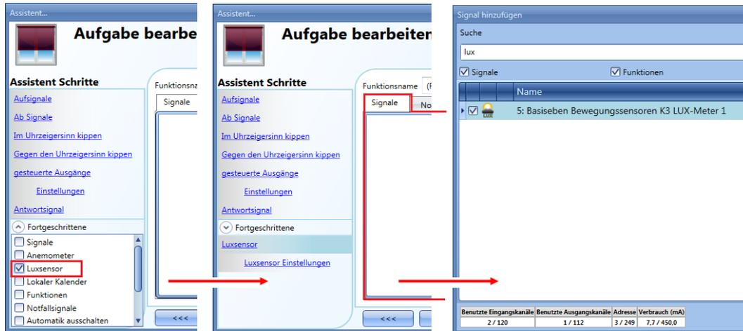
Sie können bis zu 10 Helligkeitssensoren hinzufügen. Wenn mehrere Helligkeitssensoren mit der Funktion verknüpft sind, wird der Durchschnittswert verwendet.
