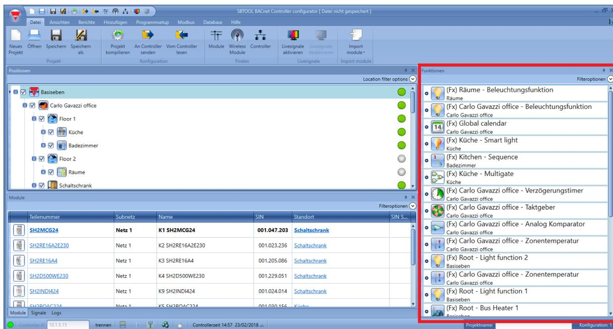
Jede vom Benutzer neu erstellte Funktion wird in diesen Bereich eingereiht. Zum Editieren einer schon vorhandenen Funktion muss der Benutzer auf das Bildsymbol der Funktion klicken, und der Assistent erscheint.
