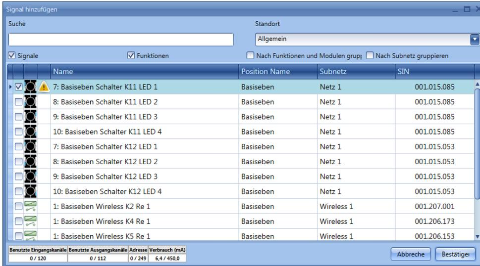
Die in diesem Fenster verfügbaren Signale sind LEDs und Relais. Es können bis zu 50 Signale ausgewählt werden, die alle parallel verarbeitet werden.
