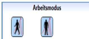
Bei Bewegung wird das Licht eingeschaltet, sofern die Option „PIR einschalen, erlauben“ aktiviert ist. Bei Anwesenheit wird der Energiespar-Timer neu gestartet.
