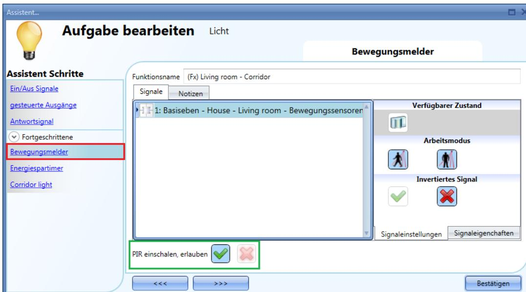
Wenn die Bürobeleuchtung nicht auf PIR basiert, müssen Sie den „Light function output“ (Ausgang der Beleuchtungsfunktion) verwenden, wie im vorherigen Abschnitt beschrieben.
