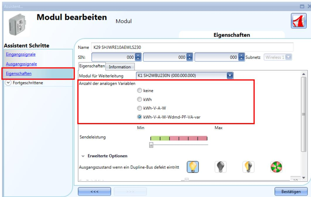
Im Feld „Tx radio power“ können Sie außerdem die Sendeleistung des Moduls einstellen, indem Sie den Schieberegler betätigen. Beim Modul SHDWRE16AE230 steht dieses Feld nicht zur Verfügung. Wenn das Funksignal durch metallische Teile abgeschirmt oder eine höhere Reichweite benötigt wird, können Sie die Stärke des Funksignals erhöhen.
