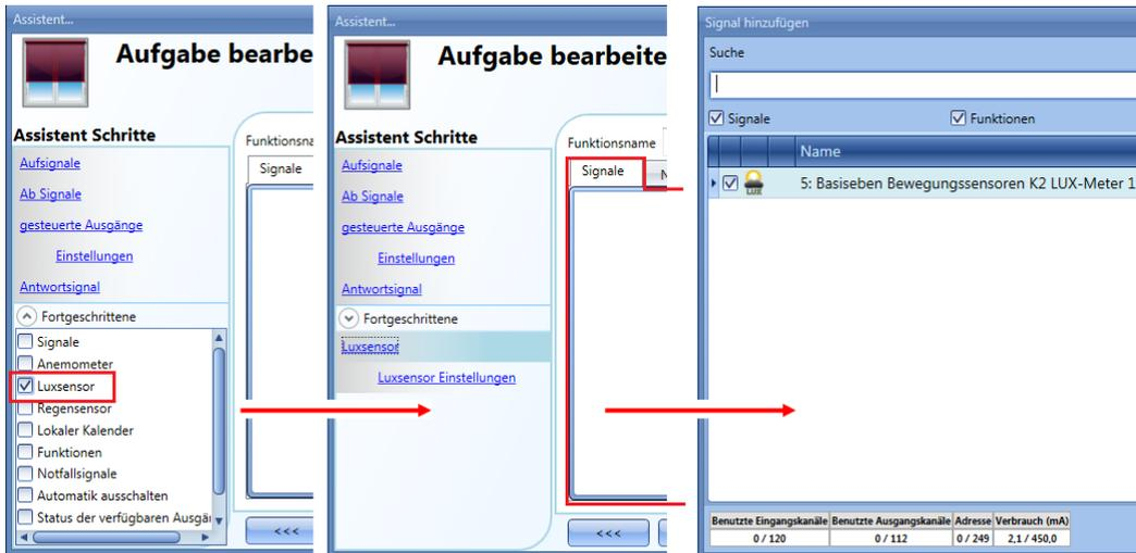
Sie können bis zu 10 Helligkeitssensoren hinzufügen. Wenn mehrere Helligkeitssensoren mit der Funktion verknüpft sind, wird der Durchschnittswert verwendet. Legen Sie anschließend Helligkeitsschwellwerte sowie die Aktionen fest, die der Rollläden jeweils bei Erreichen der Schwellwerte ausführen soll.
