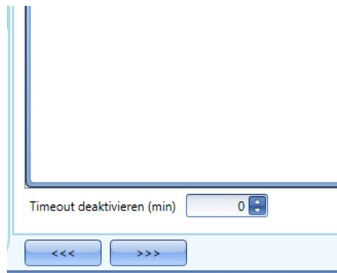
Der Timer startet jedes Mal, wenn der Rücksetzstatus aktiviert wird. Die Funktion wird dann nach Ablauf der festgelegten Zeit automatisch wieder aktiviert.
