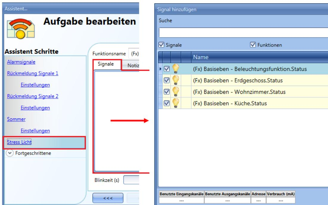
Die Blinkfrequenz wird für alle Beleuchtungsfunktionen einheitlich im Feld „Blinkzeit (s)“ festgelegt (siehe Abbildung unten).
