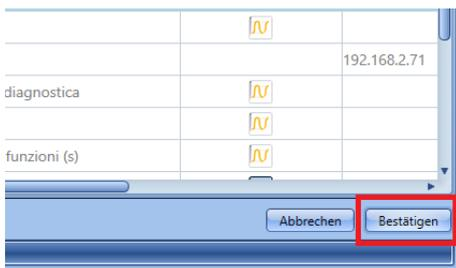
Die ausgewählten Variablen werden im Fenster „Modules“ hinzugefügt, wo sie wie im roten Rahmen unten dargestellt mit der IP-Adresse des Geräts angezeigt werden, zu dem sie gehören.
