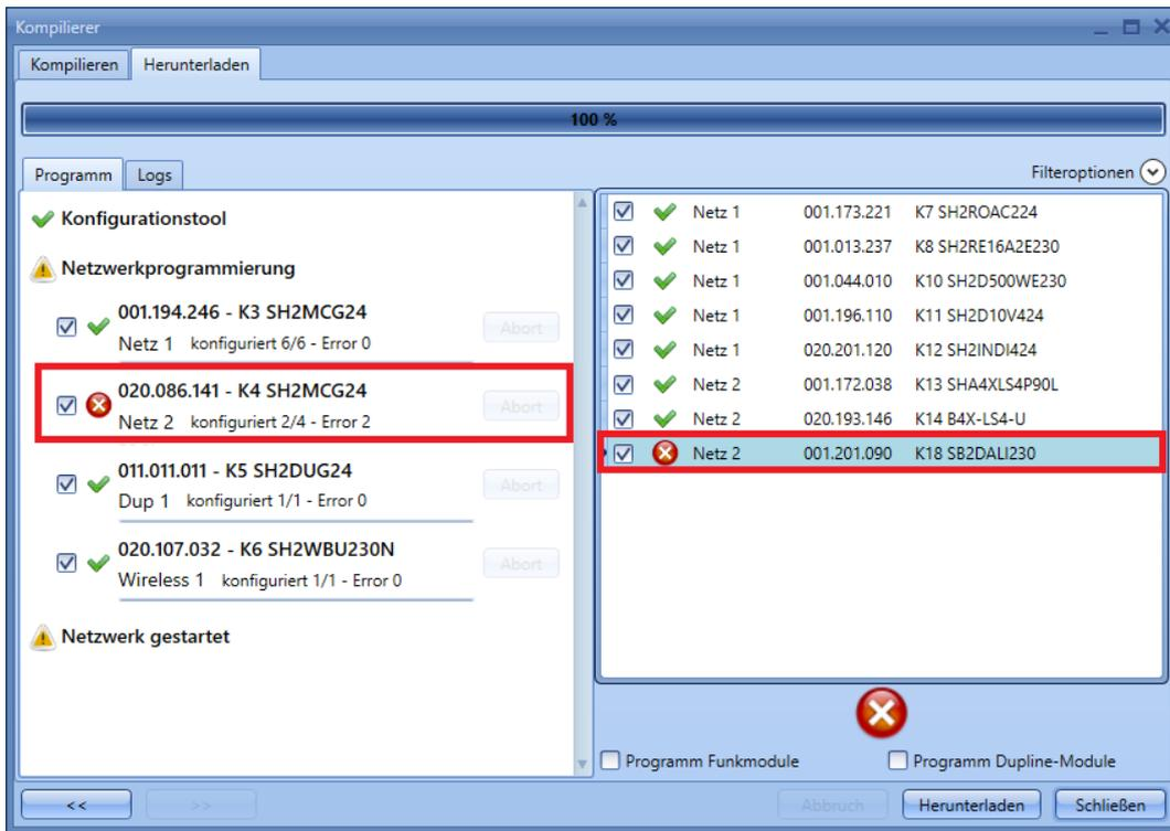
Die Funktion zum selektiven Download erkennt automatisch, welche Module nicht programmiert wurden, sodass diese Module bei der nächsten Ausführung der Funktion „Projekt kompilieren“ automatisch ausgewählt werden. Wie in der Abbildung unten dargestellt, ist das fehlerhafte Modul K3 zur erneuten Programmierung bereit.
