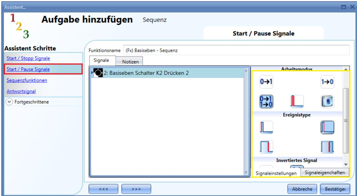
Ob das Eingangssignal die Sequenz startet oder anhält, hängt vom Betriebsmodus des Signals ab. Bei einem Startsignal wird die Sequenz dort fortgesetzt, wo sie angehalten wurde.
