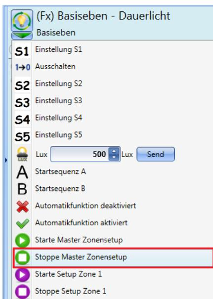
Wenn Sie das Luxmeter anschließend in Zone 1 bringen, können Sie anhand der Live-Signale die Einrichtung von *Zone 1* vornehmen, indem Sie auf „Start zone 1 setup“ klicken, wie in der Abbildung unten dargestellt.
