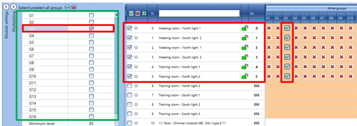
Die entsprechenden Zeilen werden in orange hervorgehoben. Durch Klicken der Taste *Write groups* werden die Gruppenzuweisungen zu den DALI-Vorschaltgeräten übertragen.
