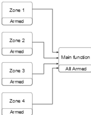
Nach Aktivierung aller Zonen führt eine Bewegung in Zone 3 dazu, dass der Status sich zunächst in „Voralarm“ ändert. Erst nach Ablauf der Deaktivierungs-Pufferzeit wechselt die Zone in der Status „Alarm“. Der Alarmstatus wird an die Hauptalarmfunktion übertragen, deren Status sich dadurch ebenfalls in „Alarm“ ändert.
