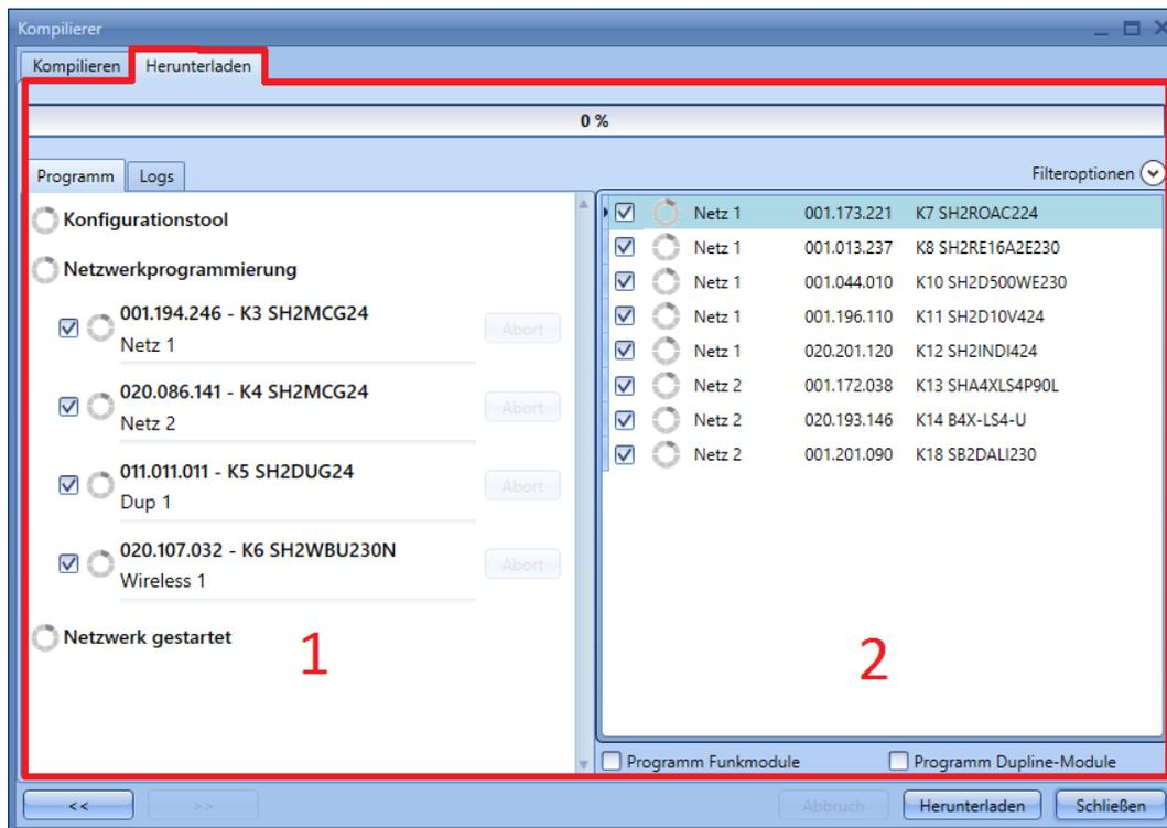
Auf der linken Seite des Fensters „Vom Controller lesen“ (**Bereich 1**) sind alle Netzwerke aufgeführt, während rechts (**Bereich 2**) alle Module angezeigt werden. Zu jedem Modul werden folgende Informationen angezeigt: das Netzwerk, mit dem es verbunden ist, die SIN und der Name.
