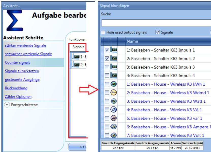
In diesem Feld können beliebige analoge Signale hinzugefügt werden. Die Zählerfunktion berechnet daraufhin die Summe. Diese Funktion kann zum Beispiel als virtuelles Energiemessgerät eingesetzt werden, das die Werte verschiedener physischer Energiemessgeräte summiert. Sie kann auch verwendet werden, um die Zählerwerte verschiedener Eingangsmodule zu addieren.
