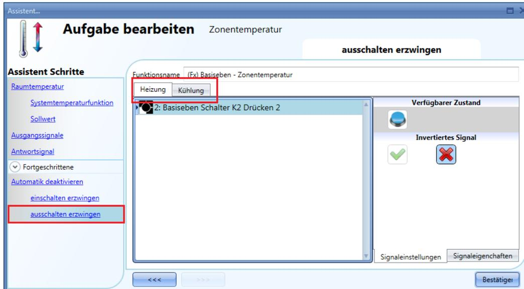
Alle Signale im Fenster „Force output off“ fungieren als Pegelsignale: Solange das Signal aktiv ist, ist der Heizungs- bzw. Kühlungsaustrag zwangsweise deaktiviert. Wenn sowohl das „Force output on“-Signal als auch das „Force output off“-Signal aktiv sind, hat das „Force output on“-Signal Vorrang.
