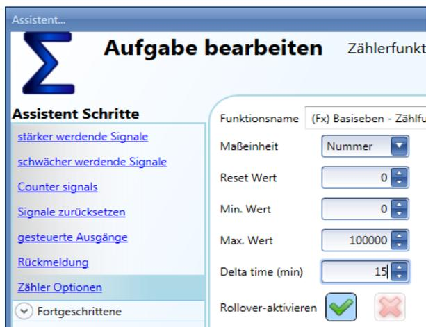
In diesem Fenster müssen Sie unter „Reset value“ den Startwert des Zählers beim Einschalten und unter „Min value“ und „Max value“ den Minimal- und den Maximalwert des Zählers festlegen, der nicht unterschritten bzw. überschritten werden darf. Außerdem müssen Sie unter „Delta time“ den Zeitraum festlegen, der als Intervalldauer für die Berechnung der Erhöhung des Zählerbetrags genutzt wird.
