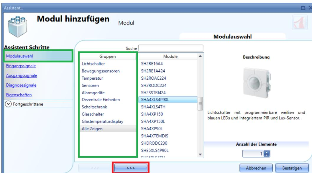
Alle Module werden dem Projekt mit der SIN 000.000.000 hinzugefügt. Der Installateur kann die korrekte SIN dann manuell eintragen (grüner Rahmen). Die SIN findet sich auf dem Modul, auf der Verpackung sowie auf dem mitgelieferten Etikett, das Sie ins Handbuch oder an den Montageort des Moduls kleben können.
