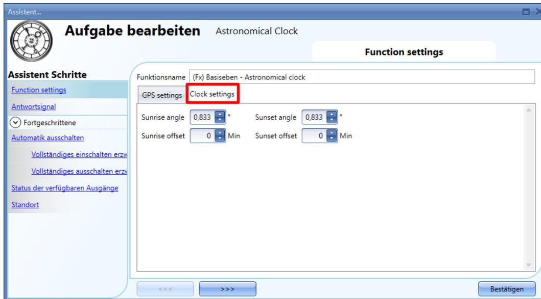
Zur Berechnung von Sonnenaufgang und Sonnenuntergang kann der Benutzer auf der Registerkarte *Uhreinstellungen* den Winkel der Sonne unter dem Horizont angeben. Der Standardwert beträgt 0,833 Grad sowohl für den *Sonnenaufgangswinkel* als auch für den *Sonnenuntergangswinkel*. Diese Werte können vom Benutzer geändert werden. Dabei ist Folgendes zu berücksichtigen:
