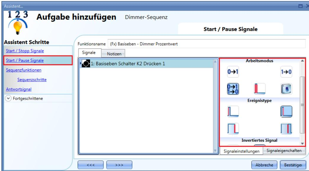
Ob das Eingangssignal die Sequenz startet und/oder anhält, hängt vom Betriebsmodus des Signals ab. Nach einer Pause bewirkt ein Startsignal, dass die Sequenz dort fortgesetzt wird, wo sie angehalten wurde.
