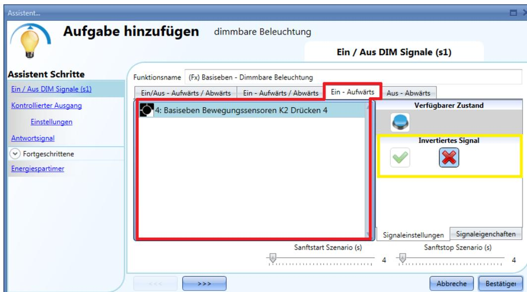
Registerkarte 4: „AUS-ABWÄRTS“ Eine kurze Betätigung (unter 1 Sekunde) schaltet die Beleuchtung aus. Wenn die Beleuchtung eingeschaltet ist, löst eine Betätigung von mehr als 1 Sekunde ein Abwärtsdimmen aus, bis das Minimum erreicht ist. Auf der Registerkarte „Signaleinstellungen“ können Sie jedes hinzugefügte Signal auch invertieren (gelber Rahmen).
