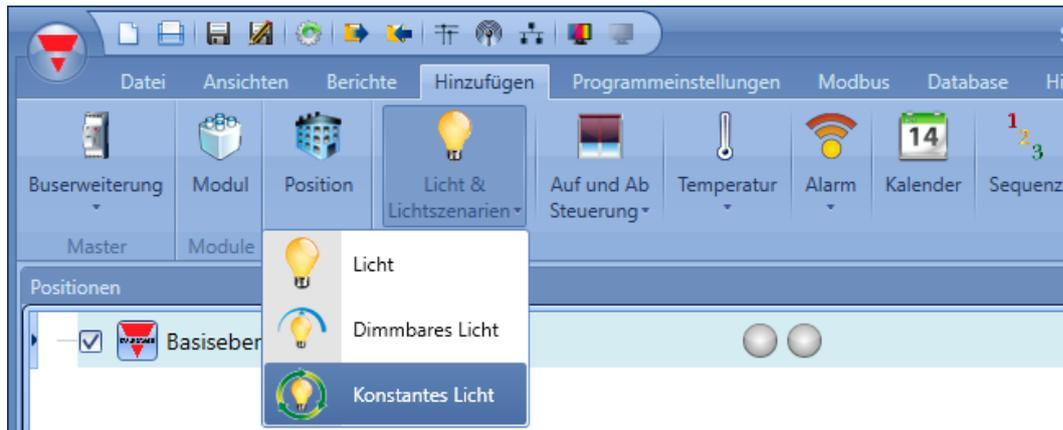
Diese Funktion steuert einen oder mehrere Dimmerausgänge anhand eines oder mehrerer Eingangsbefehle. Der Eingangsbefehl kann ein reales Signal (z. B. ein Taster), eine Funktion oder ein Remote-Befehl (Webserver, E-Mail, SMS oder Modbus) sein.
