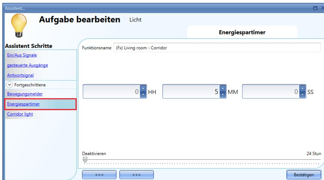
Im unten abgebildeten Beispiel ist im Flur ein PIR vorhanden: wenn dieser eine Bewegung erkennt, wird das Flurlicht eingeschaltet und bleibt aktiviert, solange der PIR im Flur eine Bewegung erkennt.
