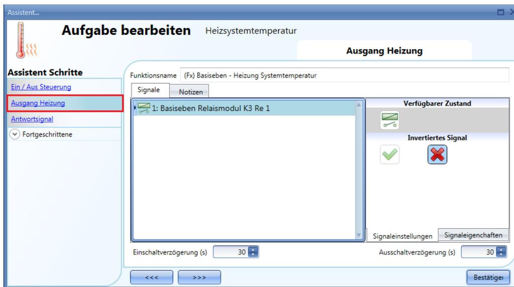
Legen Sie anschließend in den Feldern „Delay On“ und „Delay Off“ fest, mit welcher Verzögerung Systemausgang (Pumpe) und Zonenausgang (Ventil) aktiviert bzw. deaktiviert werden sollen, wenn eine Heizungs-/Kühlungsanforderung aus einer Zone eingeht.
