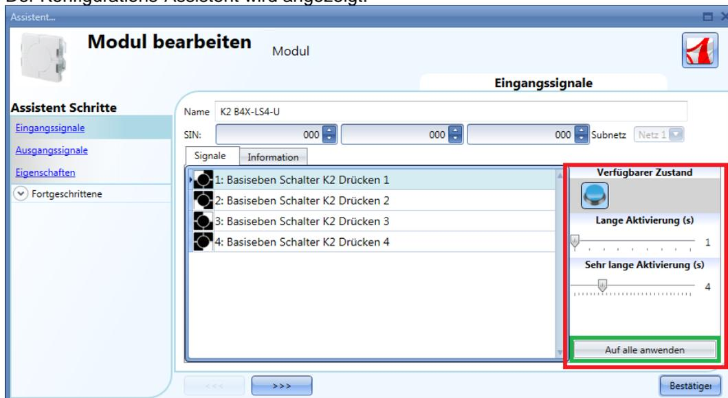
Im Fenster „Eingangssignale“ müssen die Zeiten für die „Lange Aktivierung“ und die sehr lange Betätigung „Very Sehr lange Aktivierung“ definiert werden.
