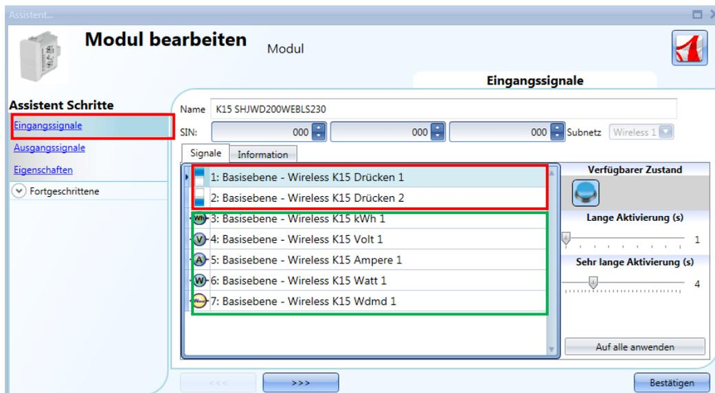
Das Modul SHJWD200WExLS230 ist mit zwei programmierbaren kapazitiven Drucktastern ausgestattet und kann für alle Funktionen des Sx-Tools verwendet werden, wie in der Abbildung oben im roten Rahmen dargestellt.
