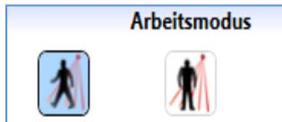
Bei Bewegung wird das Licht eingeschaltet, sofern die Option „PIR einschalen, erlauben“ aktiviert ist. Bei Anwesenheit wird der Energiespar-Timer **nicht** neu gestartet.
