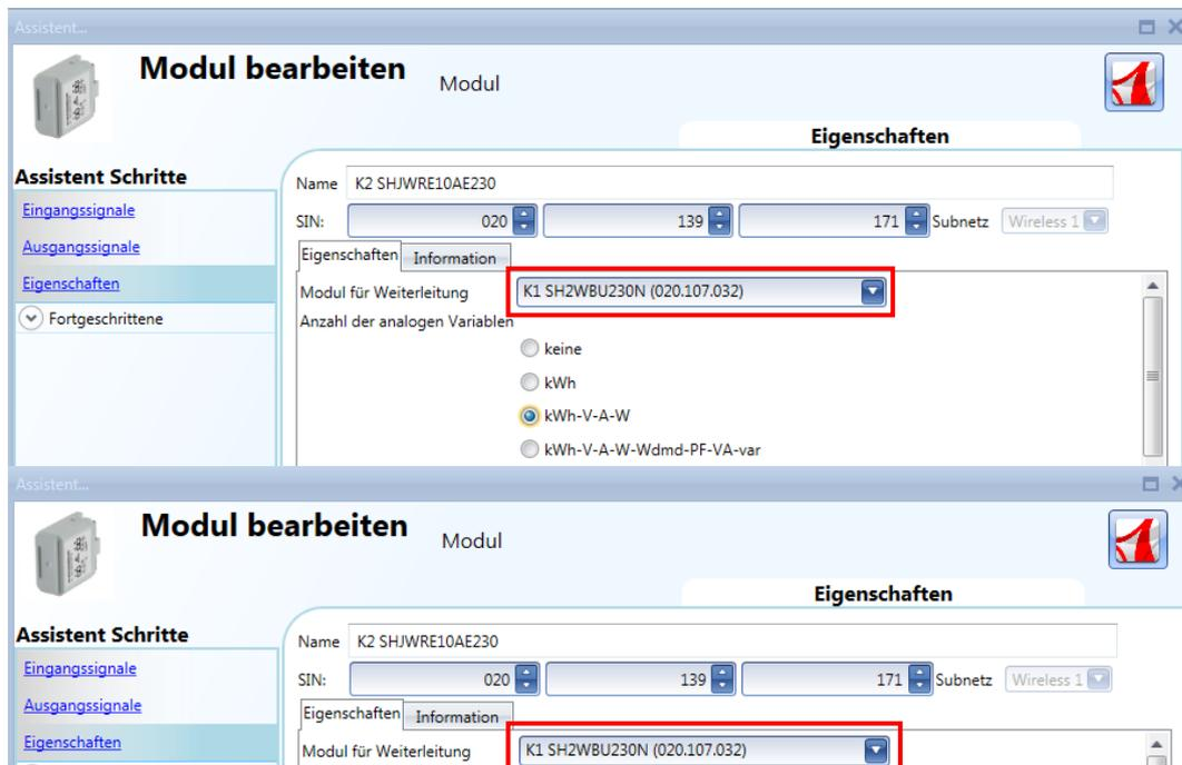
Die Abbildung unten zeigt ebenfalls das obige Beispiel mit zwei Modulen, die direkt mit dem drahtlosen Grundmodul SH2WBU230x verbunden sind.
