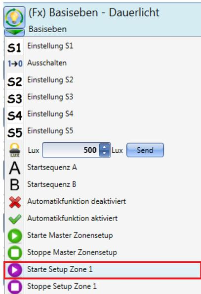
In der Funktionsleiste der Funktion wird ein kleines violettes Symbol angezeigt, wie in der Abbildung unten im roten Rahmen dargestellt.
