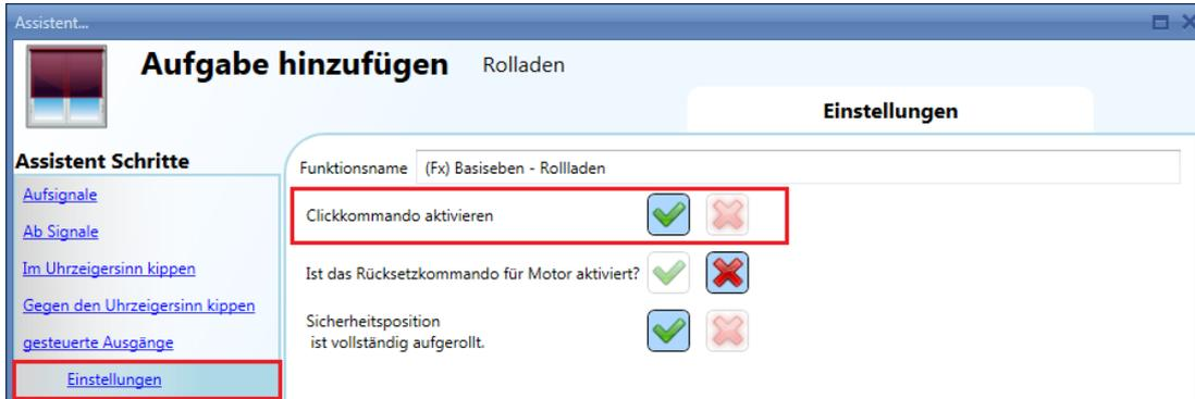
2) Eine lange Betätigung (>0,5 s) aktiviert den Motorausgang, solange das Eingangssignal aktiv ist, d. h. die Jalousie bewegt sich im/gegen den Uhrzeigersinn, solange der Benutzer den Taster gedrückt hält. Diese Funktionalität muss nicht aktiviert werden.
