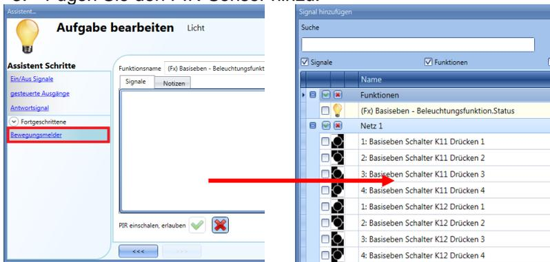
4. Ermöglichen Sie dem PIR-Sensor, das Licht einzuschalten.
