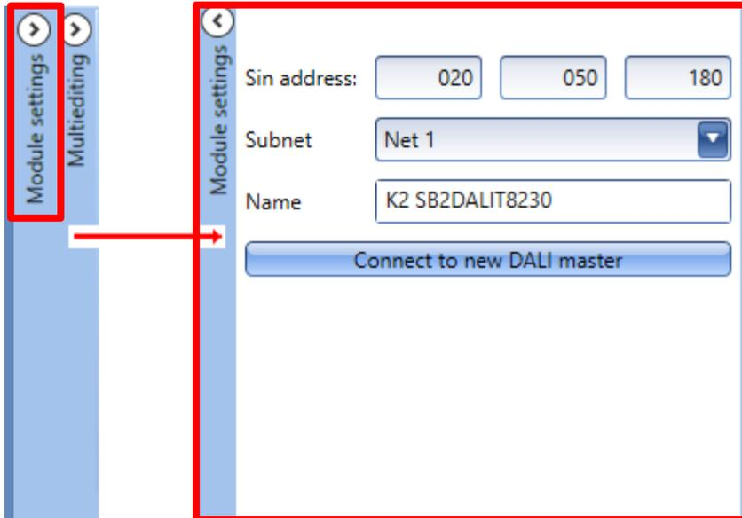
In den Feldern *SIN Adresse* kann der Benutzer die SIN Adresse des neuen SB2DALIT8230 eintragen, und dann im *Subnetz*-Feld das Dupline-Netzwerk einsetzen, an dem das Modul angeschlossen ist. Klicken auf die Taste *Connect to new DALI master* wird das Modul in das laufende Projekt eingefügt. Der Benutzer kann das eingefügte Modul unter den verfügbaren DALI-Masters finden.
