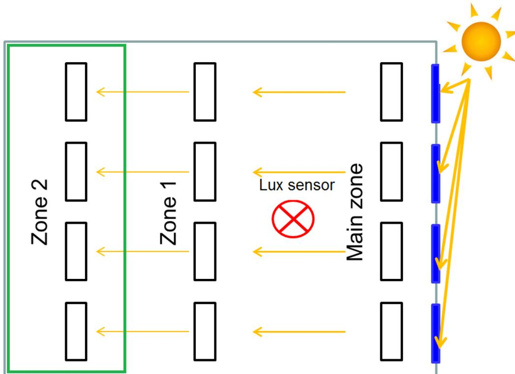
In der Haupt-Konstantlichtfunktion müssen Sie im Bereich „Advanced“ untergeordnete Zonen („Slave zones“) hinzufügen und dann in der Liste die Dimmermodule für *Zone 2* auswählen. Anschließend können Sie durch einen Doppelklick im Feld „Signals“ einen oder mehrere Ausgänge hinzufügen, welche die Gruppe „Zone 2“ bilden sollen. Siehe Abbildung unten:
