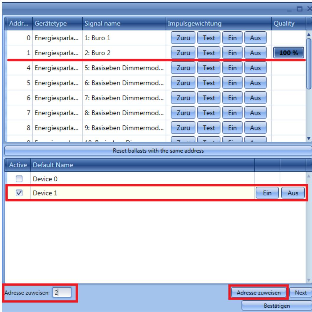
Das Vorschaltgerät, das bisher im unteren Bereich des Fensters angezeigt wurde (Device 1), wird nun wie in der folgenden Abbildung dargestellt mit der neu zugewiesenen Adresse auch im oberen Bereich des Fensters angezeigt (2 Fluorescent lamp).
