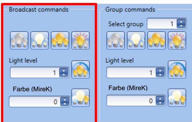
Durch Ausführen von Broadcast-Befehlen kann bestimmt werden, ob die Kommunikation im DALI-Kreis ordnungsgemäß funktioniert und ob alle Geräte im DALI-Kreis verbunden sind.
