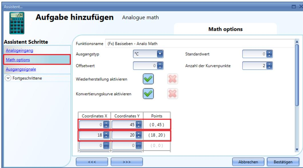
Wenn der Wert der Außentemperatur bei 12 °C liegt, beträgt der linearisierte Wert der *mathematischen Funktion* 28,3 °C, wie im Diagramm unten dargestellt.
