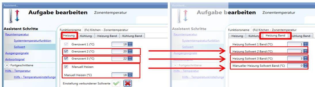
Im oben abgebildeten Beispiel liegt der Sollwert 1 bei 21 °C (22–1), die Heizung wird also bei 21 °C abgeschaltet und gemäß der eingestellten Hysterese eingeschaltet. Der Sollwert 2 liegt bei 18 °C (20–2), daher wird die Heizung bei 18 °C abgeschaltet und gemäß der eingestellten Hysterese eingeschaltet. Der Sollwert 3 liegt bei 15 °C (18–3), die Heizung wird also bei 15 °C abgeschaltet und gemäß der eingestellten Hysterese eingeschaltet.
