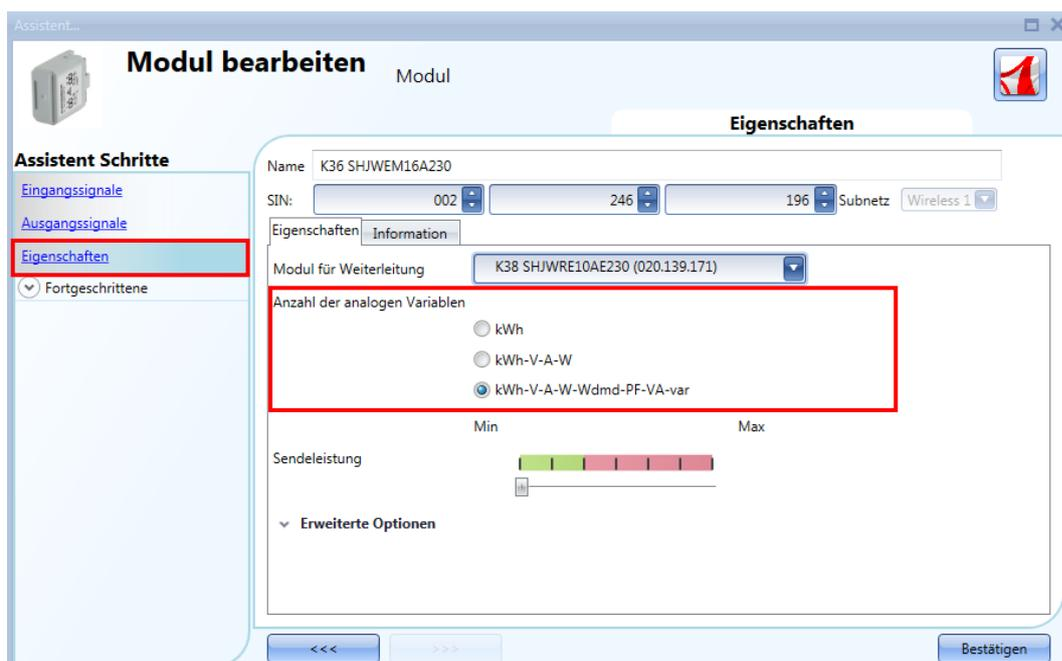
Im Feld „Tx radio power“ können Sie außerdem die Sendeleistung des Moduls einstellen, indem Sie den Schieberegler betätigen.
