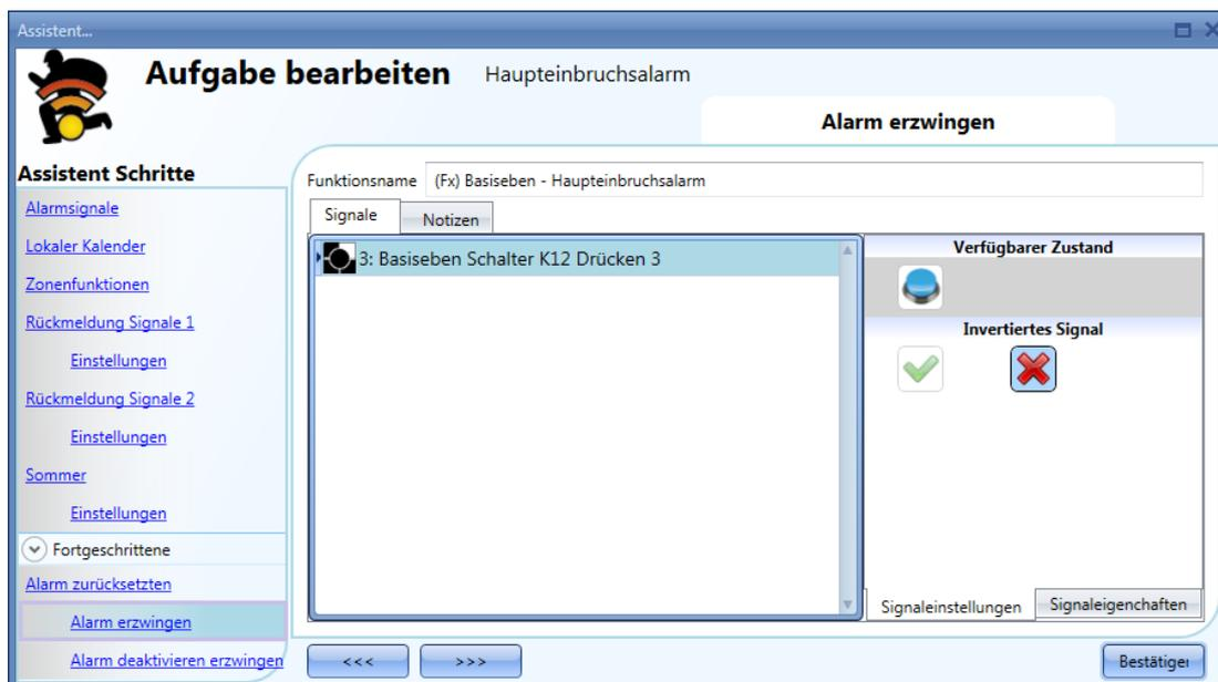
In einer Zonalarmfunktion können Sie im Bereich „Alarm erzwingen“ ein Signal auswählen, das nur für die jeweilige Zone den EIN-Zustand des Alarms erzwingt (siehe unten).
