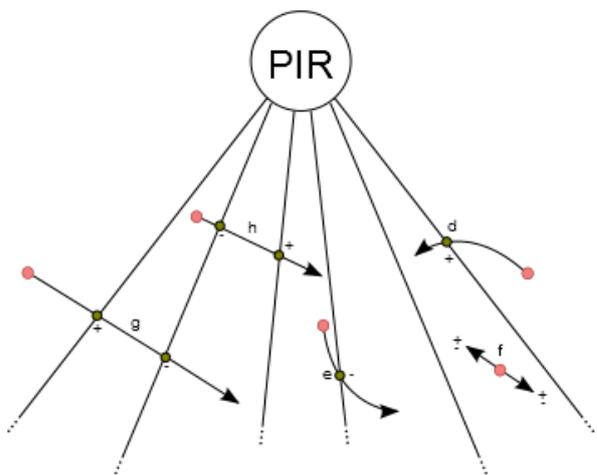
Die Intensität der vom PIR-Sensor ausgegebenen Impulse, d. h. die erfasste Temperaturänderung, wird mit einem Schwellwert verglichen.
