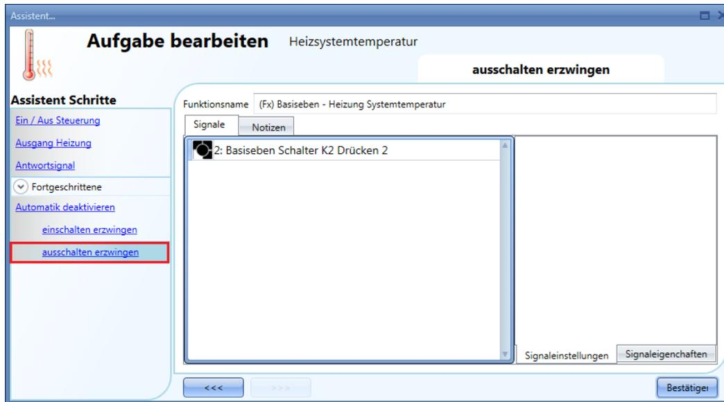
Alle Signale im Fenster „Force output off“ fungieren als Pegelsignale: Solange das Signal aktiv ist, bleibt der Ausgang ausgeschaltet. Wenn sowohl das „Force output on“-Signal als auch das „Force output off“-Signal aktiv sind, hat das „Force output on“-Signal Vorrang.
