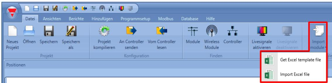
Der Benutzer definiert die Module und Signale in einer Vorlagendatei. Für Module und Signale können benutzerdefinierte Namen vergeben werden. Diese haben Vorrang vor den Standardnamen, die von Sx Tool vorgegeben werden. Die Liste der Module und Signale wird von einer Excel-Datei importiert, die von Sx Tool bereitgestellt wird: Bei Veröffentlichung einer neuen Softwareversion installiert Sx Tool eine neue Version der Datei, um neue Module verwalten zu können.
