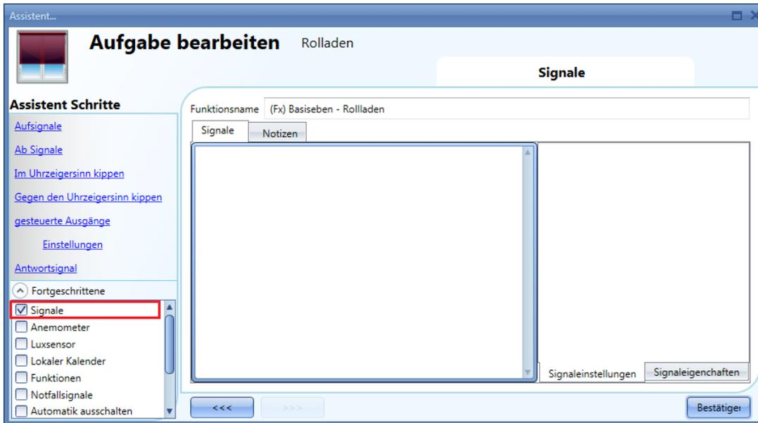
Wählen Sie dazu im Bereich „Fortgeschrittene“ die Option „Signale“, führen Sie im zugehörigen Signalfenster einen Doppelklick aus, und wählen Sie aus der Liste das gewünschte Eingangssignal (Taster) aus.
