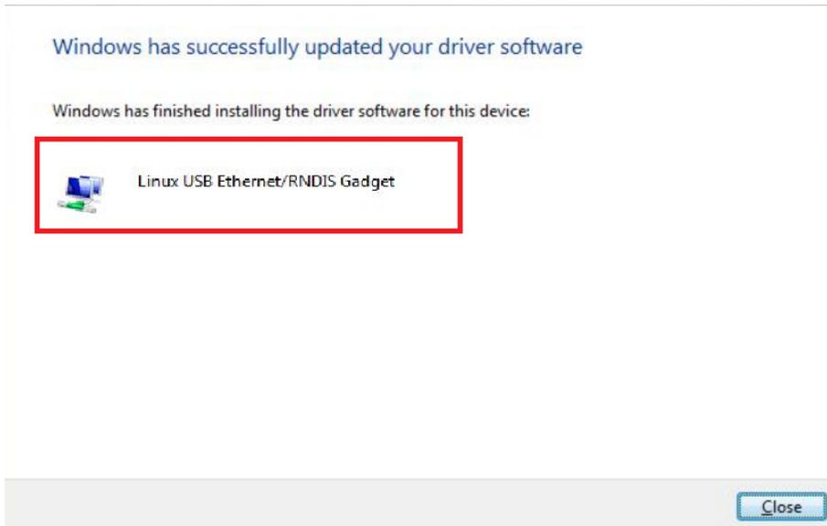
8. Nachdem der Treiber installiert wurde, wird wie in der Abbildung unten dargestellt in der Kategorie Netzwerkadapter eine virtuelle Netzwerkkarte mit der Bezeichnung *Linux USB Ethernet/RNDIS Gadget* hinzugefügt. Der Treiber teilt dem Controller/Computer basierend auf der aktuellen IP-Adresse des Computers automatisch eine dynamische IP-Adresse zu.
