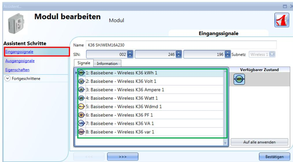
Das drahtlose Energiemessgerät besitzt keine Ausgangssignale, daher ist das Fenster „Output signals“ leer.
