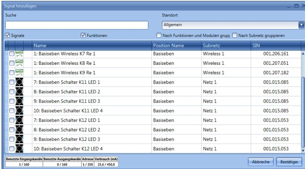
Die in diesem Fenster verfügbaren Signale sind Relais und LEDs. Es können bis zu 50 Signale ausgewählt werden, die alle parallel verarbeitet werden. Die Logik kann einzeln für jedes Ausgangssignal invertiert werden (Option „Invertiertes Signal“, gelber Rahmen).
