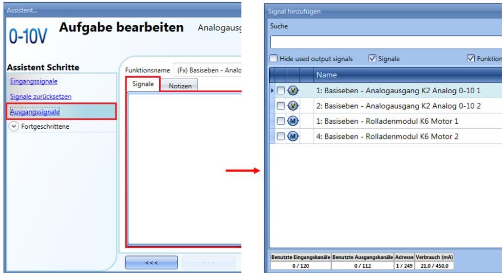
Sie können die Betriebsparameter der Rolladenmodule direkt auf der Registerkarte „Signal properties“ des Assistenten für die Beleuchtungsfunktion einstellen (d. h., Sie müssen nicht erneut den Assistenten für das Modul öffnen).
