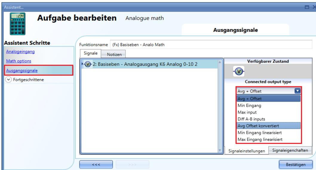
Der Ausgangswert 0–10 V wird anhand eines linearen Verhältnisses zwischen dem Minimalwert und dem Maximalwert der Funktion berechnet: Im Fenster „Signal properties“ des Ausgangs können Sie unter „Virtual range“ einen virtuellen Bereich (0–100) und unter „Output range“ den Ausgangsbereich (0–10 V) gemäß den Anforderungen des Projekts festlegen, wie in der folgenden Abbildung dargestellt:
