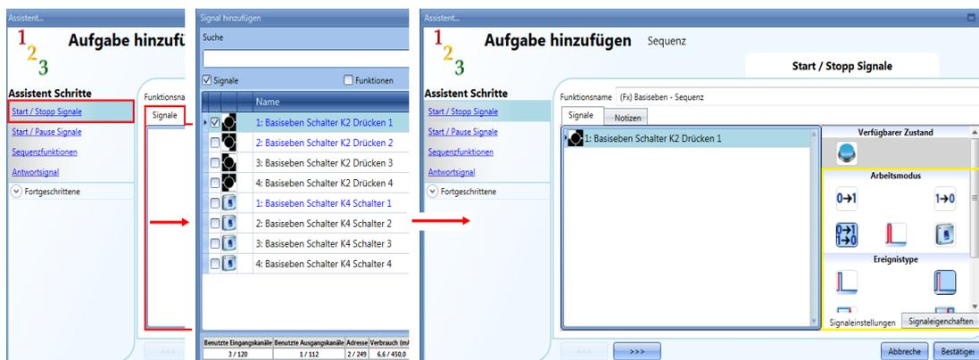
Ob das Eingangssignal die Sequenz startet oder stoppt, hängt vom Betriebsmodus des Signals ab. Ein Startsignal führt immer zum kompletten Neustart der Sequenz.
