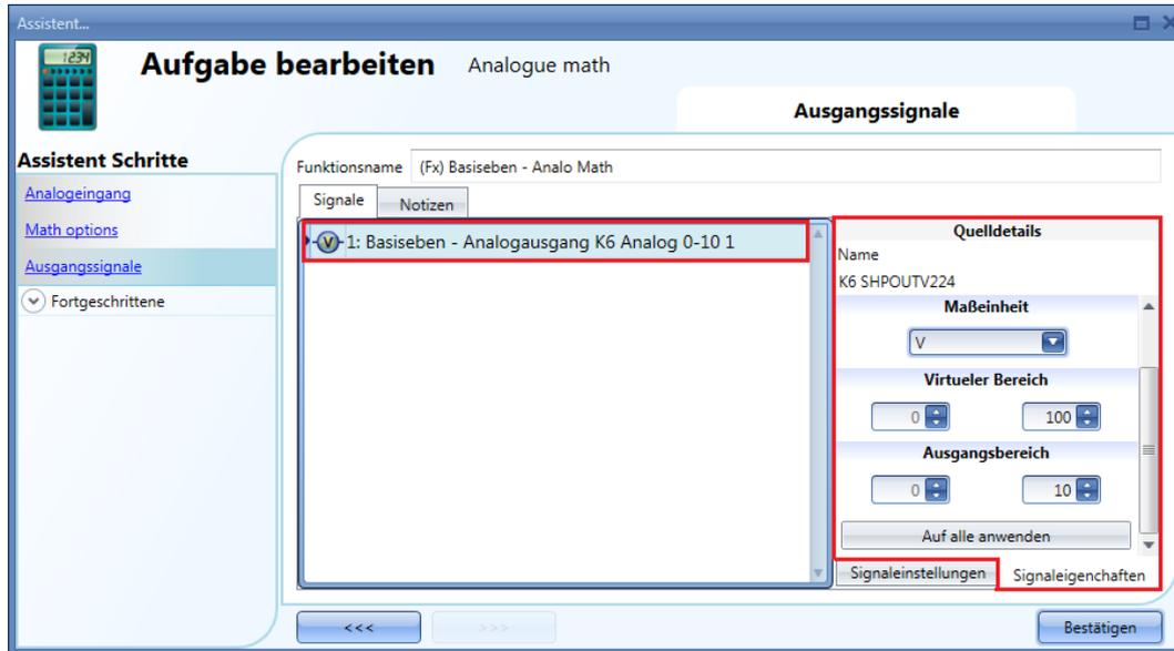
Wenn der virtuelle Minimalwert der Funktion 0 und der Maximalwert 100 beträgt, liefert das SHPOUTV224 bei einem virtuellen Ausgangswert von 30 eine Ausgangsspannung von 3 V. Im unten abgebildeten Beispiel liegen die linearisierten Ausgangswerte zwischen 20 °C (Minimalwert) und 45 °C (Maximalwert). Dementsprechend liegt die Ausgangsspannung zwischen 2,0 V (Minimalwert) und 4,5 V (Maximalwert).
