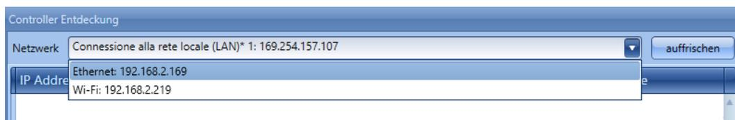
Beim Klicken auf das rot markierte Symbol beginnt das Sx-Tool mit der Suche nach Controllern. Werden ein oder mehrere Controller gefunden, öffnet sich ein Dialogfeld, und Sie können auswählen, zu welchem Controller eine Verbindung hergestellt werden soll.
