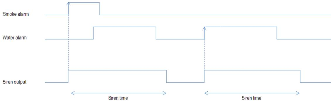
Wenn je nach Alarm eine unterschiedlich konfigurierte Sirene ausgelöst werden soll, müssen Sie verschiedene Sirenenfunktionen verwenden und diese mit einer Multigate-Funktion verknüpfen.
