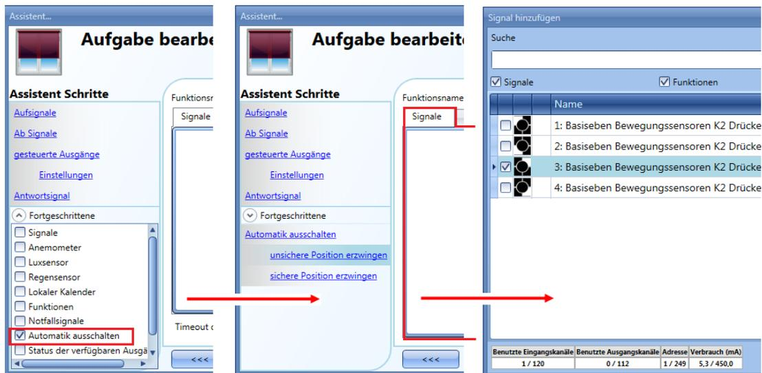
Alle Signale im Fenster „unsichere Position erzwingen“ fungieren als Pegelsignale: Solange das Signal aktiv ist, befindet sich der Rollladen zwangsweise nicht in der Sicherheitsposition. Wenn sowohl das „sichere Position erzwingen“-Signal als auch das „unsichere Position erzwingen“-Signal aktiv sind, hat das „sichere Position erzwingen“-Signal Vorrang.
