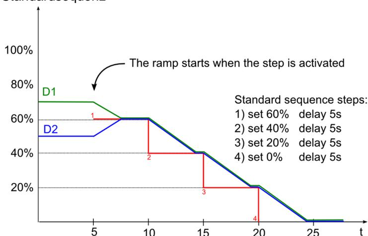
Die folgende Abbildung zeigt das Verhalten einer Dimmsequenz. Die Parameter für die Schritte sind dieselben wie bei der Standardsequenz.
