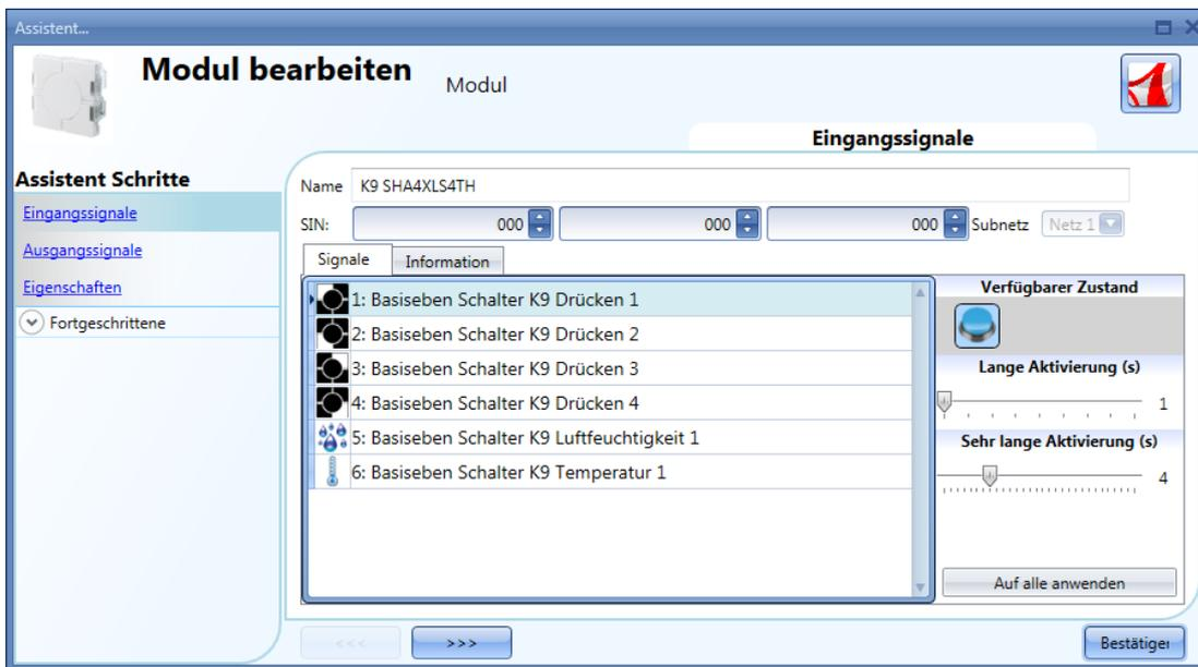
Die Module SHA4XLS4TH und SHE5XLS4TH sind Lichtschalter mit integriertem Temperatursensor, d. h. sie können gemäß den Anweisungen im Abschnitt „Lichtschalter“ konfiguriert werden.
