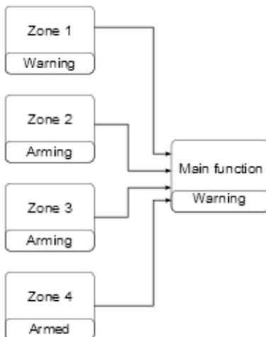
Nach Ablauf der Pufferzeiten befinden sich alle Zonen im Zustand „Aktiviert“, und der Status der Hauptalarmfunktion lautet entsprechend „Aktiviert in allen Zonen“.
