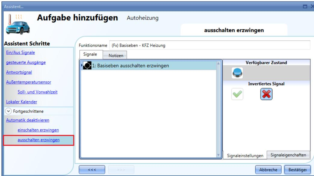
Alle Signale im Fenster „Force output off“ fungieren als Pegelsignale: Solange das Signal aktiv ist, ist die Autoheizungsfunktion ausgeschaltet.
