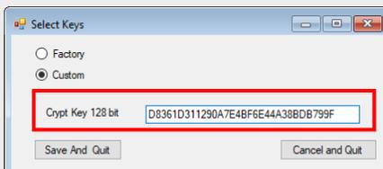
Klicken Sie auf die Taste **Save and Quit**: Die AES-128-End-to-End-Kommunikation zwischen den Sensoren und dem Konzentrator wird aktiviert.
