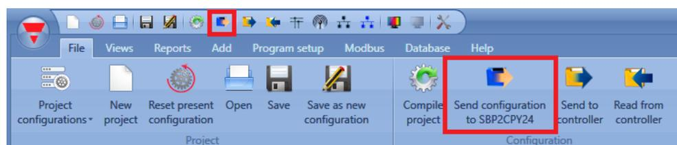
Bei jedem Klick auf das rot markierte Symbol wird die Konfiguration des Projekts zum SBP2CPY24 übertragen.
