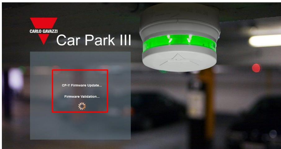
*Hinweis: Während des Firmware-Uploads zum SBP2CPY darf die Webbrowser-Sitzung nicht unterbrochen werden, indem das Fenster geschlossen oder eine andere Seite geladen wird. Durch die Unterbrechung der Browser-Sitzung kann die Firmware beschädigt werden.*
